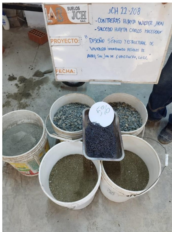
Preparación de la mezcla de concreto
