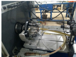
Figura 76: Prueba en banco de bomba de alta presión de combustible
