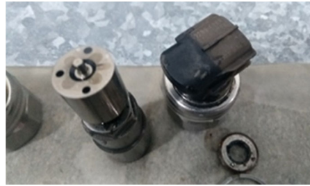
Figura 13: Desmontaje de inyectores
