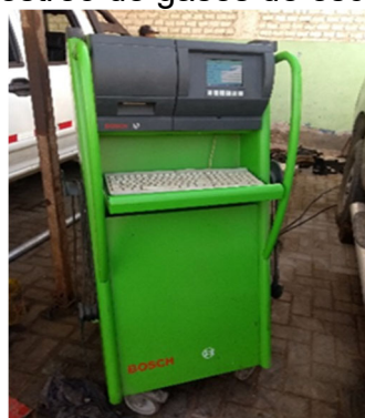
Figura 22: Equipo de muestreo de gases de escape
