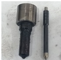
Figura 20: Tobera y válvula (aguja) usada
