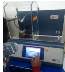
Figura 65: Prueba en banco de inyectores
