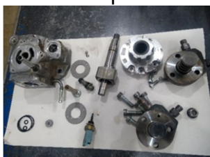
Figura 87: Desmontaje de bomba de alta presión
