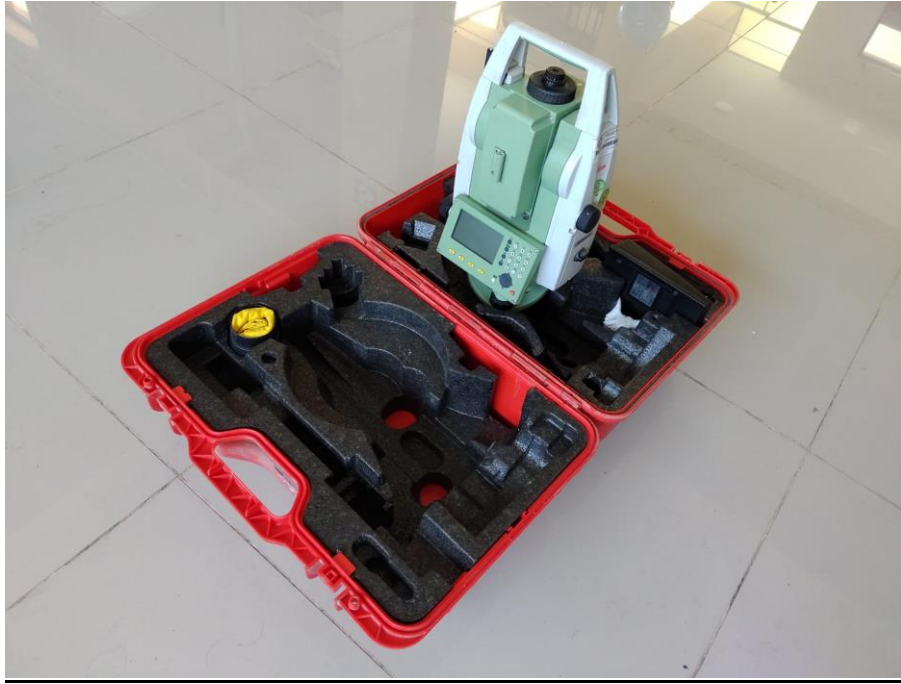
Fig. Nº 01.- FOTO DEL INSTRUMENTO DE ESTACION TOTAL CON EL CUAL SE TRABAJARÁ LA TOPOGRAFIA.
