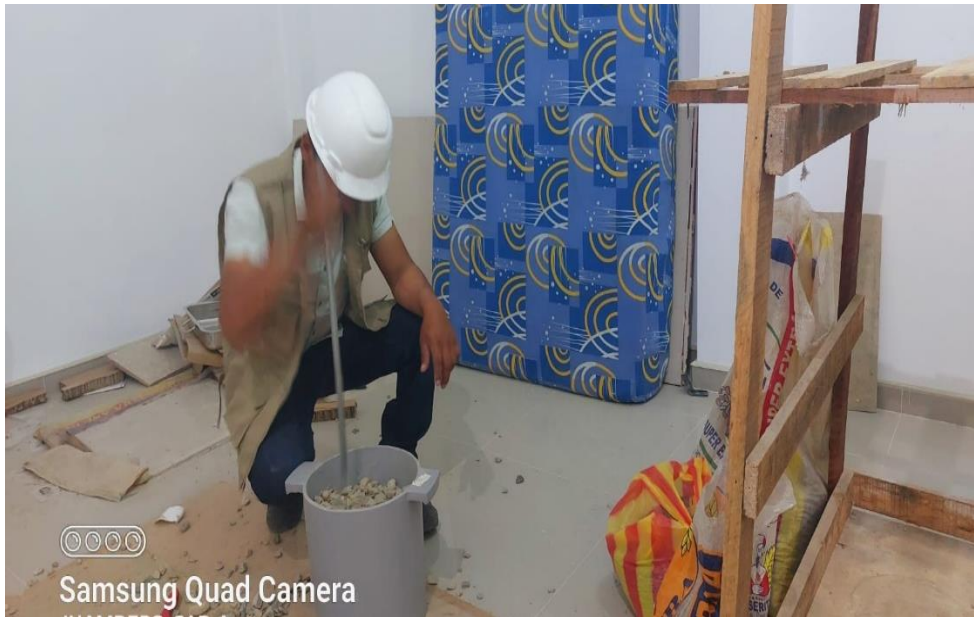
Foto 14. Cuarteo del agregado grueso
