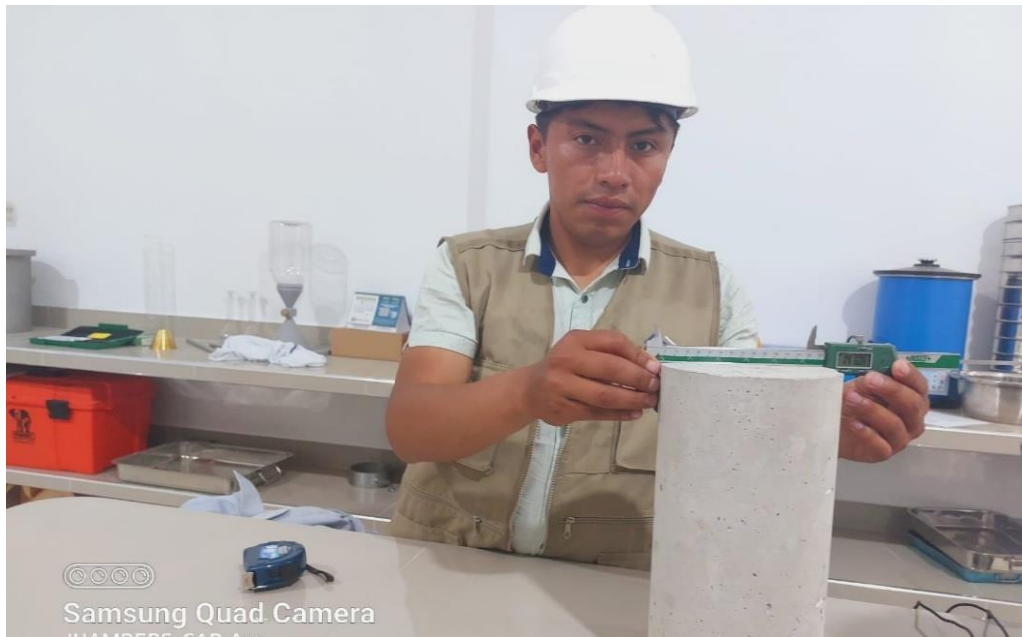
Foto 23. Dimensiones del concreto
