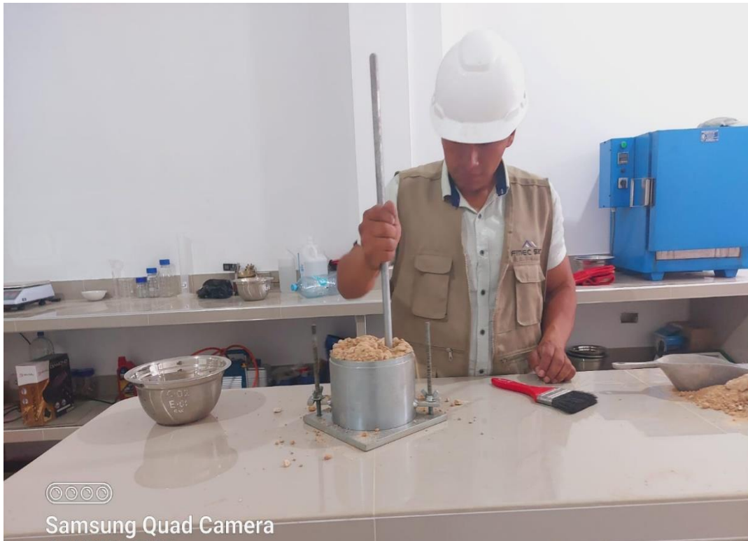
Foto 8. Varillado del peso volumétrico del agregado fino
