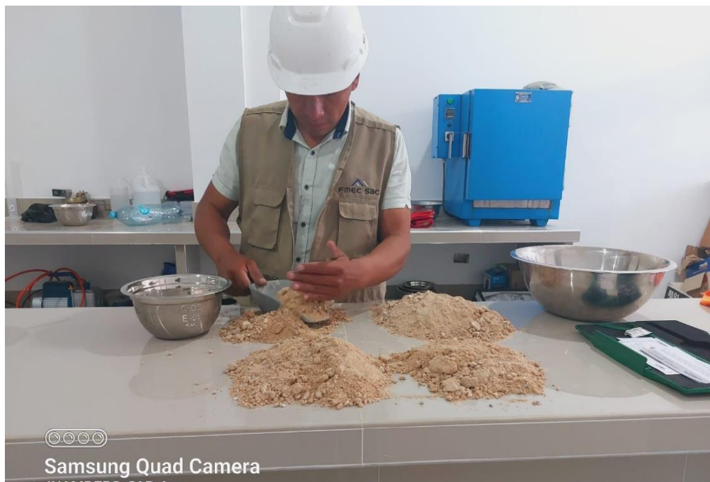
Foto 11. Cuarteo del agregado grueso
