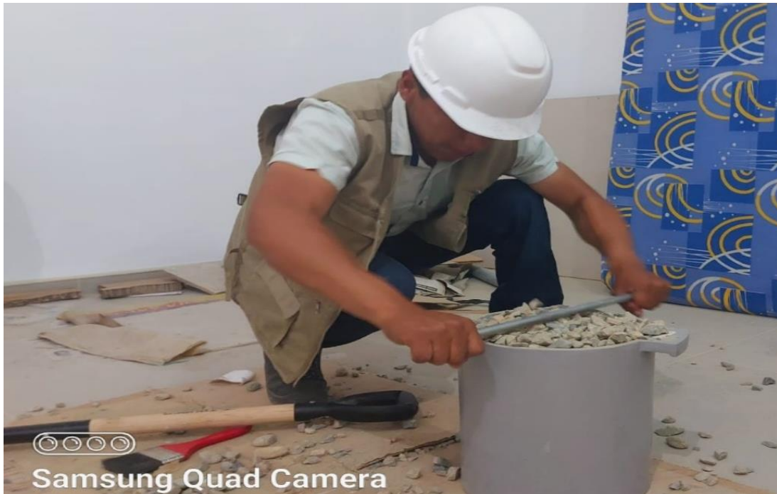
Foto 16. Enrasamiento del agregado grueso
