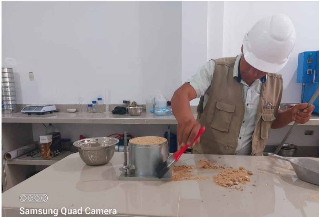
Foto 7: Limpieza de varillado de los agregados fino
