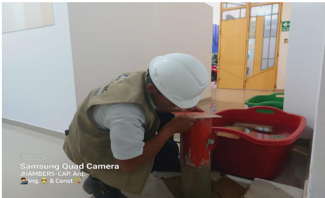
Foto 21. Probeta extraída del molde
