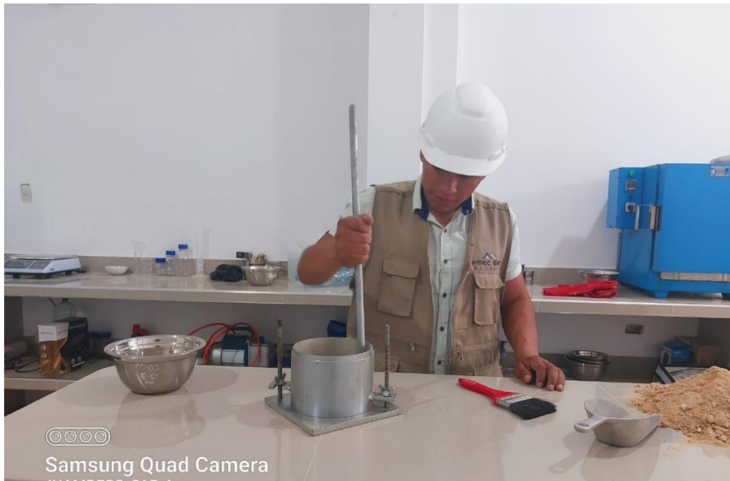
Foto 6: Varillado de los agregados fino
