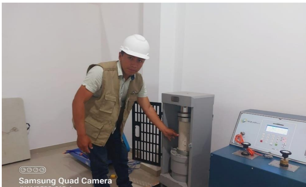
Foto 27. Ruptura de concreto 210
