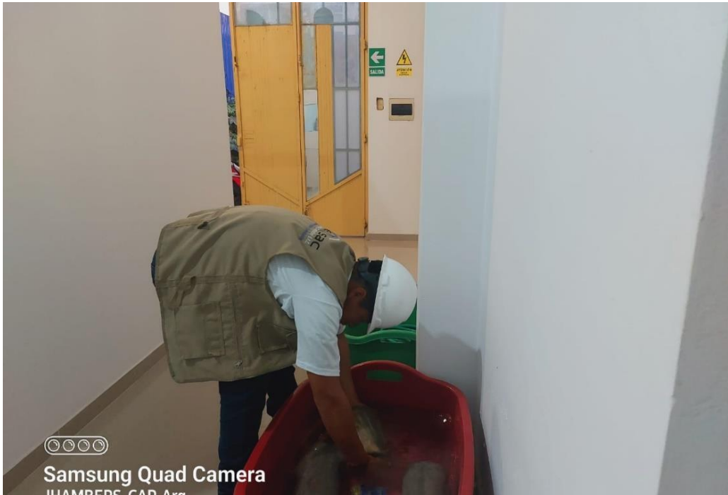
Foto 22. Curado de las probetas
