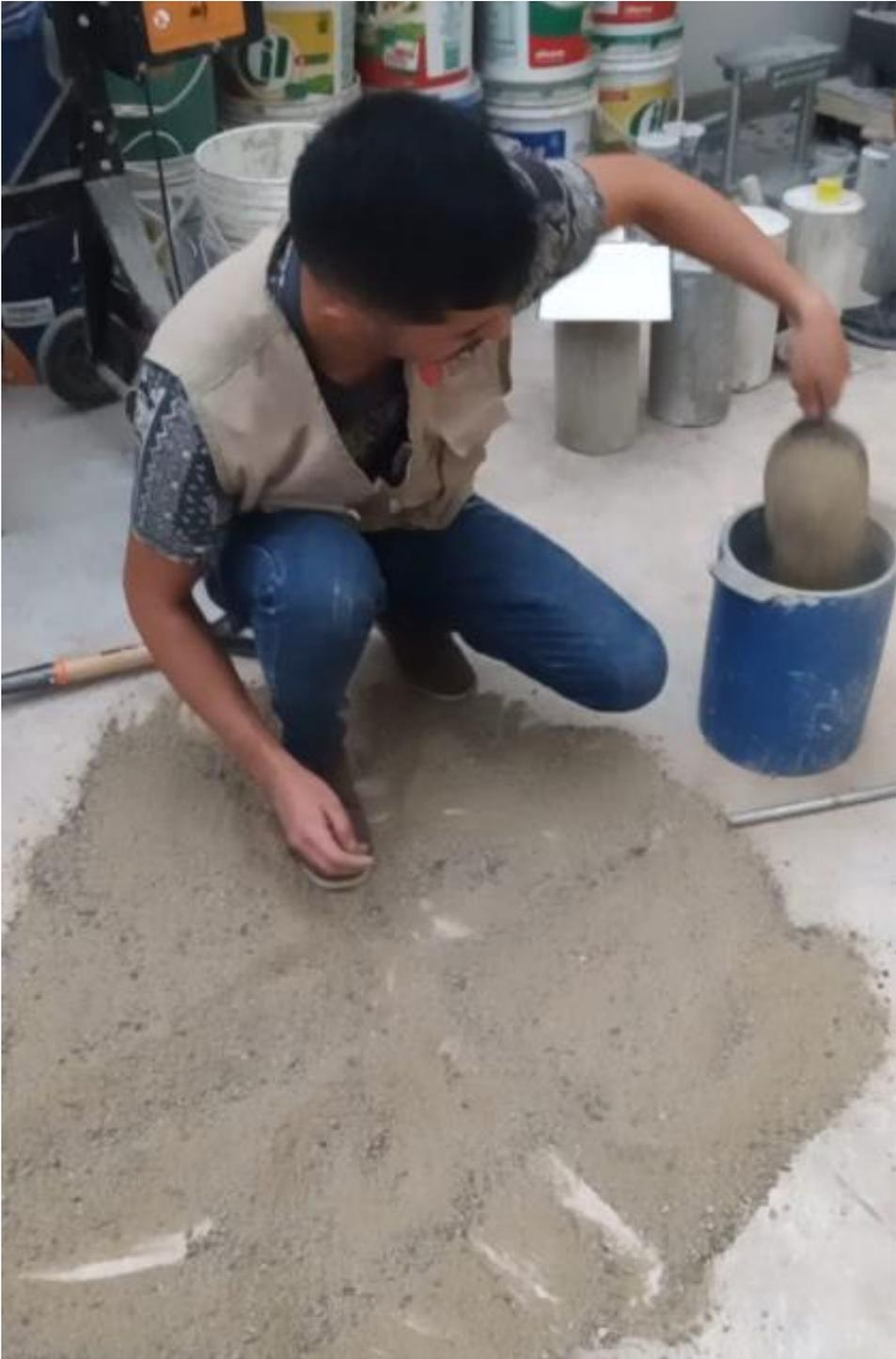
Realizando el ensayo del peso unitario compactado de la arena gruesa
