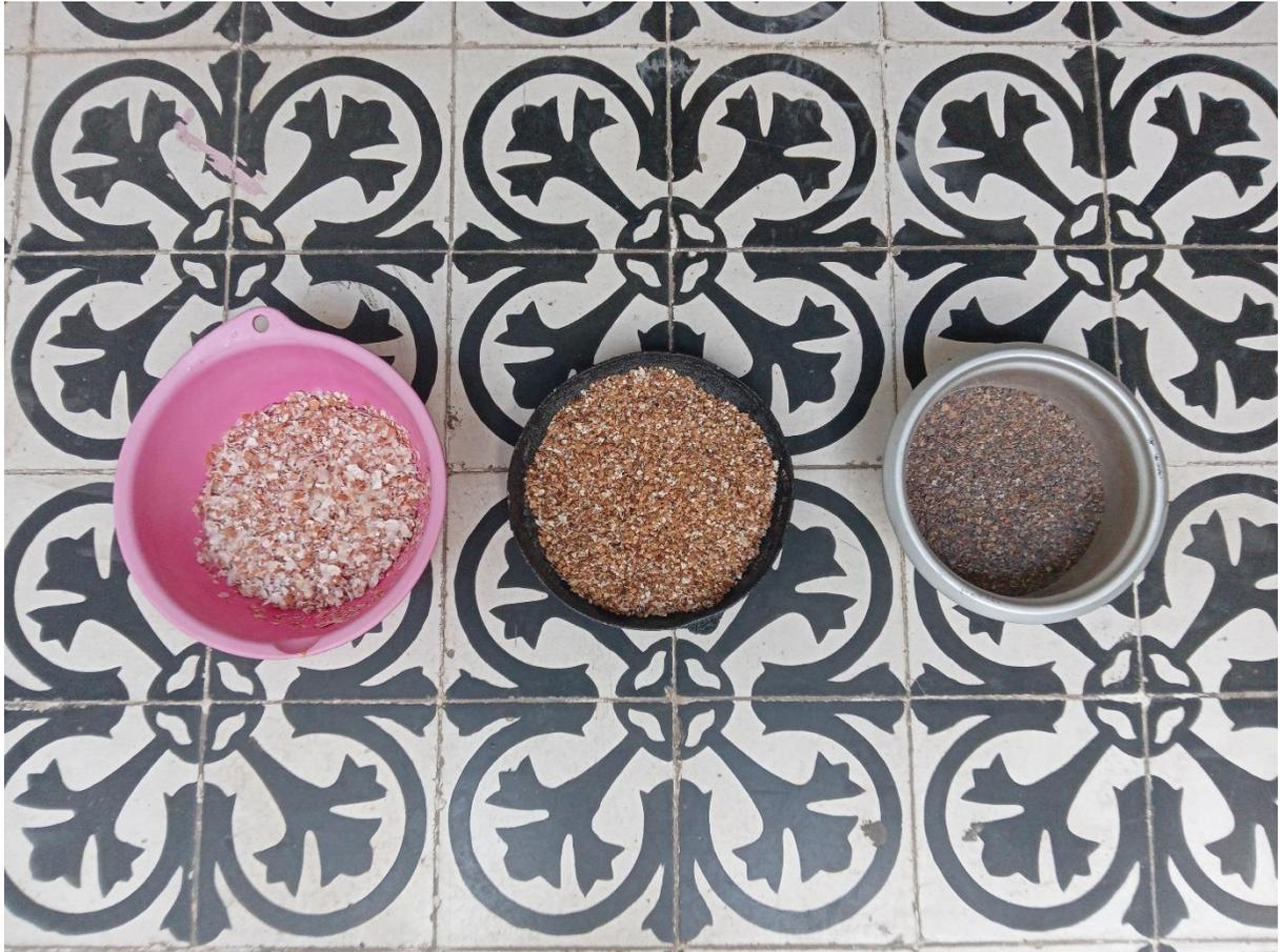
Detalle de las cascaras de huevo después del proceso de prequemado
