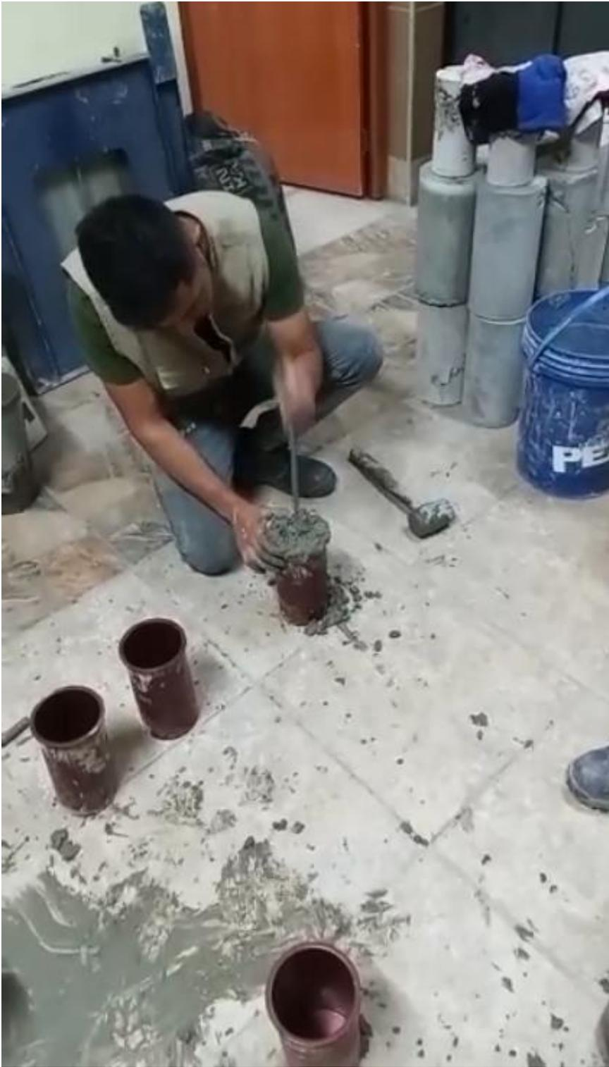
Probetas de concreto patron ya vaceadas listas para guardarse y continuar con el proceso de curado
