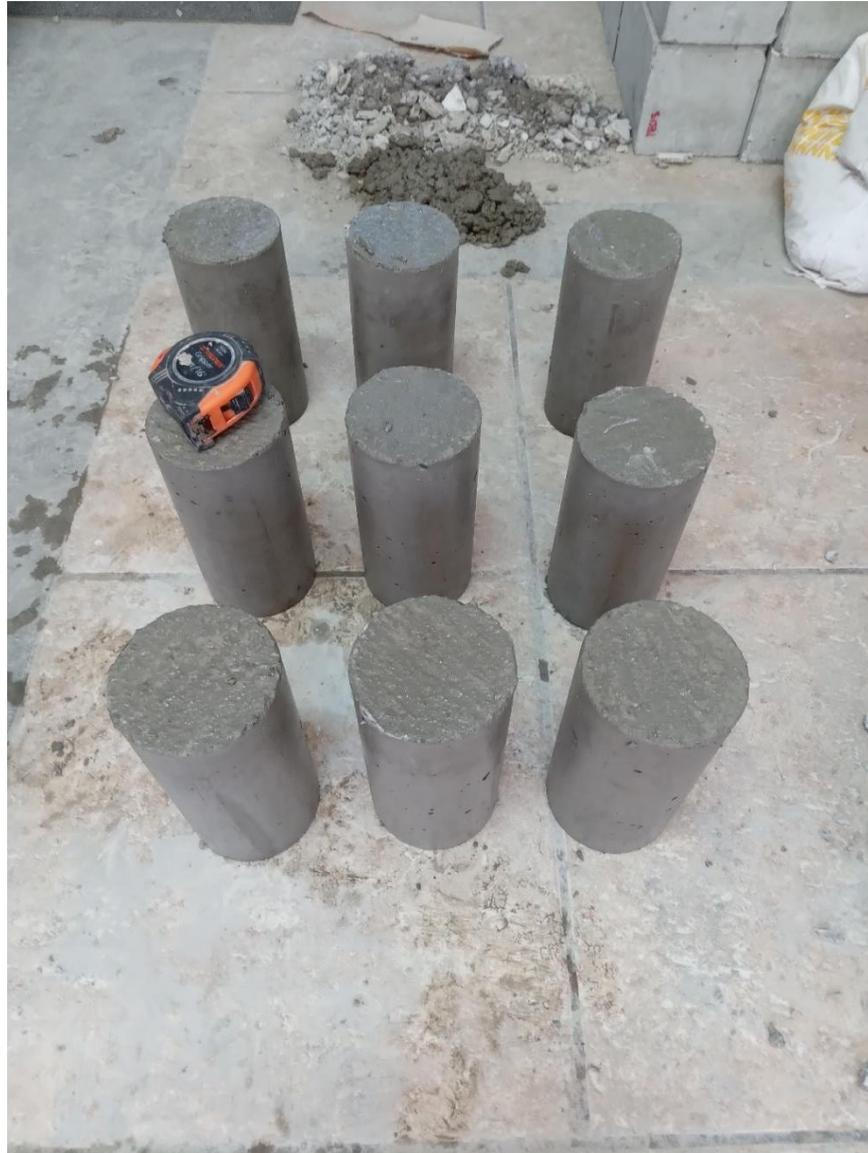
Verificando las medidas de cada probeta
