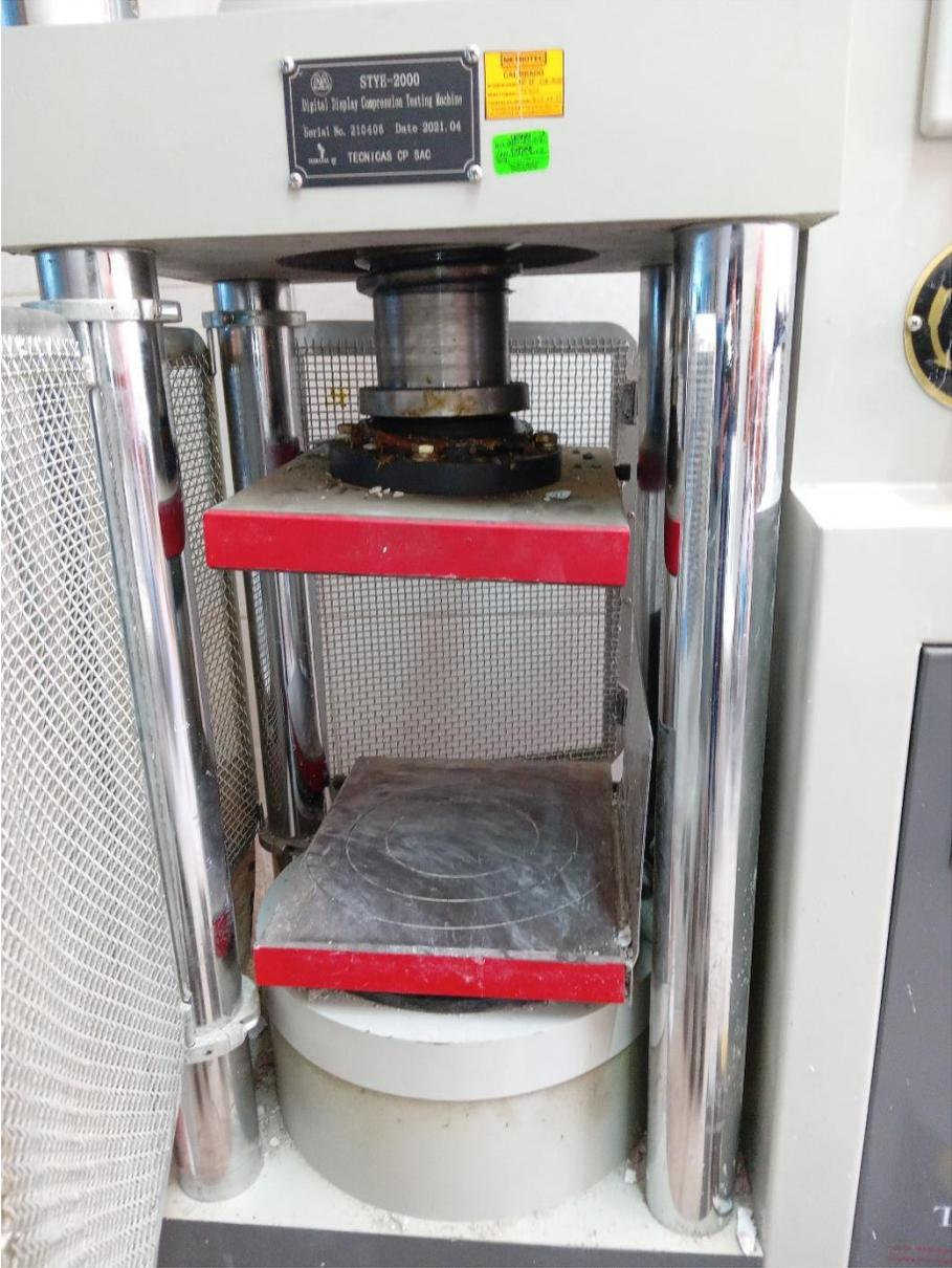
Colocando la probeta al interior de la maquina para poder realizar el ensayo de resistencia a la compresion
