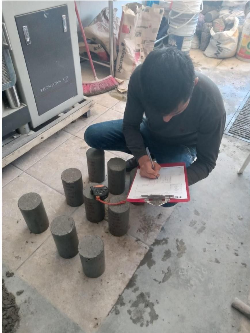
Maquina compresora para realizar el ensayo de resistencia a la compresión
