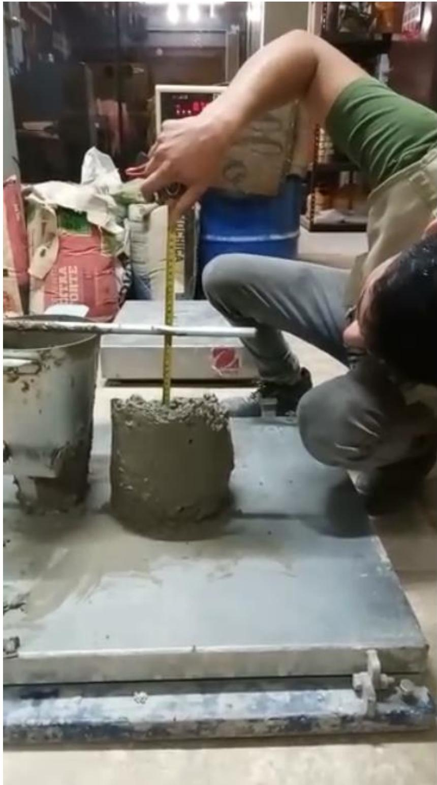
Realizando el vaciado de las probetas utilizando concreto patron
