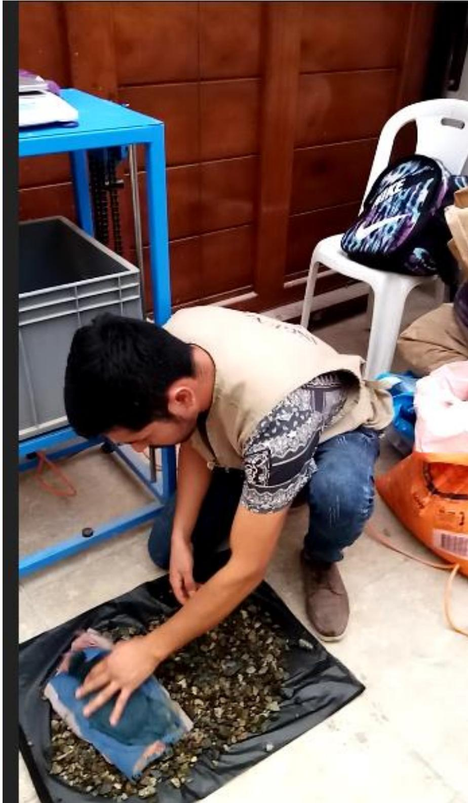
Realizando el ensayo para obtener el peso del agregado al aire
