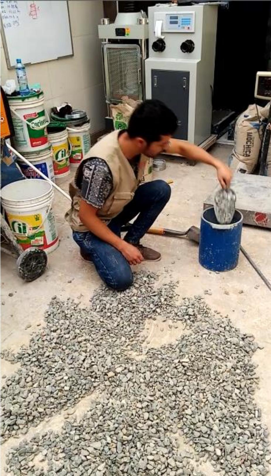
Realizando el ensayo de peso unitario compactado del agregado grueso
