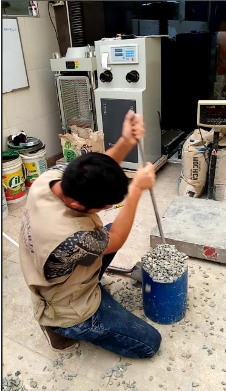
El agregado grueso se dejó reposando en agua 24 hora, para después realizar el proceso de llevado a un estado de triple S
