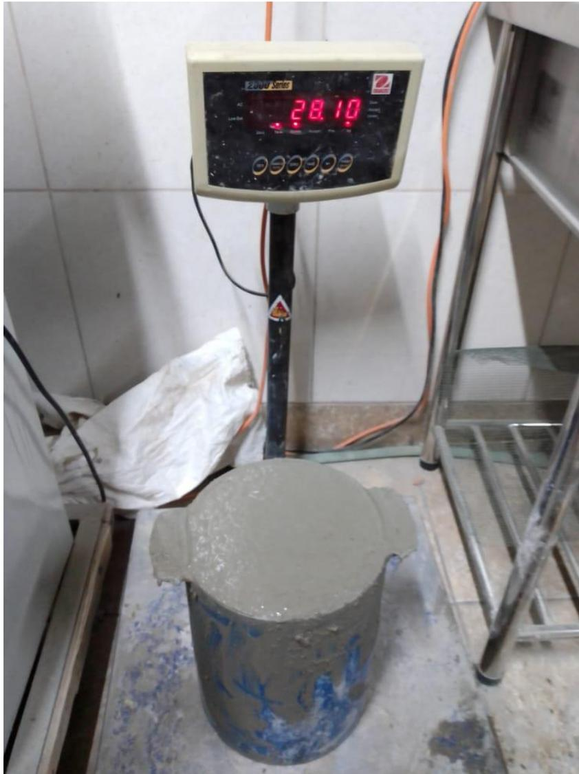
Realizando el ensayo de contenido de aire de la mezcla.
