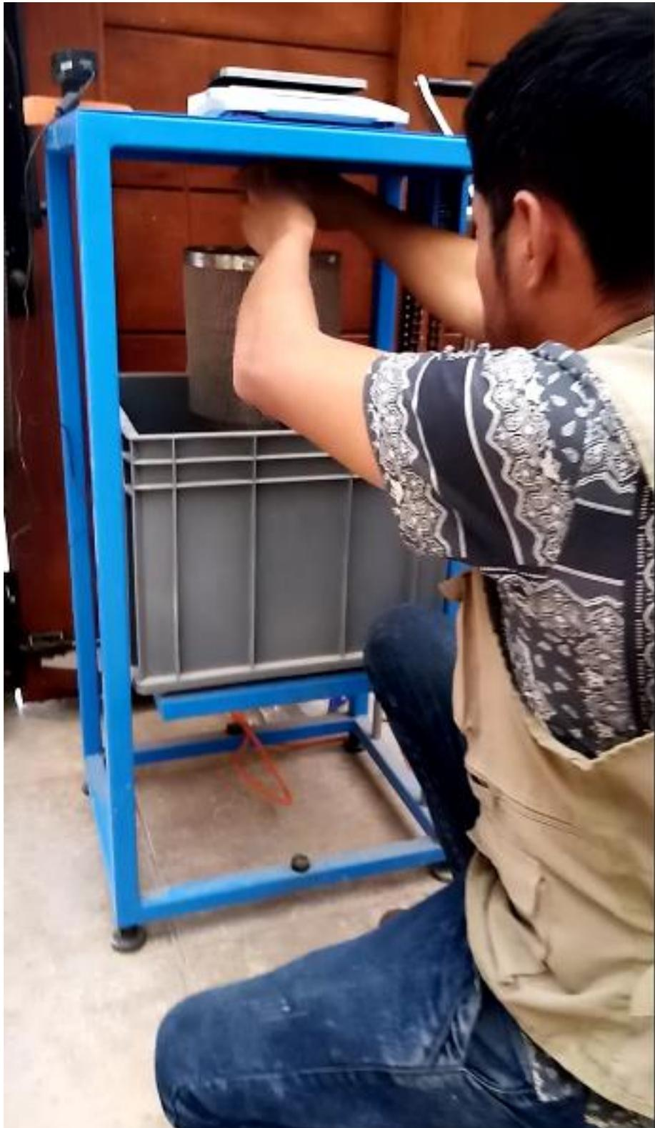
Realizando el ensayo para obtener el peso del agregado sumergido
