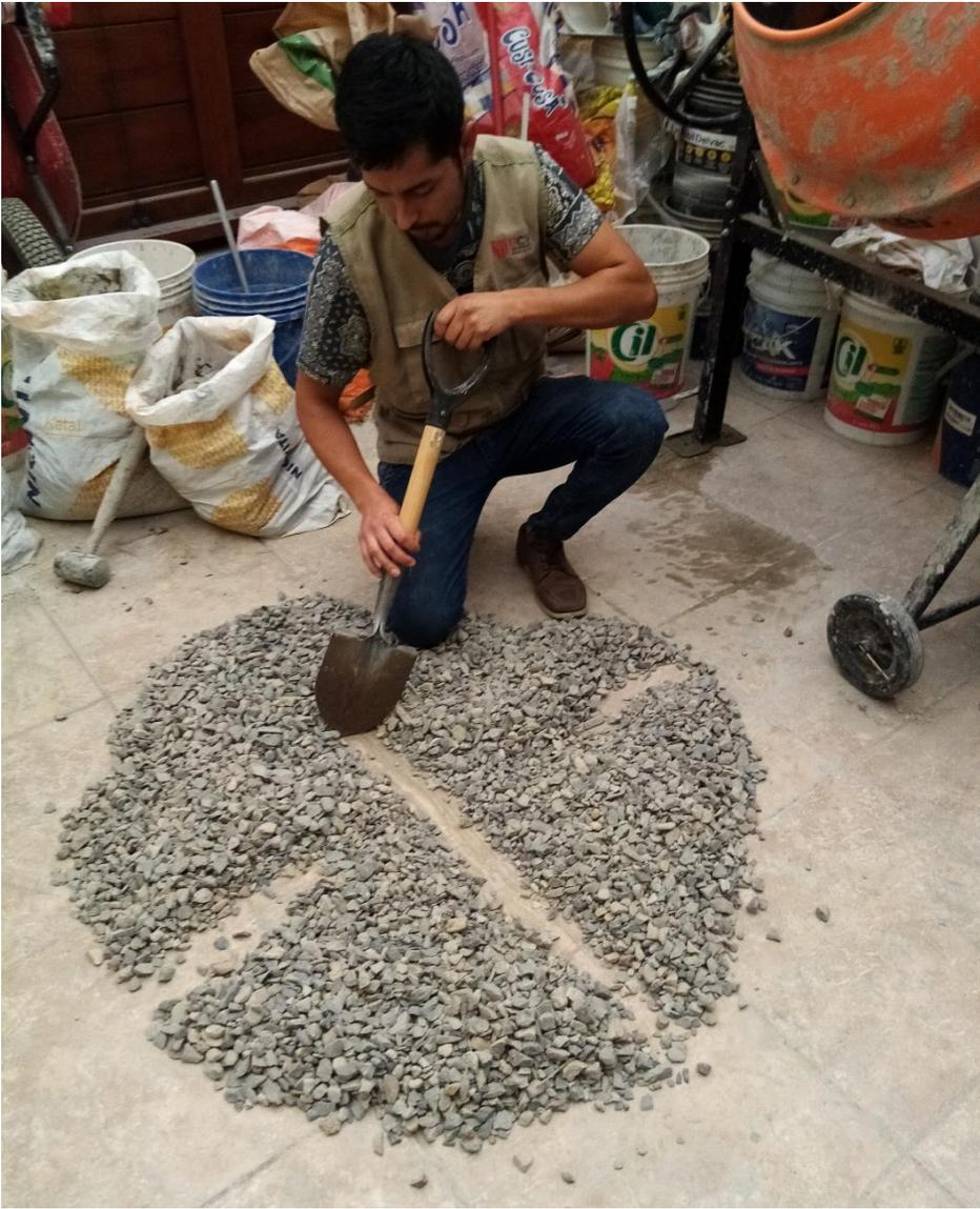
Realizando el ensayo de peso unitario suelto del agregado grueso
