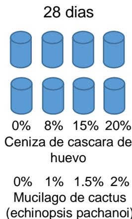
Ilustración 7. Distribucion y dosificacion de probetas
