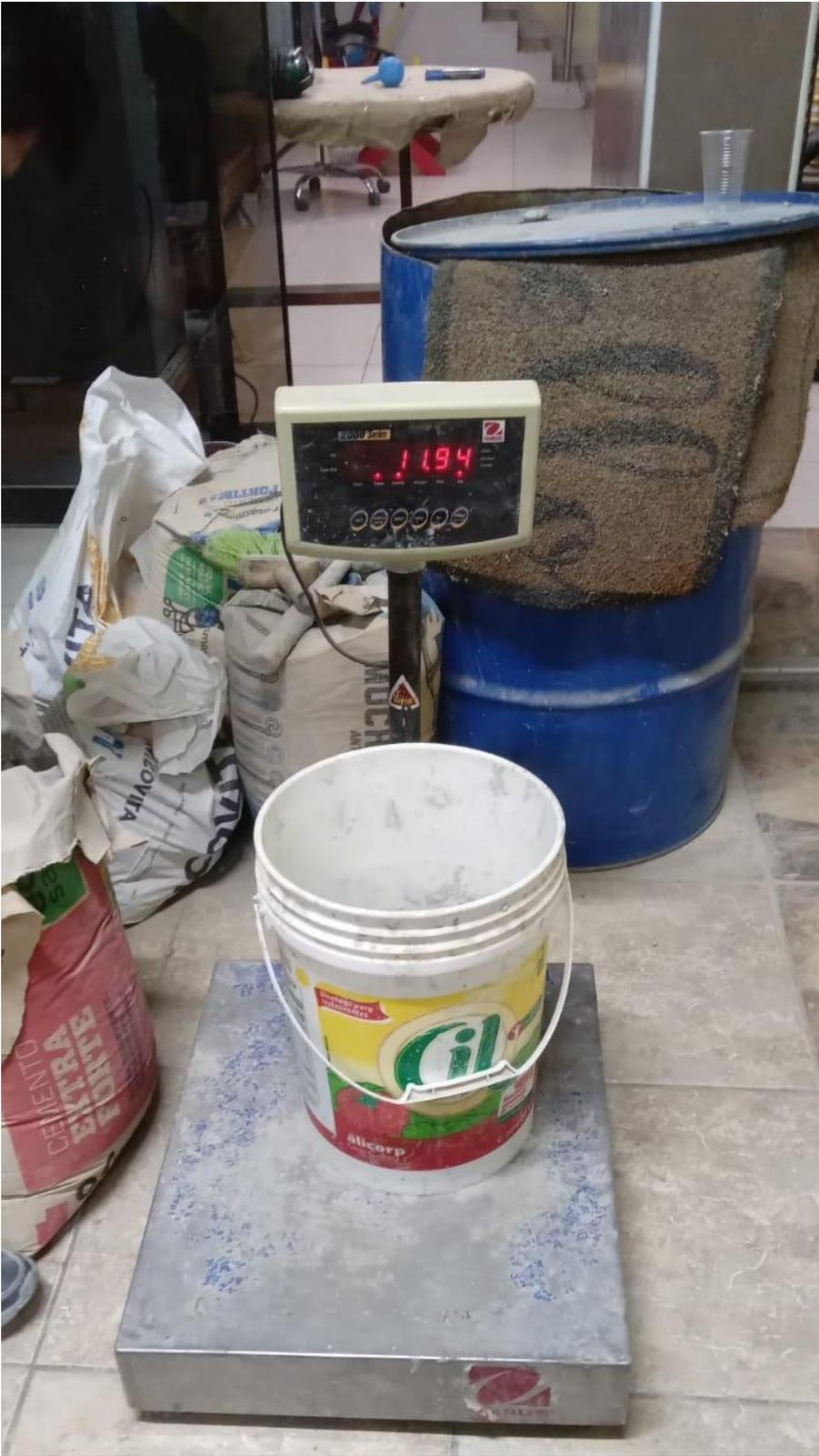
Pesado y vertido del agua en el trompo para la elaboración de las probetas
