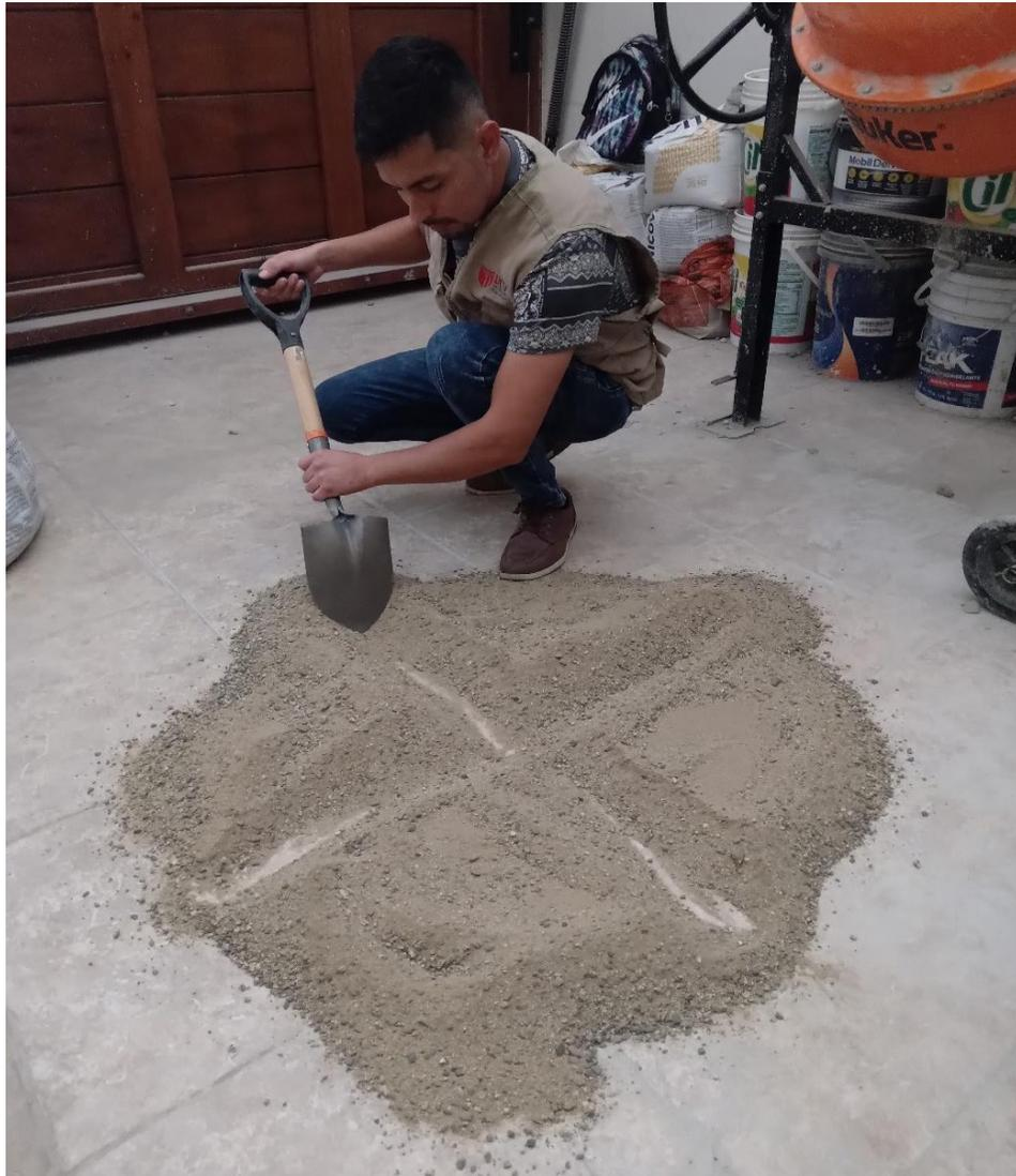
Realizando el ensayo del peso unitario suelto de la arena gruesa
