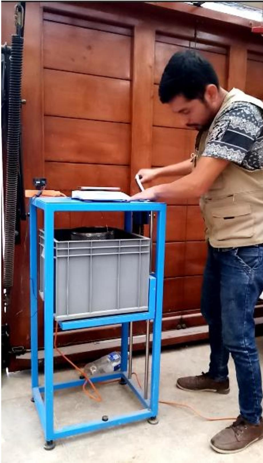
Realizando el ensayo del tamizado y la obtención de los pesos retenidos de la piedra
