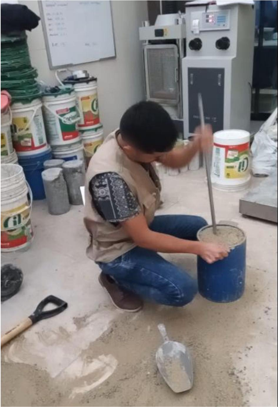
Ensayo de laboratorio para verificar que la arena gruesa a alcanzado un estado de triple S
