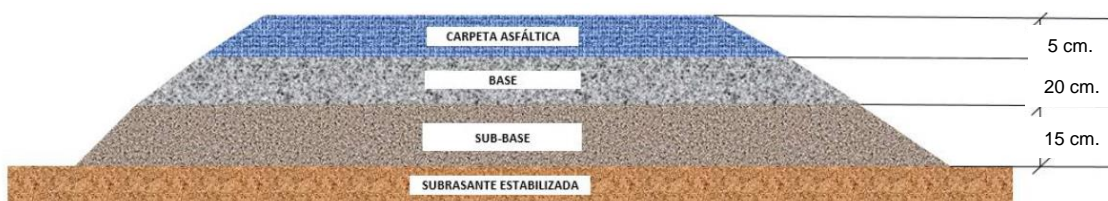
Figura 12 Diseño de sistema de pavimento
