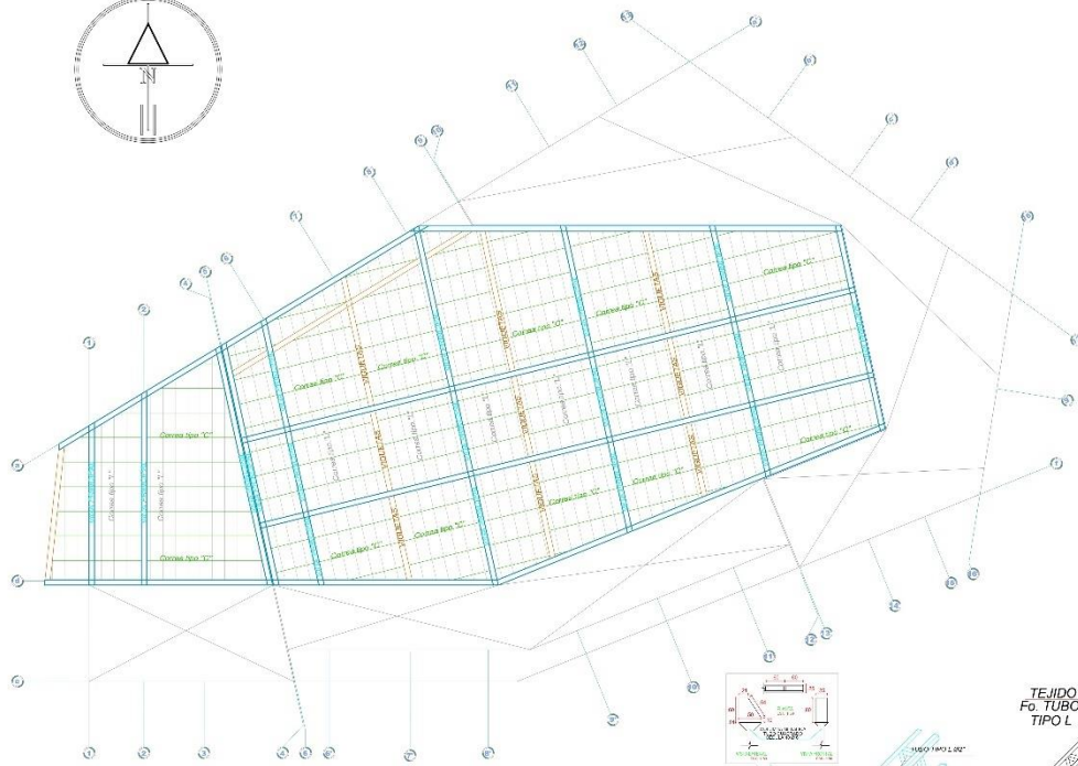
PLANO DE TECHOS: ESTRUCTURA METALICA ESCALA 1/75
