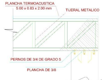
DETALLE DE CORREAS CORREA TIPO L ESC. 1/25
