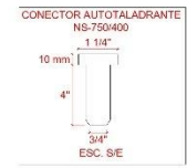
REMATE Y ENTREGA DE FORJADO COLABORANTE A VIGA METALICA ESC. S/E
