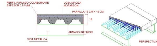
PERFIL FORJADO COLABORANTE ESC. S/E
