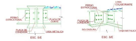
PERFIL FORJADO COLABORANTE ESC. S/E
