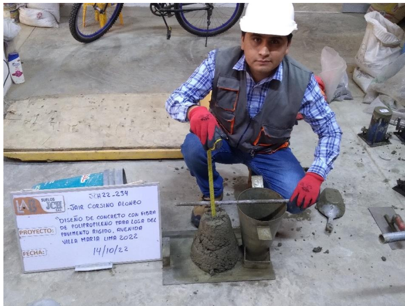
Ensayo de asentamiento (Slump) con 400 g. de fibra de polipropileno
