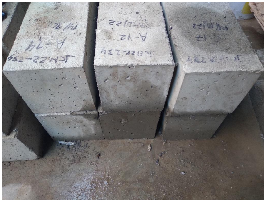
Curado de vigas
