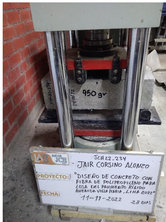
Resistencia a la flexión (Concreto + 950 gr/m 3 fibra de polipropileno)
