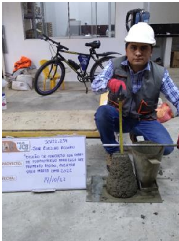
Ensayo de asentamiento (Slump) con 950 g. de fibra de polipropileno
