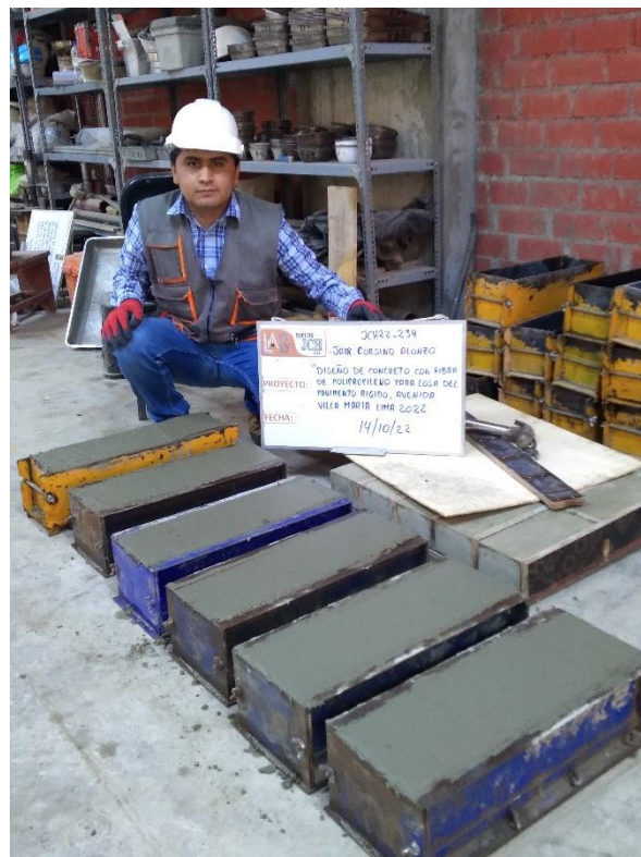
Vigas de concreto con incorporación de fibra de polipropileno
