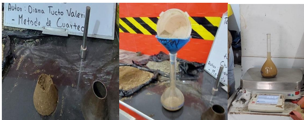
Figura 26. Fotografías de ensayos Peso específico y absorción para la arena chancada
