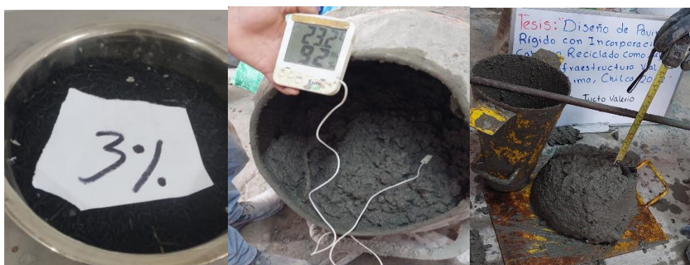
Figura 30. Fotografía de SLUMP y contenido de humedad de mezcla con 3% de Caucho Reciclado
