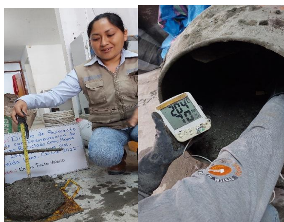
Figura 29. Fotografía de SLUMP y contenido de humedad con mezcla patrón
