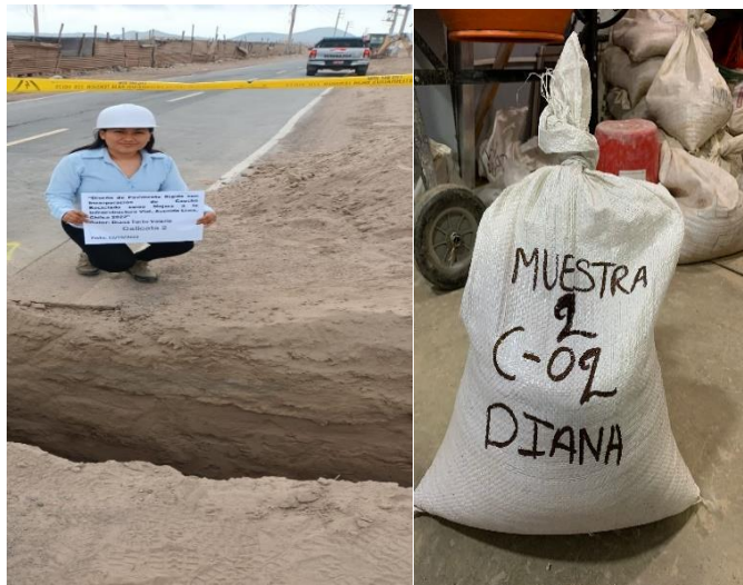
Figura 7. Muestra de calicata 2
