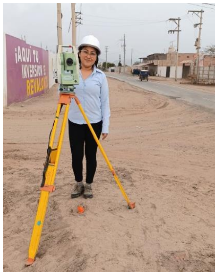
Figura 2. Estación para el levantamiento topográfico.
