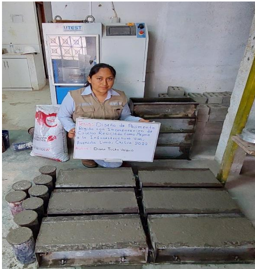
Curado de probetas cilíndricas y vigas simples
