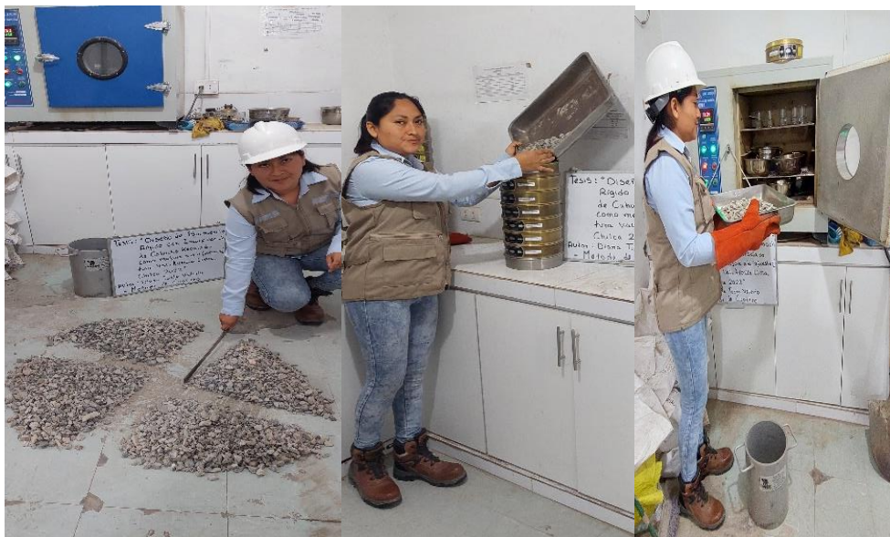
Figura 22. Fotografías de ensayos granulométrico por tamizado de la piedra chancada.
