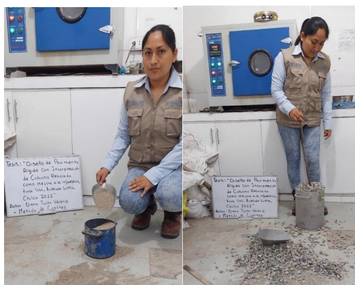
Figura 24. Fotografías del peso unitario para la arena chancada
