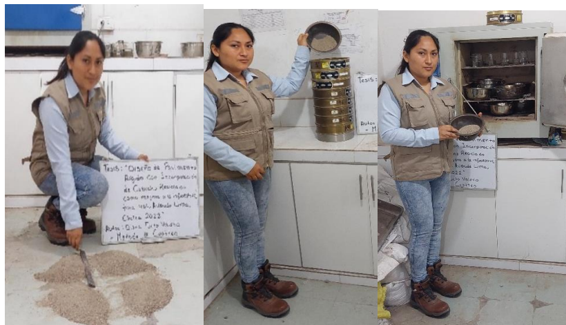
Figura 23. Fotografías de ensayos granulométrico por tamizado de la arena chancada
