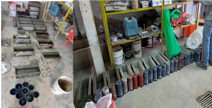
Figura 27. Molde de probetas para los ensayos a compresión y flexión.
