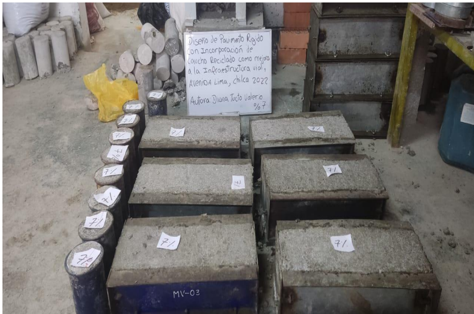
Curado de probetas cilíndricas y vigas simples
