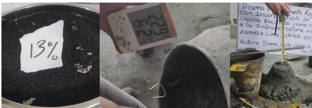
Figura 32. Fotografía de SLUMP y contenido de humedad de mezcla con 7% de Caucho Reciclado
