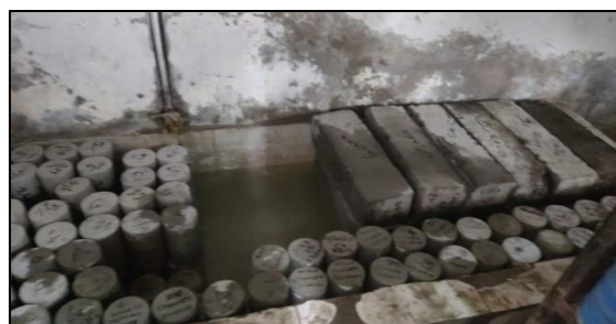
Figura 34. Fotografía del curado de probetas
