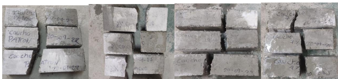
Figura 35. Rotura de probetas con mezcla patrón y con el 3%, 7% y 13% de caucho reciclado
