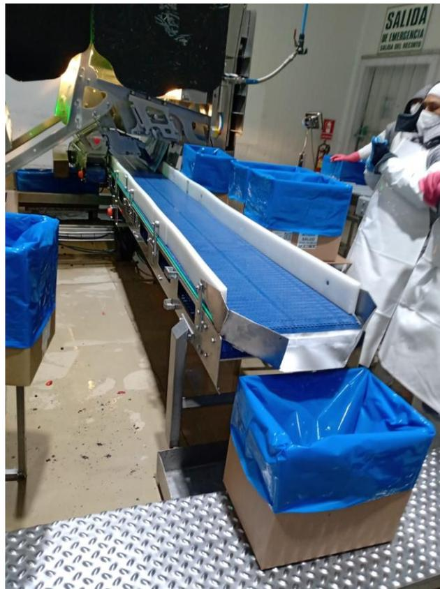
**Ilustración 5:** *Faja transportadora de mango en cuadrados junto a la caja de 13.6kg que será llenada manualmente.*
