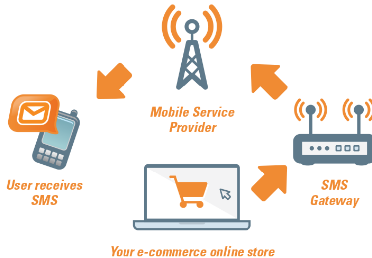
Figure 4 Funcionamiento de una API SMS
