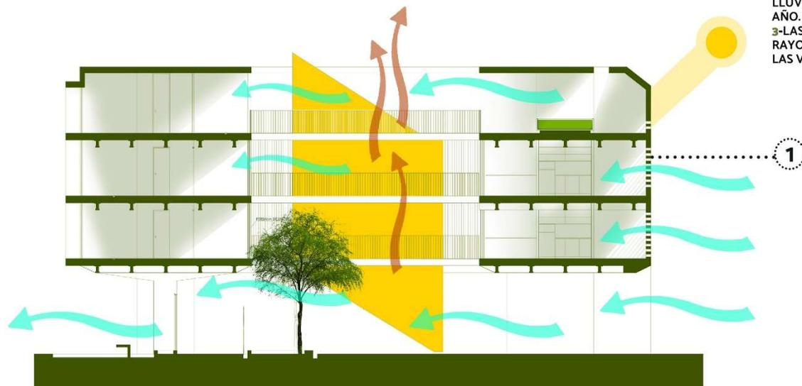
1- EL USO DE LAS CELOSÍAS FILTRA EL PASO DEL VIENTO SUAVIZANDO SU IMPACTO EN LA CARA SUR Y PROTEGE DE LA RADIACIÓN EN VERANO, AL CONTRARIO DE LA CARA NORTE DONDE EL EDIFICIO SE ABRE HACIA OS RAYOS SOLARES DEL INVIERNO Y PERMINTEN LA VENTILACIÓN CRUZADA.
