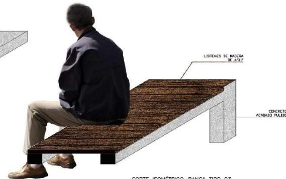
CORTE ISOMÉTRICO-BANCA TIPO 03
