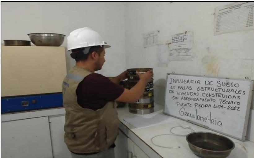
Figura 7. Ensayo granulométrico del suelo por tamizado.
