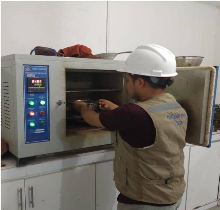
Figura 34. Colocación de la muestra al horno.
