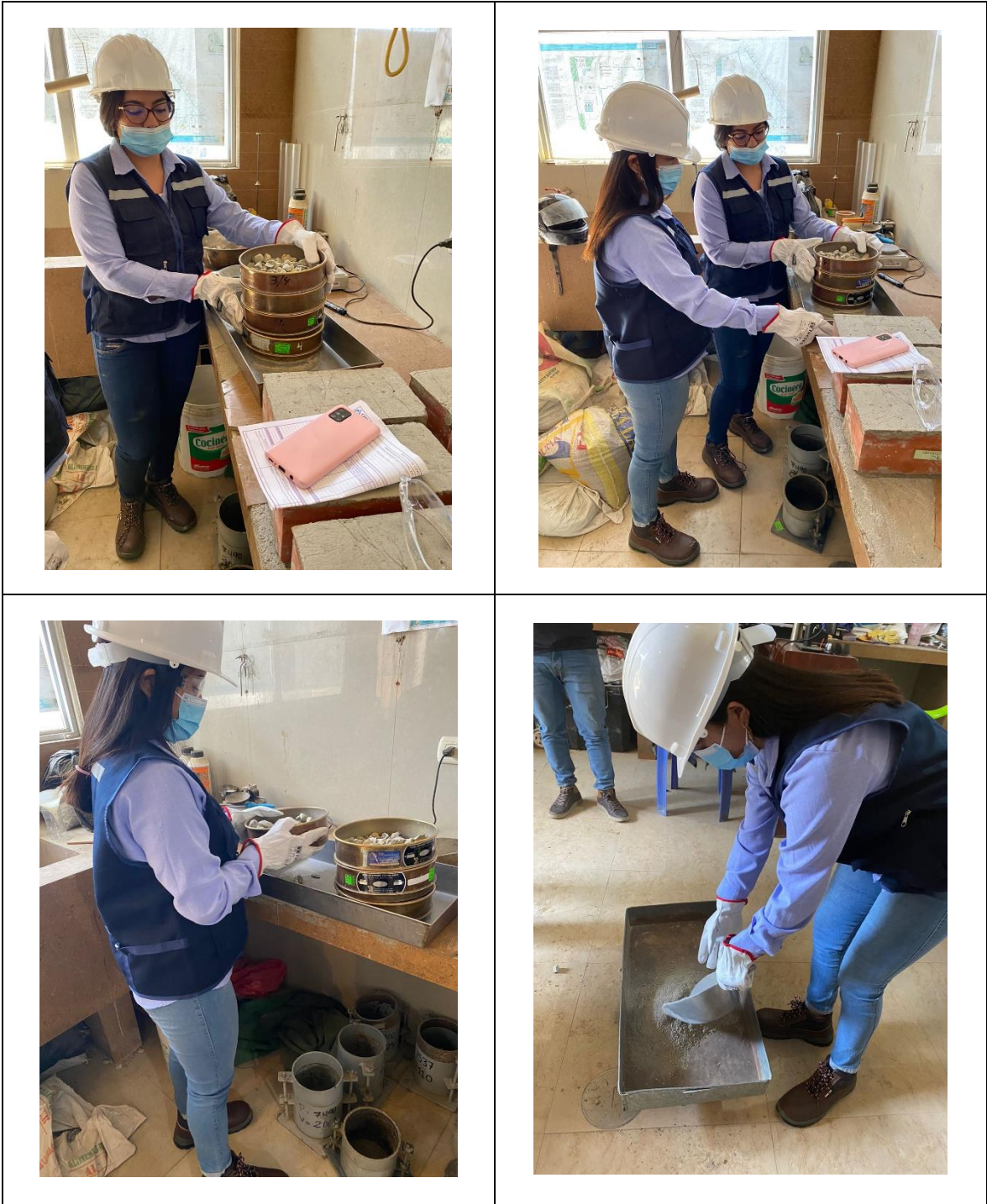
Ensayo de análisis granulométrico de agregados en el laboratorio
