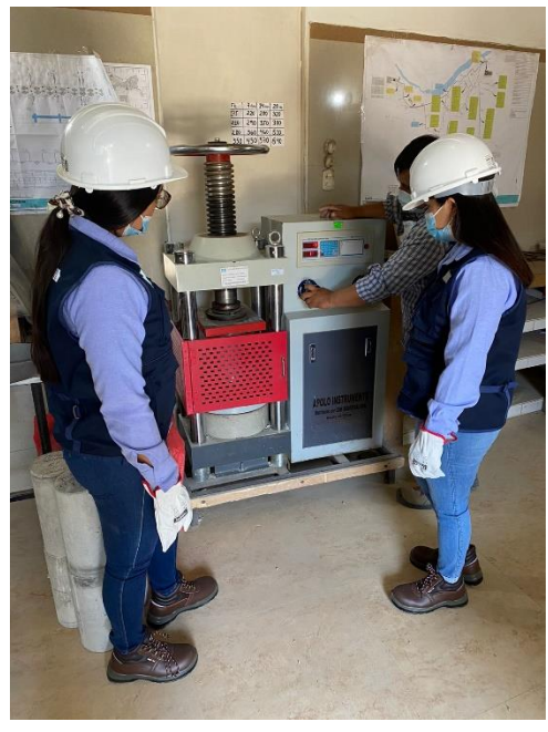
Rotura de probetas de concreto (Resistencia a la compresión de cilindros ASTM C-39)
