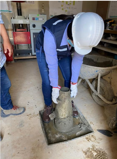
Ensayo de revenimiento para determinar la trabajabilidad del concreto (Prueba de Slump)
