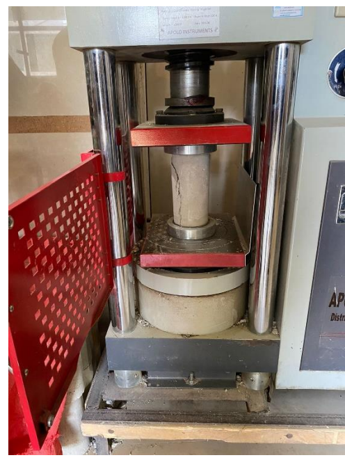
Rotura de probetas de concreto (Resistencia a la compresión de cilindros ASTM C-39)
