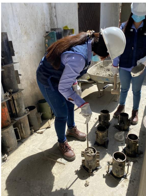
Elaboración de probetas de concreto (NTP 339.033)
