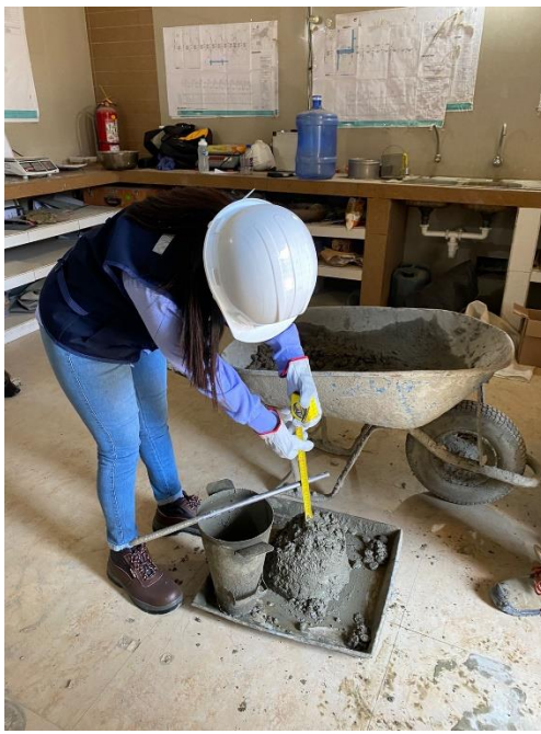
Ensayo de revenimiento para determinar la trabajabilidad del concreto (Prueba de Slump)
