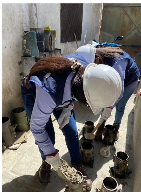
Elaboración de probetas de concreto (NTP 339.033)
