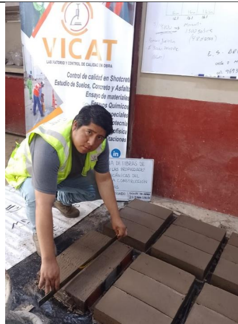
Fotografía 10. Regleado para eliminar el material excedente.
