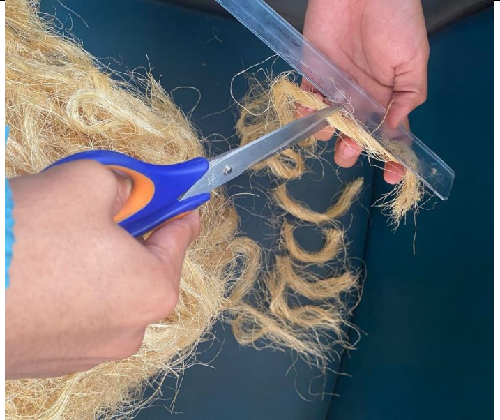
Fotografía 10. Recortado de las fibras de cuyabuyo a 10cm.
