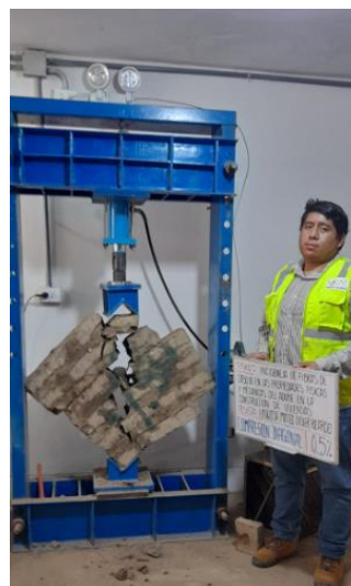
Fotografía 24. Rotura del murete del Ge2
