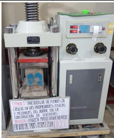
Fotografía 19. Realización del ensayo axial de pilas del Ge2
