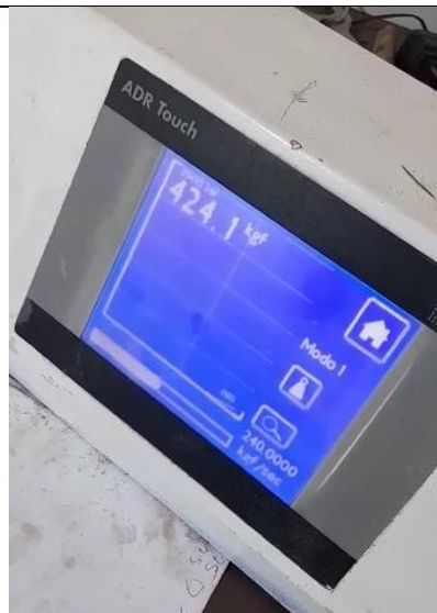
Fotografía 22. Resultado del ensayo a la compresión diagonal de muretes del Gp
