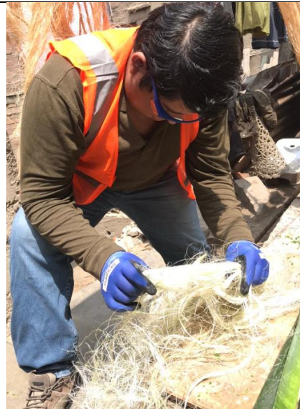
Fotografía 4. Obtención de fibra cabuya
