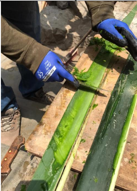
Fotografía 3. Deshilachado de la penca para obtener la fibra de cabuya
