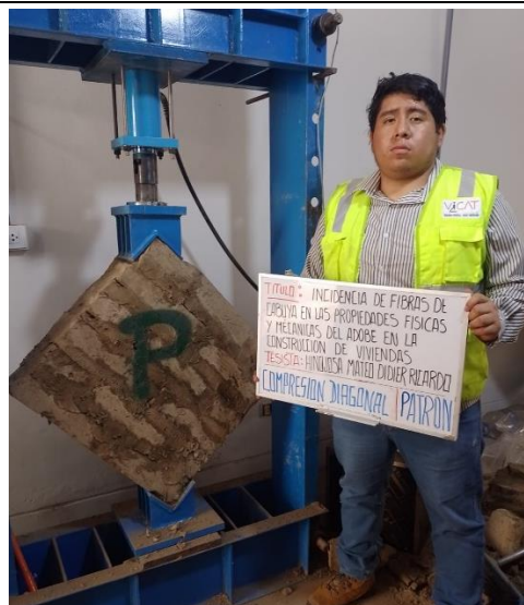
Fotografía 20. Realización del ensayo a compresión diagonal de muretes del Gp.
