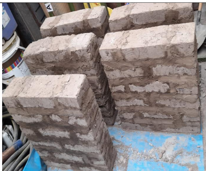
Fotografía 18. Secado de los muretes
