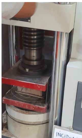
Fotografía 17. Realización del ensayo de resistencia a la compresión.
