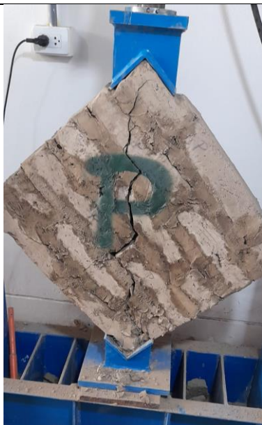
Fotografía 21. Rotura del ensayo del Gp
