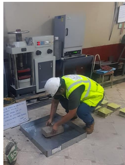
Fotografía 16. Realización del ensayo a succión
