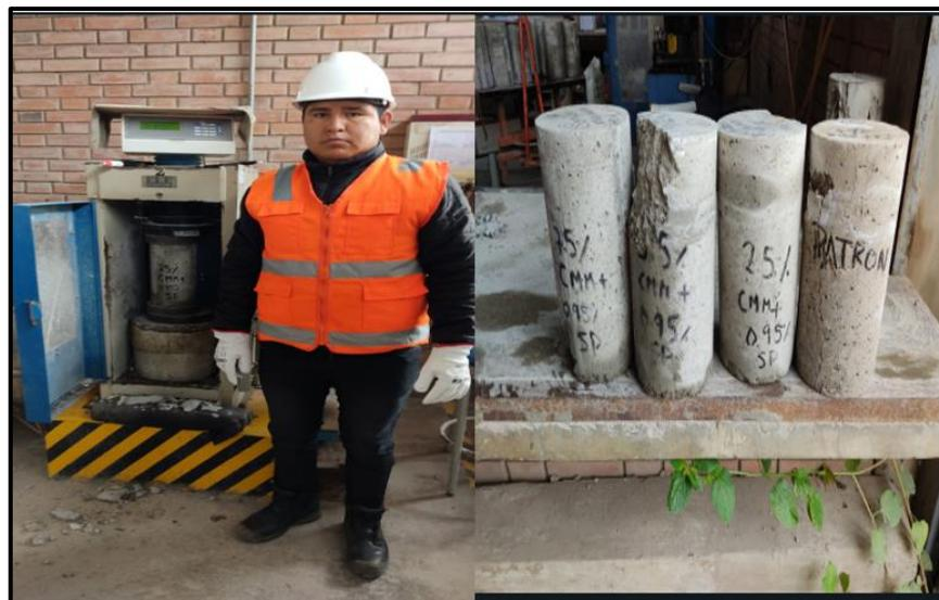
Figura 27. Resistencia a Compresión de probetas de concreto
