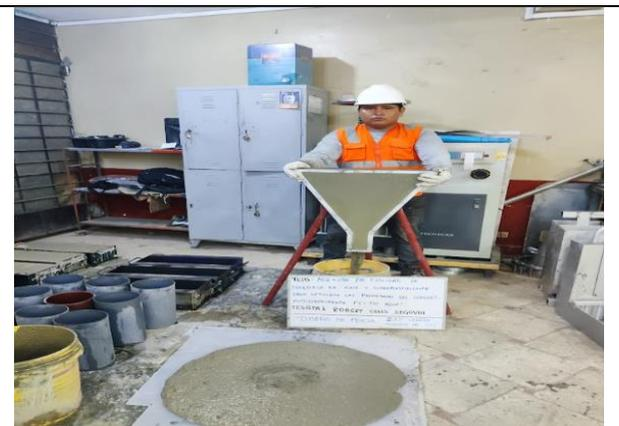
Fotografía 12. Ensayo de V-Funnel
