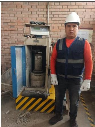
Fotografía 23. Ensayo de resistencia a compresión a los 14 días
