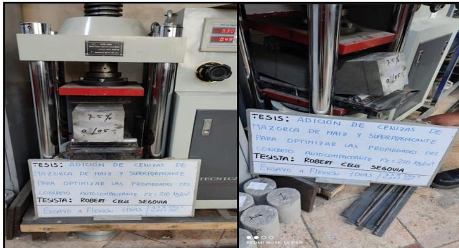
Figura 28. Resistencia a Flexión de probetas de concreto
