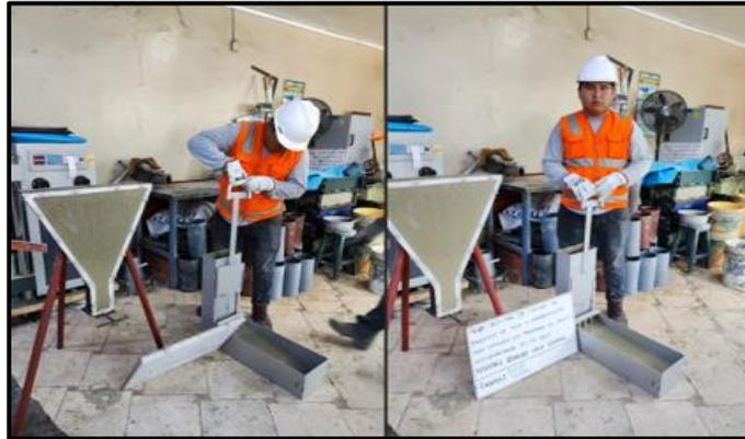
Figura 20. Ensayo de caja L
