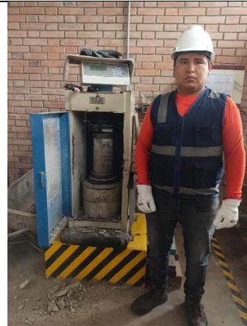
**Fotografía 30.** Roturas ensayo a Compresión
