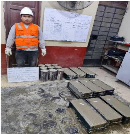
Fotografía 19. Elaboración probetas y vigas
