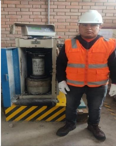
**Fotografía 25.** Ensayo de resistencia a compresión a los 28 días
