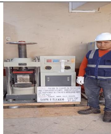
Fotografía 24. Ensayo de flexión a los 14 días
