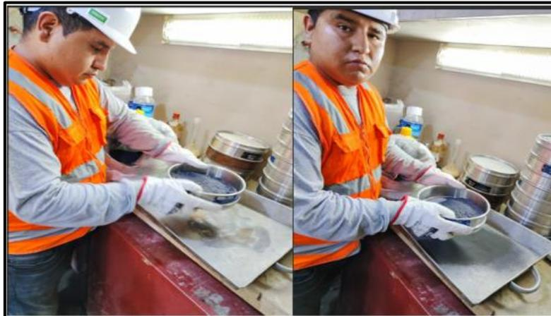
Figura 12. Tamizado de las cenizas de mazorca de maíz.
