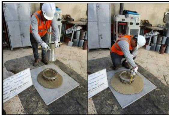
Figura 22. Ensayo de J- Ring
