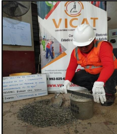
*Figura 18. Peso unitario suelto de los agregados*
