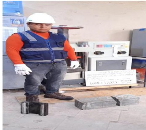
**Fotografía 28.** Roturas ensayo a Flexión
