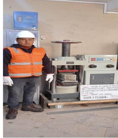
**Fotografía 26.** Ensayo de flexión a los 28 días
