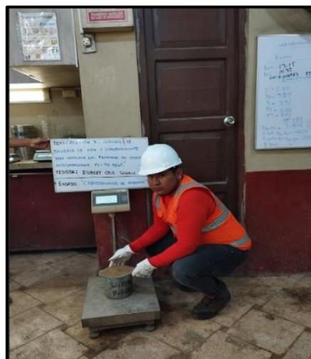
*Figura 17. Peso unitario compactado de los agregados*
