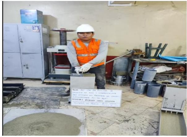
Fotografía 14. Ensayo de U-Box
