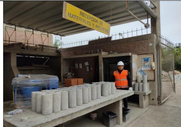
Fotografía 18. Almacenamiento de las probetas
