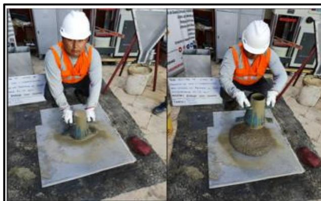
Figura 21. Ensayo de slump Flow +T50+VSI
