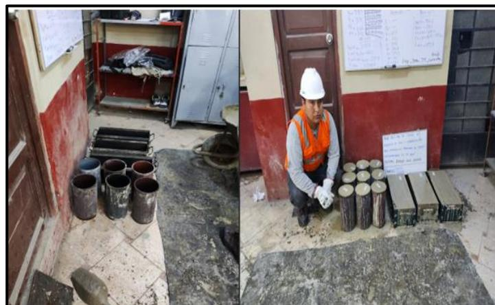
*Figura 25. Elaboración de probetas y vigas de concreto*
