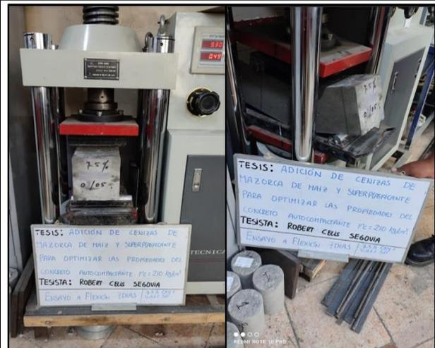
Fotografía 22. Ensayo de flexión a los 7 días
