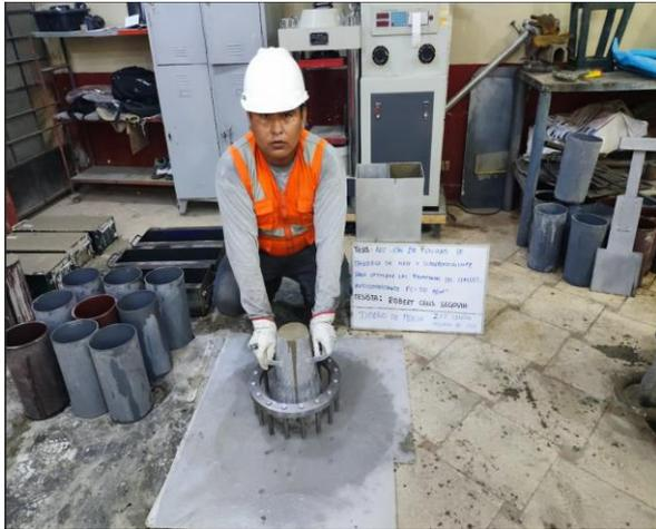
Fotografía 15. Ensayo de J- Ring
