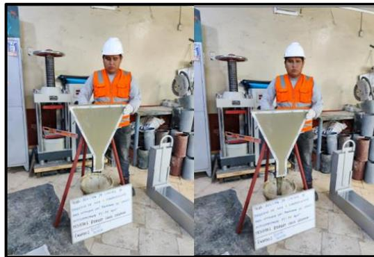
*Figura 24. Ensayo de V-Funnell*
