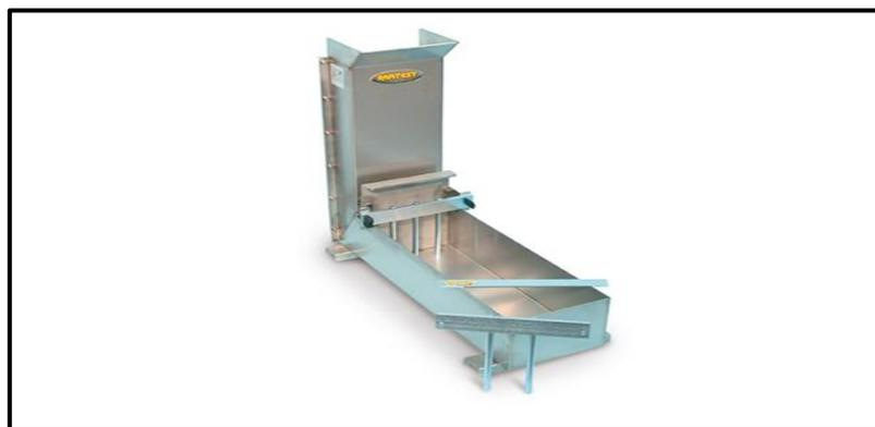
*Figura 8. Caja "L" para ensayo de fluidez.*
