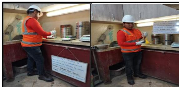
*Figura 15. Ensayo de gravedad específica y absorción del agregado fino*
