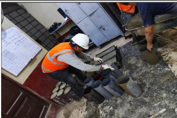
Fotografía 17. Elaboración de probetas y vigas
