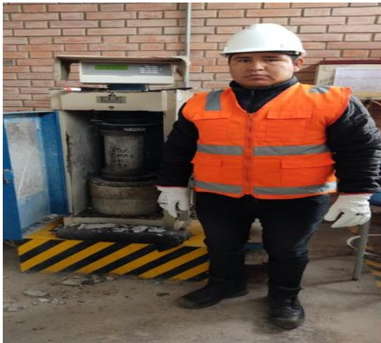
Fotografía 21. Ensayo de resistencia a compresión a los 7 días
