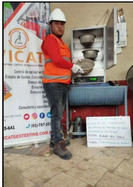
Figura 13. Ensayo de contenido de humedad
