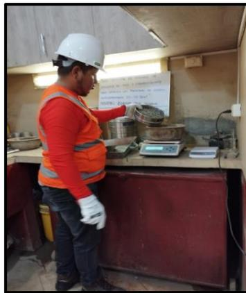
*Figura 14. Granulometría de los agregados*
