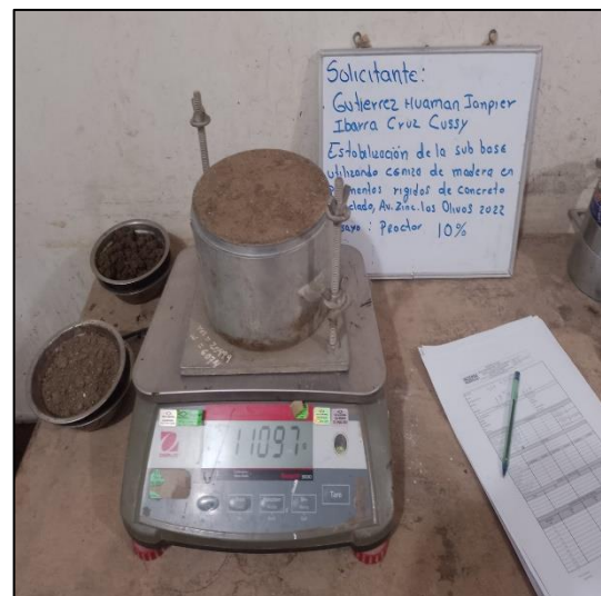
Figura 44. Ensayo de Proctor modificado
