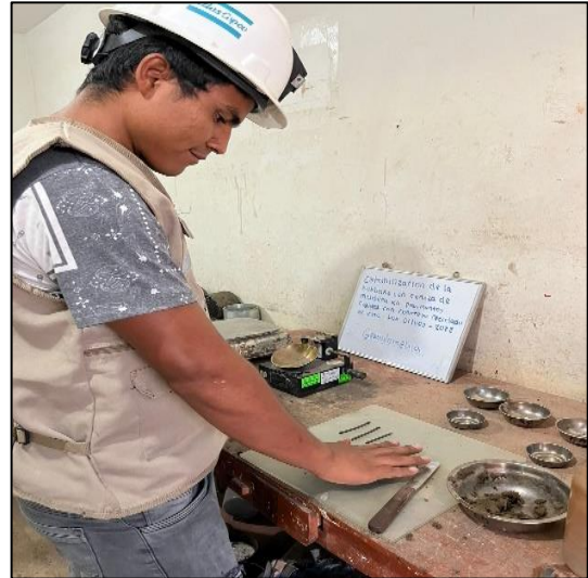
Figura 41. Ensayo de LP
