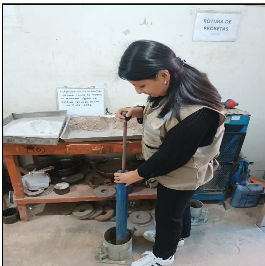
Figura 43. Compactación por capas
