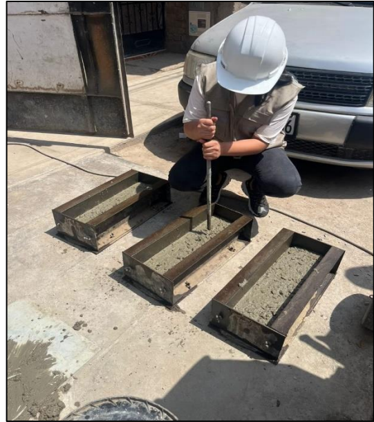
Compactación de la mezcla
