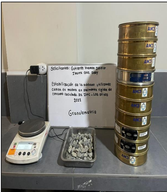
Tamizado del agregado de concreto reciclado
