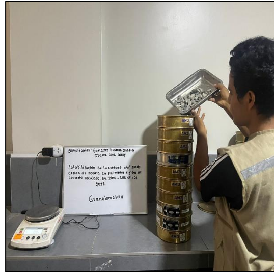
Figura 52. Tamizado agregado grueso
