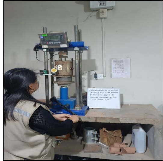
Figura 48. Ensayo del CBR
