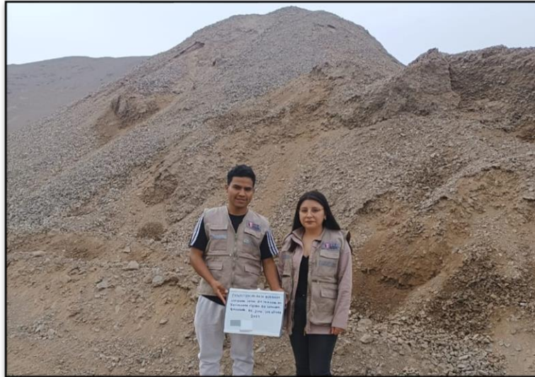
Figura 18. Material afirmado para la subbase
