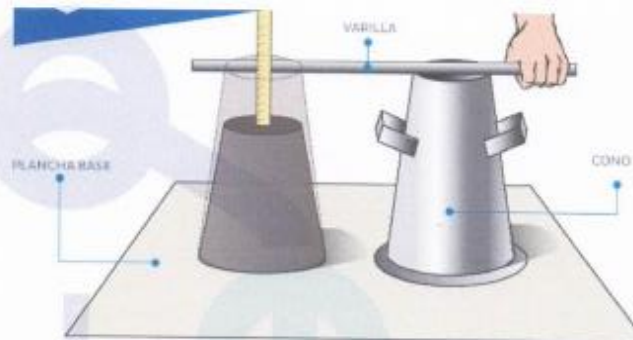
MÉTODO DEL SLUMP
