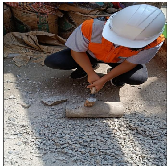
Figura 15. Trituración del concreto
