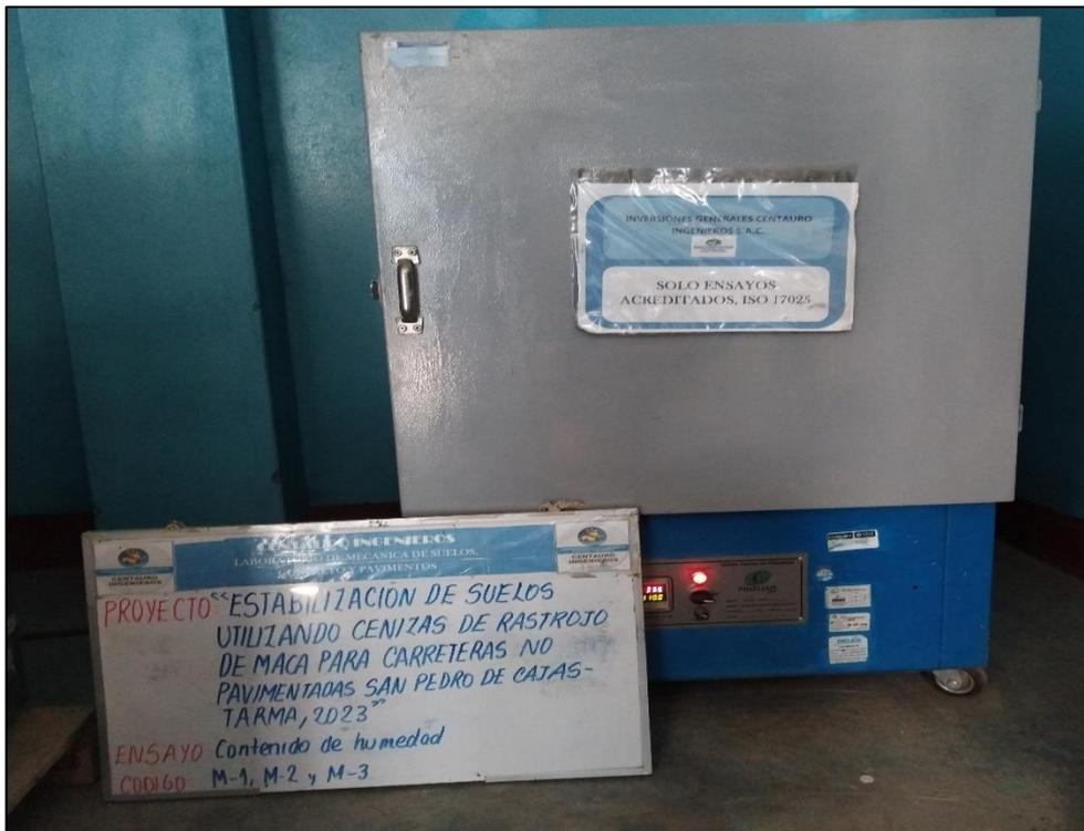
Fotografía N° 4: Ensayo para determinar el Contenido de humedad
