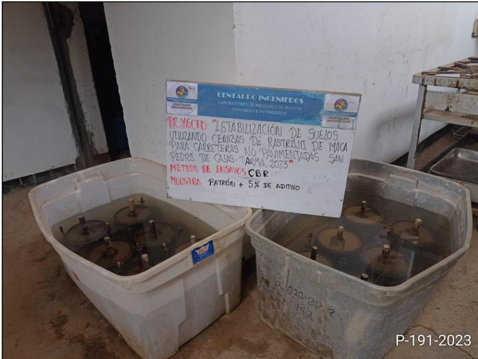
Fotografía N° 5: Ensayo de CBR
