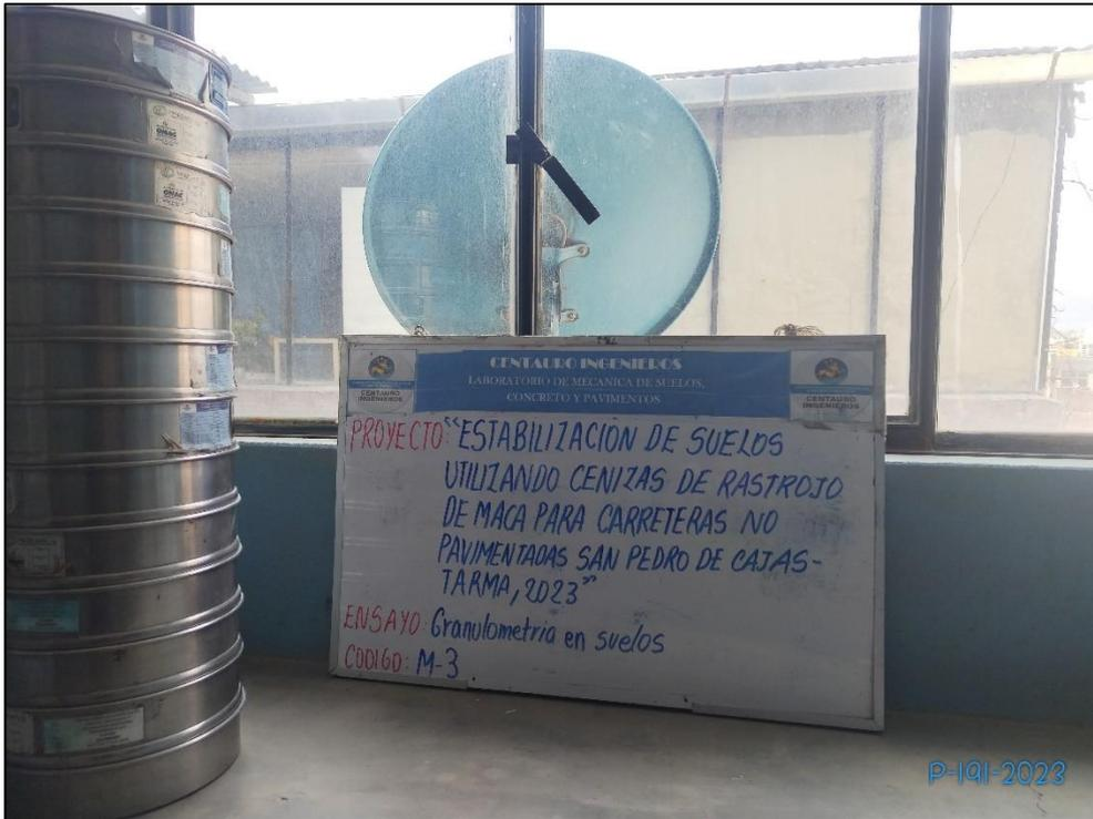
Fotografía N° 3: Ensayos de granulometría M3
