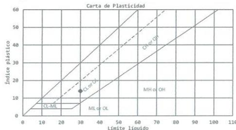
**NTP 339.134:1999 (Revisada el 2019) SUELOS. Método para la clasificación de suelos con propósitos de ingeniería (sistema unificado de clasificación de suelos, SUCS)**
