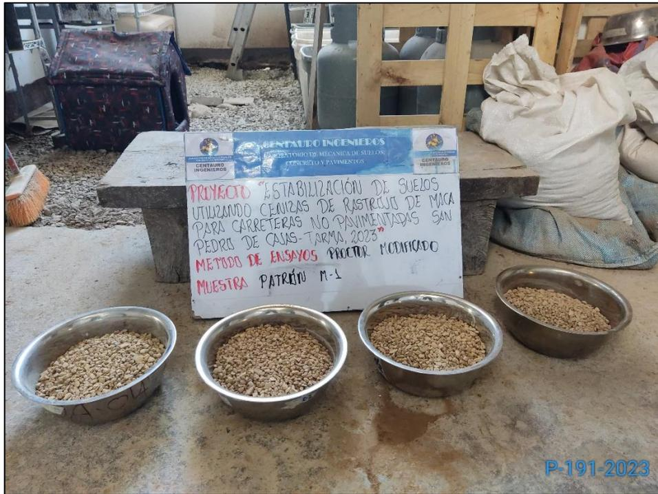
Fotografía N° 7: Ensayo de Proctor modificado
