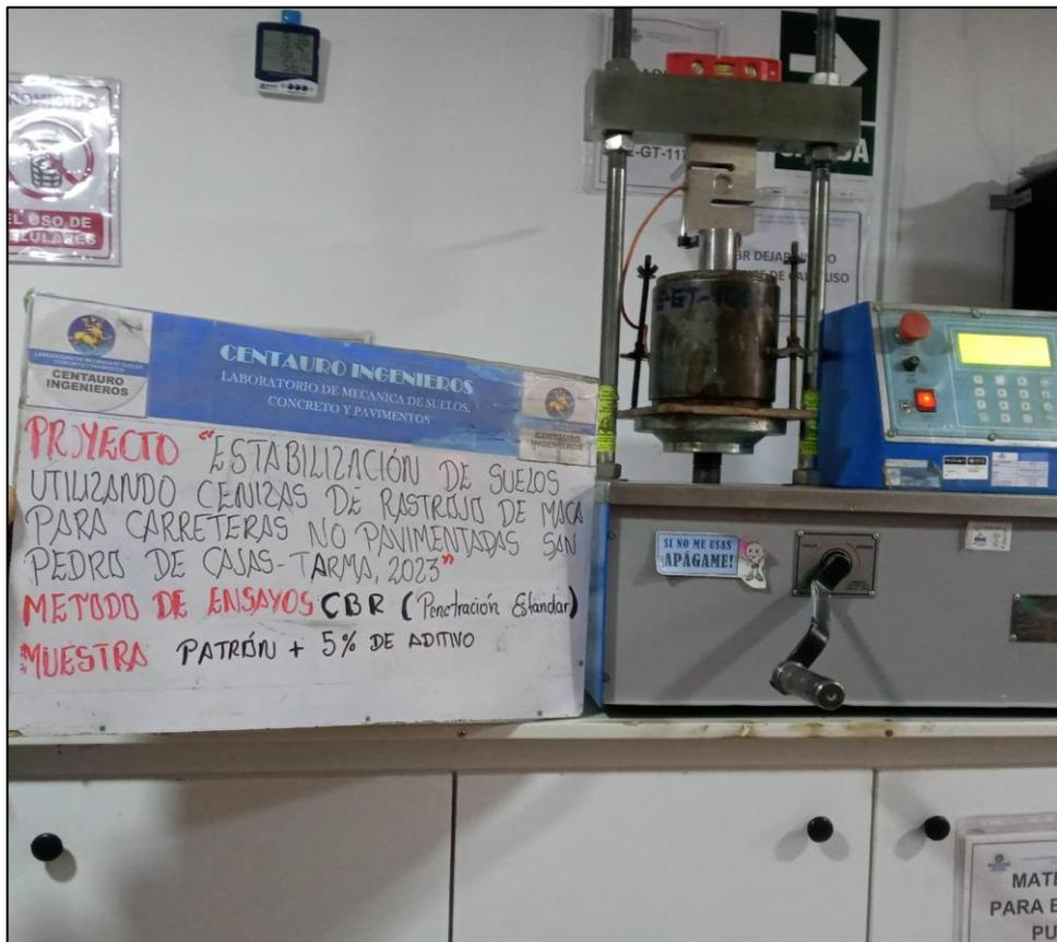
Fotografía N° 6: Ensayo de CBR
