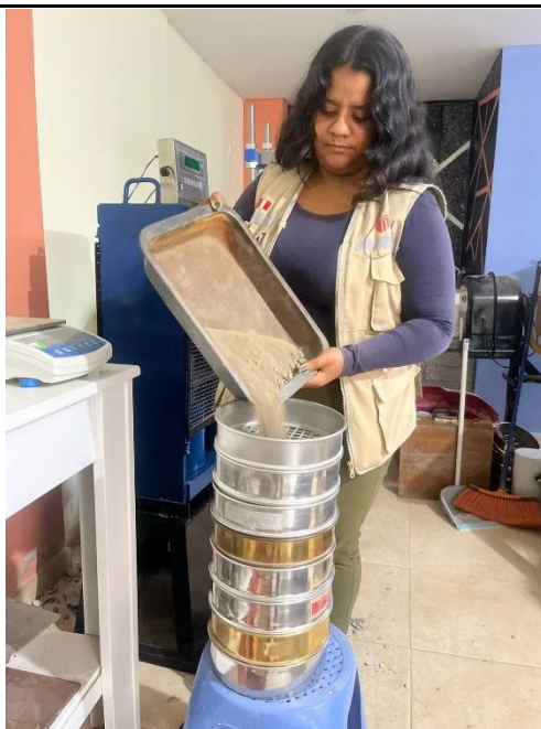
Imagen Nro. 07: Ensayo de Tamizaje en Laboratorio
