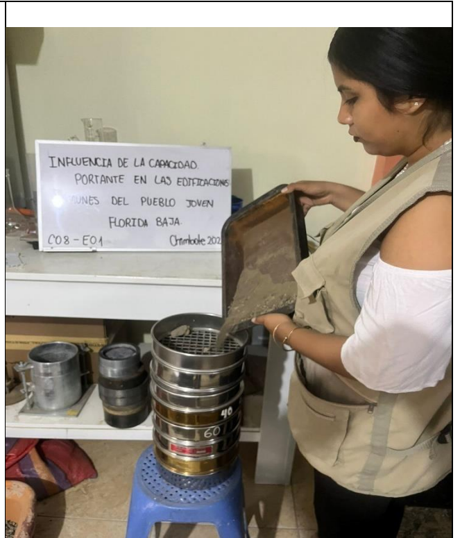
Imagen Nro. 06: Ensayo de tamizaje en laboratorio
