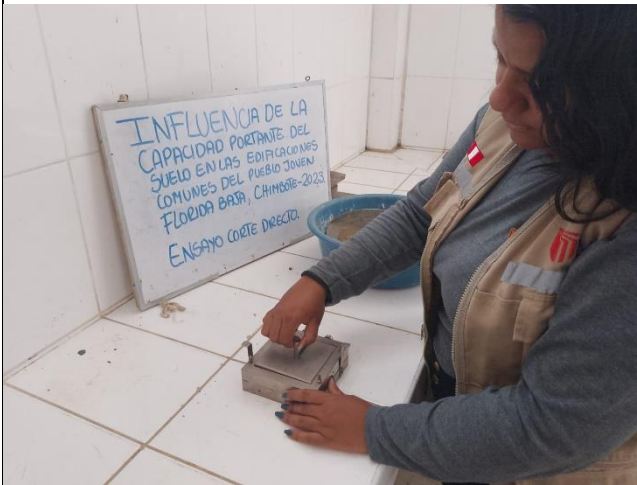
Imagen Nro. 15: Ensayo de corte directo en laboratorio
