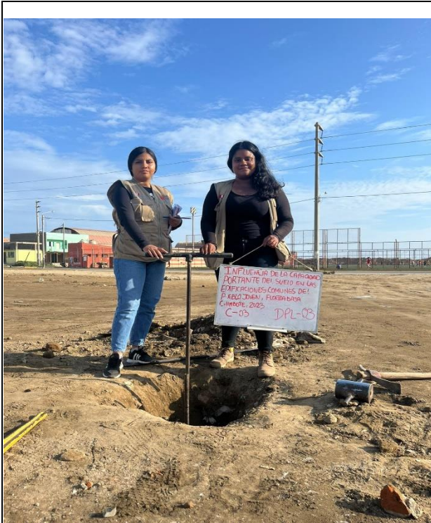
Imagen Nro. 05: Ensayo de DPL -08 en campo
