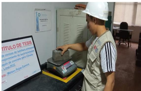
Figura 32. Pesado del adoquín antes de colocarlo en el horno eléctrico
