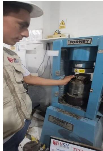
Figura 36. Observando el adoquín después del ensayo de compresión
