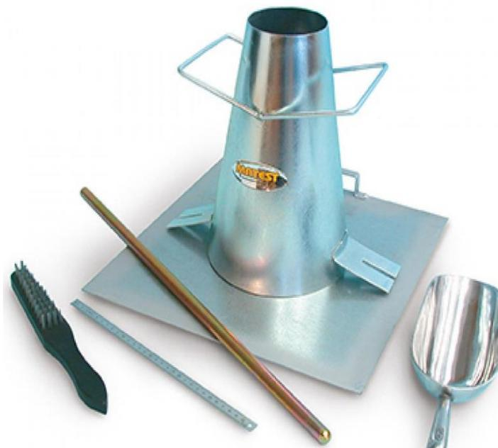
Figura 10. Cono de Abrams y sus instrumentos
