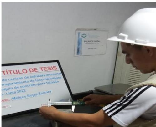
**Fotografía 27:** Realizando la medición del alto del adocquin de concreto para ver la variación dimensional
