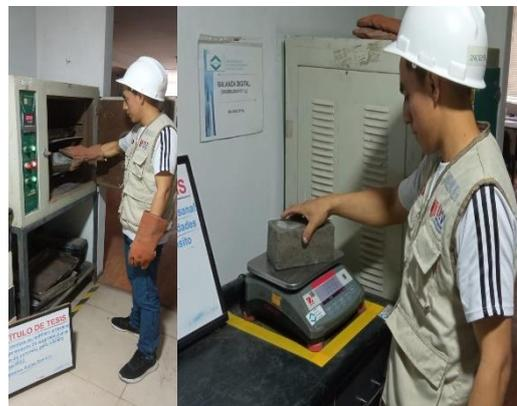
**Fotografía 28:** Realizando el ensayo de absorción del adocquin de concreto
