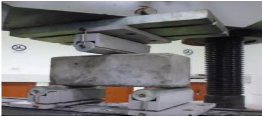
*Figura 15.* Ensayo de flexión
