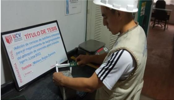
**Fotografía 25:** Realizando la medición del ancho del adocquin de concreto para ver la variación dimensional
