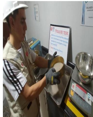
*Figura 18.* Realizando el tamizado de las cenizas de ladrillera artesanal
