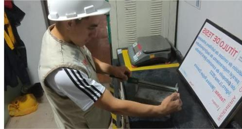
**Fotografía 26:** Realizando la medición del largo del adocquin de concreto para ver la variación dimensional
