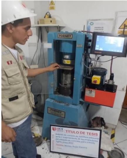
Figura 35. Colocando el adoquín en la prensa hidráulica
