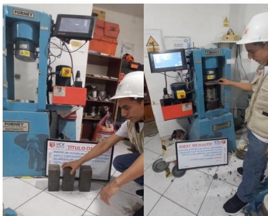
**Fotografía 29:** Realizando el ensayo a la compresión de los adocquines de concreto
