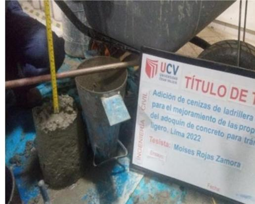
**Fotografía 20:** Realizando la prueba del slump de la mezcla de concreto
