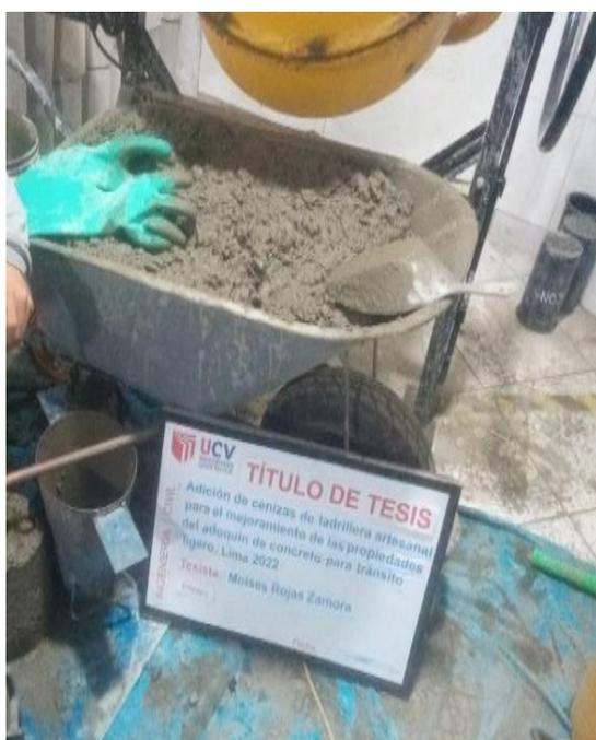
Figura 26. Ensayo del slump del concreto
