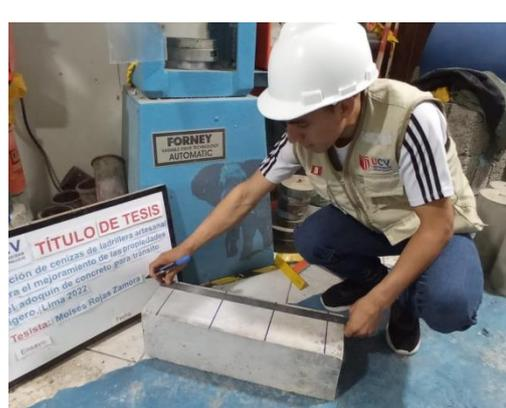
**Fotografía 30:** Realizando la medición para el ensayo de flexión en una viga de concreto
