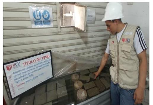
**Fotografía 24:** Verificando el curado de los adoquines de concreto
