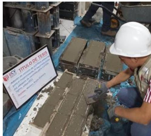
Figura 22. Preparación el llenado en los moldes del adoquín
