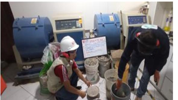
**Fotografía 17:** Preparando la dosificación de los materiales para la mezcla del concreto
