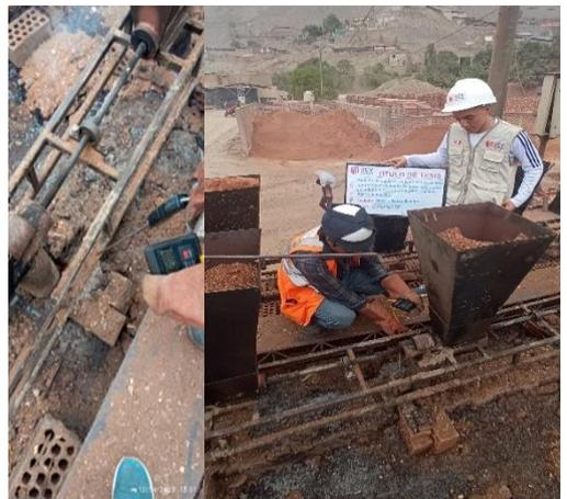
**Fotografía 4:** Realizando la medición de la temperatura de calcinación de la ceniza
