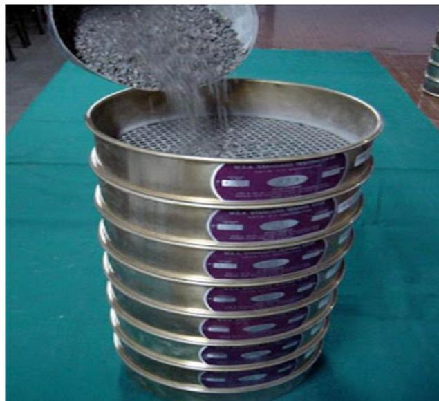
*Figura 8.* Proceso del tamizado.
