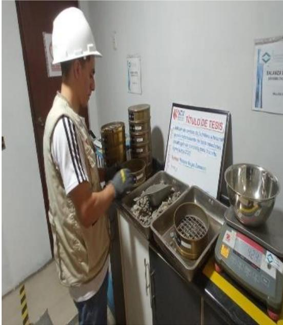
Figura 19. Ensayo de la granulometría de los agregados
