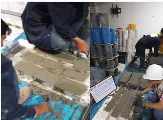
**Fotografía 21:** Colocación de la mezcla de concreto en los moldes
