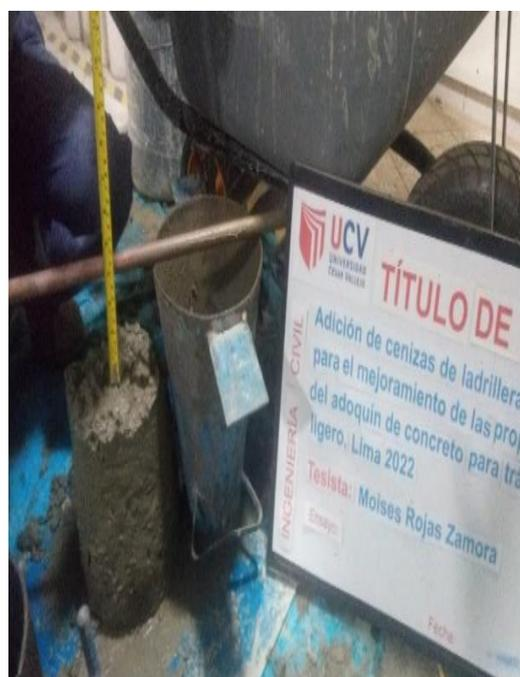
Figura 27. Medición del slump del concreto
