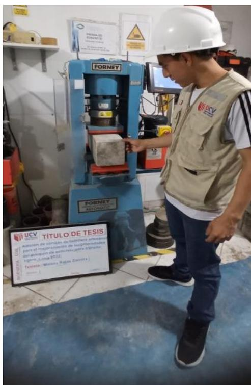
Figura 38. Colocación de la viga para el ensayo de flexión
