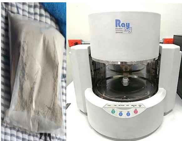
**Fotografía 5:** Ensayo de la composición química de la ceniza
