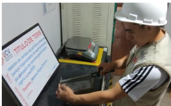
Figura 30. Realizando la medición de largo del adoquín
