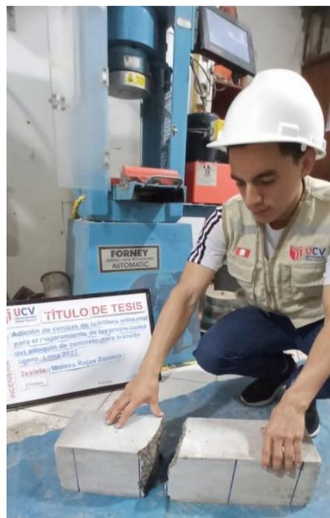
Figura 39. Observando la fractura en la viga después del ensayo de flexión
