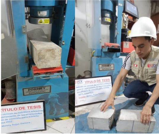
**Fotografía 31:** Realizando el ensayo de flexión en una viga de concreto
