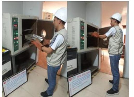
**Fotografía 16:** Realizando el secado de la arena gruesa
