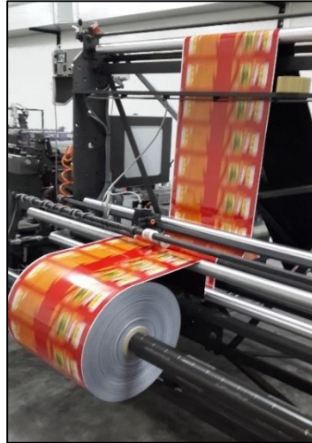
Figura 19: Bobinas colocadas en máquina Totani y ajuste de bobina
