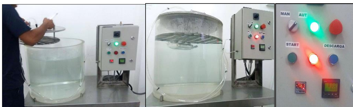
Figura 40: Equipo de hermeticidad detector de fugas
