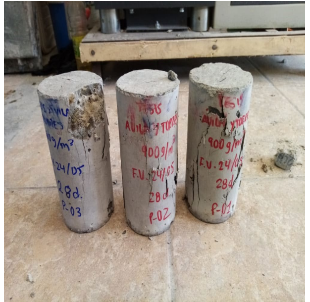
Fotografía N°13 Y 14: Ensayo de compresión del concreto + microfibras sintética de acuerdo a las dosificaciones a una edad de 1,3,7 y 28 días.
