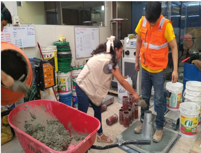
Fotografía N°03 Y 4: Ensayo de asentamiento del concreto (slum)
