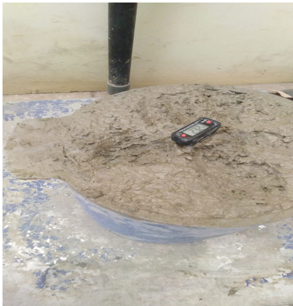
Fotografía N°05: Toma de temperatura del concreto+ Ms en estado fresco
