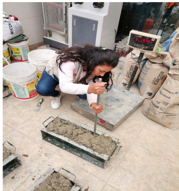
Fotografía N°07 Y 08: Elaboración de especímenes de concreto patrón y adicionando microfibra sintética en vigas y cilindros.
