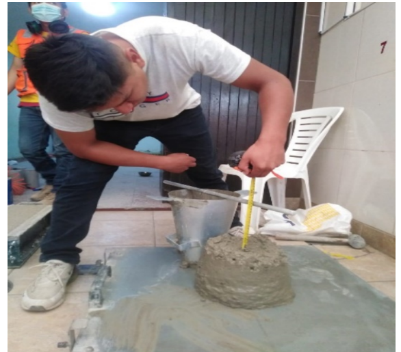
Fotografía N°03 Y 4: Ensayo de asentamiento del concreto (slum)
