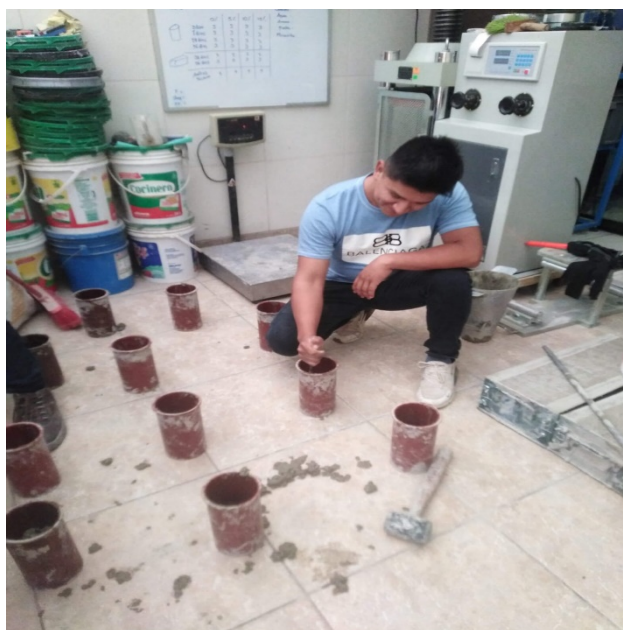
Fotografía N°07 Y 08: Elaboración de especímenes de concreto patrón y adicionando microfibra sintética en vigas y cilindros.
