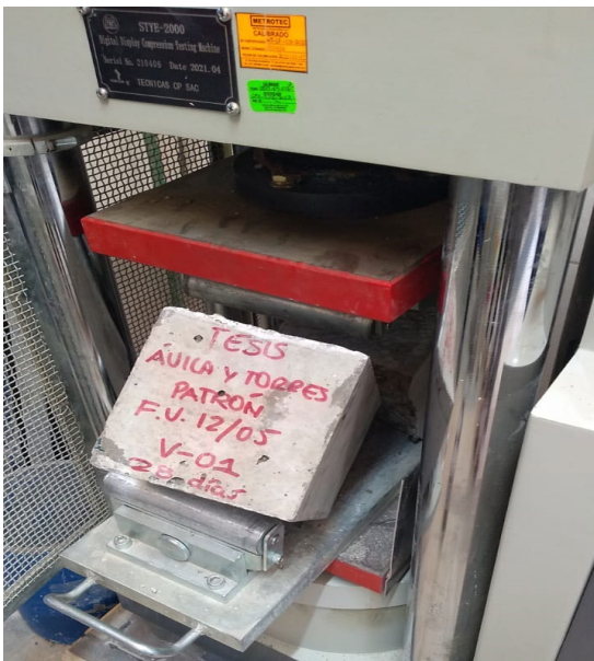
Fotografía N°11 Y 12: Ensayo de flexión en vigas
