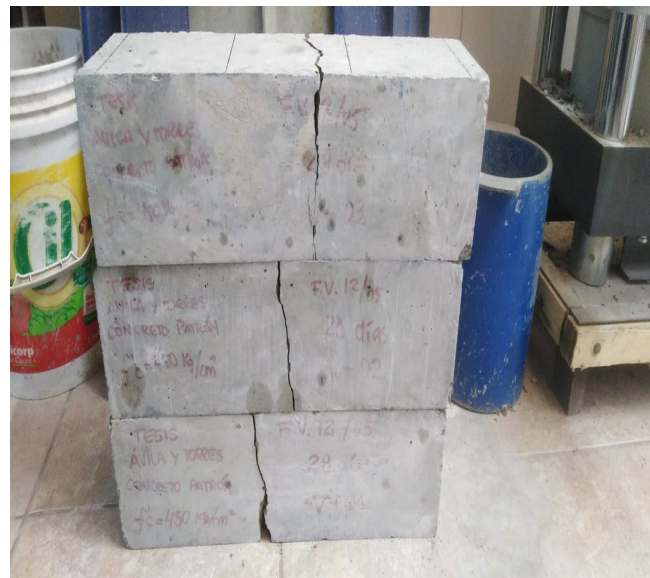
Fotografía N°11 Y 12: Ensayo de flexión en vigas
