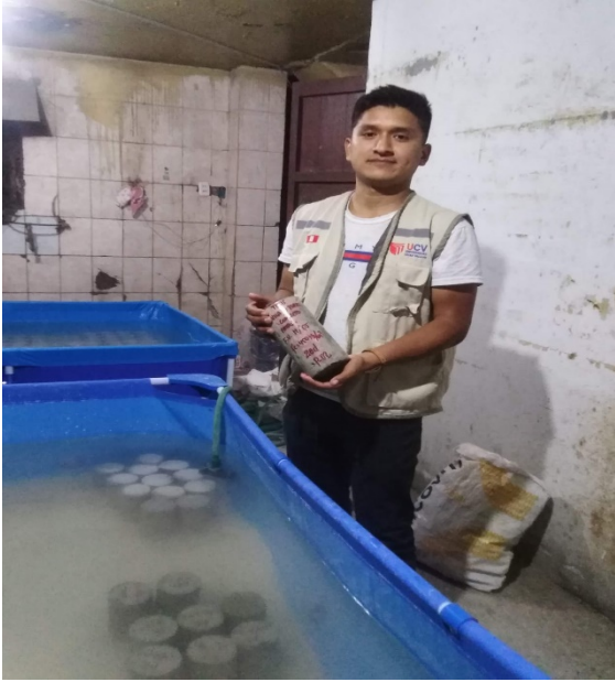
Fotografía N°09: Retiro de especímenes de cisterna de curado
