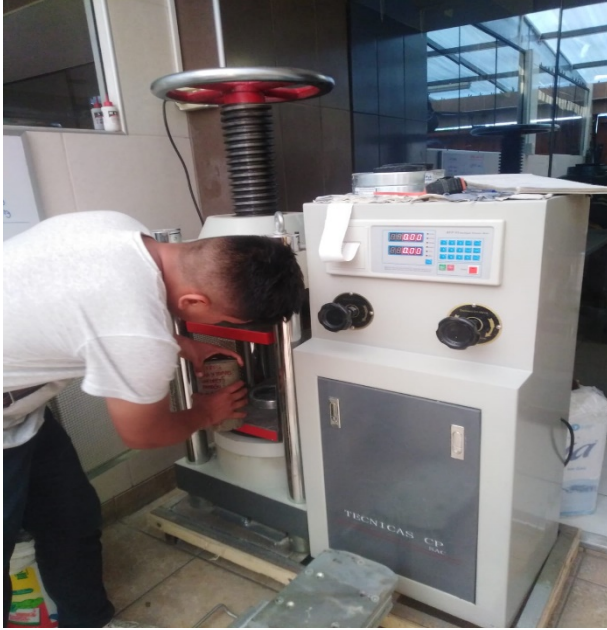
Fotografía N°13 Y 14: Ensayo de compresión del concreto + microfibras sintética de acuerdo a las dosificaciones a una edad de 1,3,7 y 28 días.
