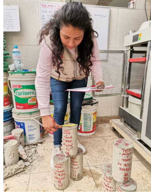
Fotografía N°10: Toma de medidas (diámetro) de las probetas cilíndricas
