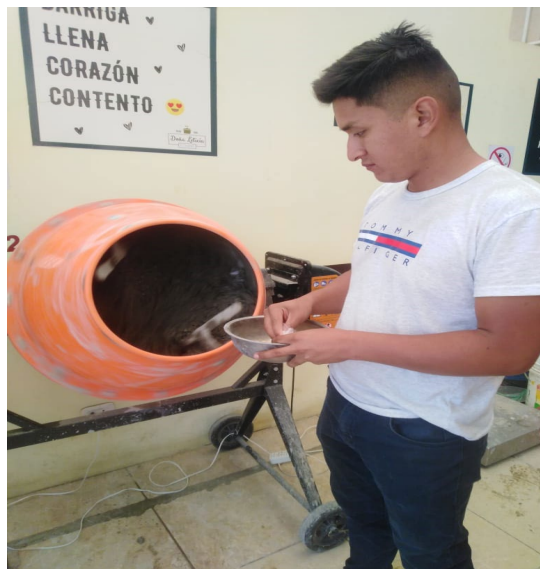
Fotografía N°06: Incorporación de microfibra sintética al concreto
