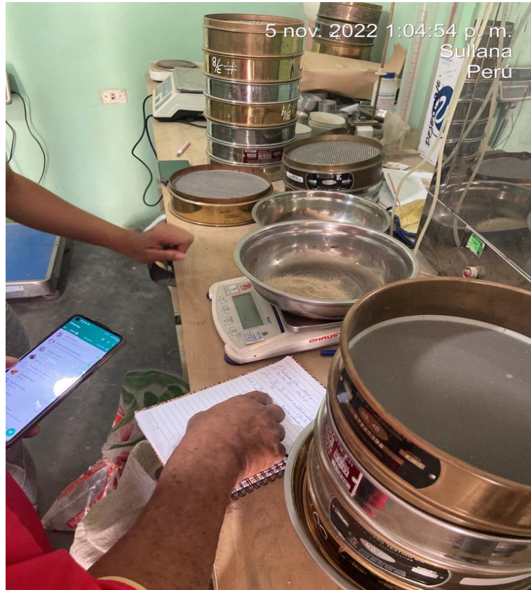
Identificando el peso lavado de nuestra muestra en el laboratorio de Mecánica de Suelos.
