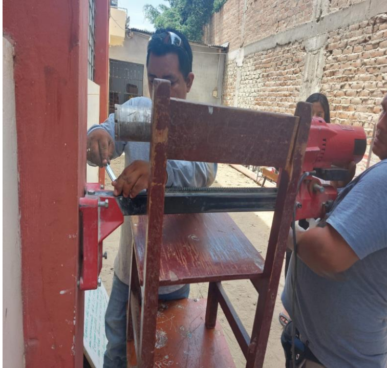
Máquina de ensayo de diamantina ya sujeta a la columna C1.
