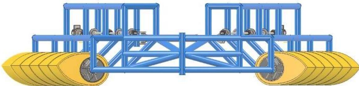
Nota. Vista frontal del modelo WEC. Se aprecia el tubo central de torsión.
