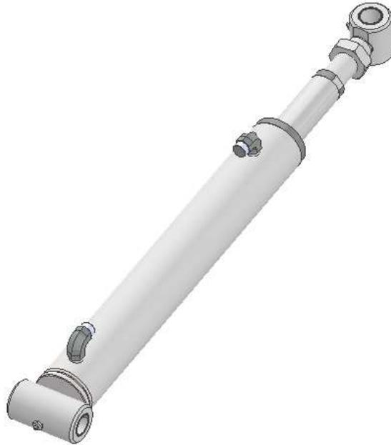
Nota: Modelo 3D del cilindro hidráulico usado en el desarrollo del WEC.
