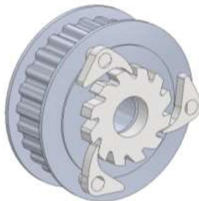
Nota: La forma del trinquete permite el movimiento de rotación solo en un sentido dada la presencia de los frenos.
