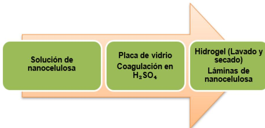
**Figura 9: Proceso de fabricación de las láminas de nanocelulosa**
