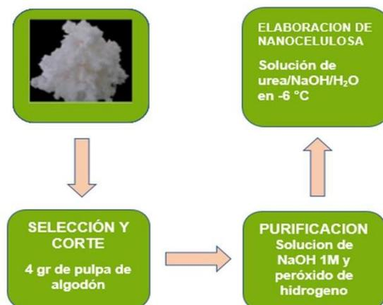
**Figura 8: Proceso de extracción de la nanocelulosa**
