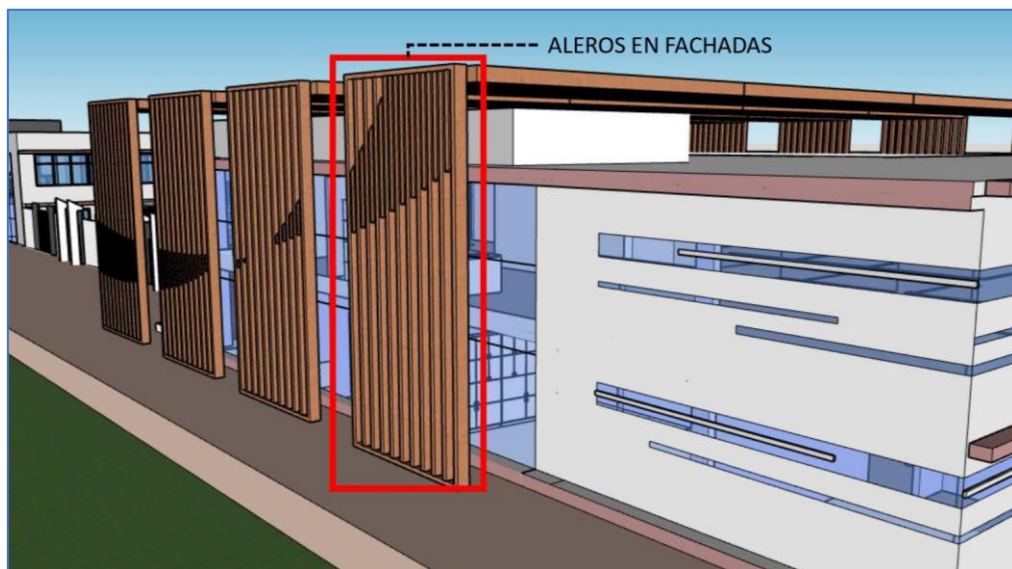
Figura 33. Aleros en fachadas
