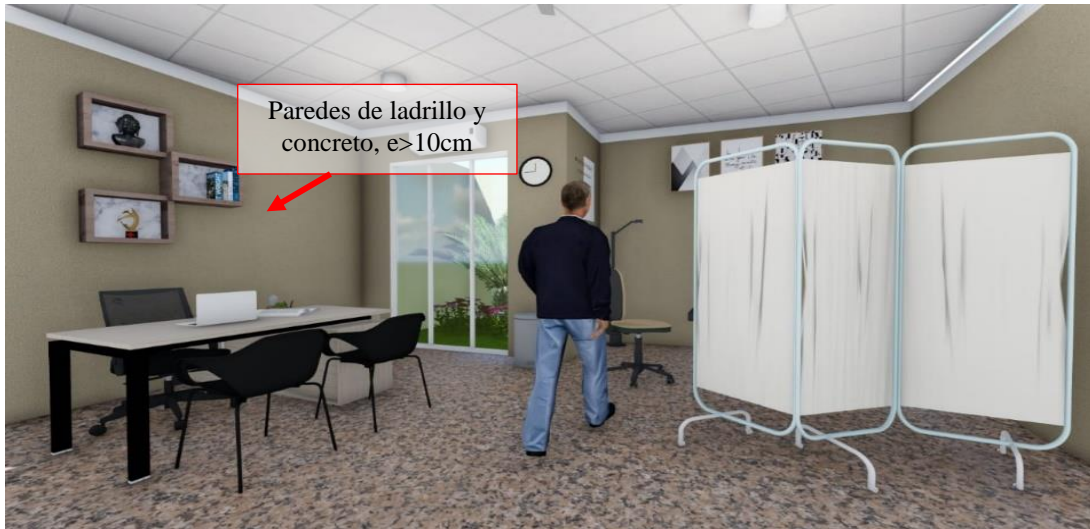
Figura 66. Almacenamiento de calor en los muros
