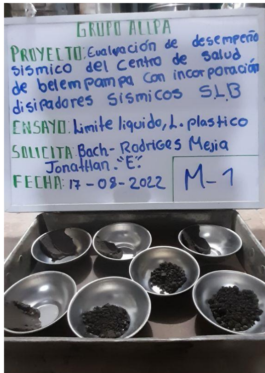
Figura. Ensayo de límites de consistencia para C-01 E-01
