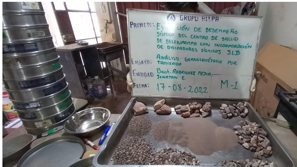
Figura. Ensayo de análisis granulométrico para C-01 E-01
