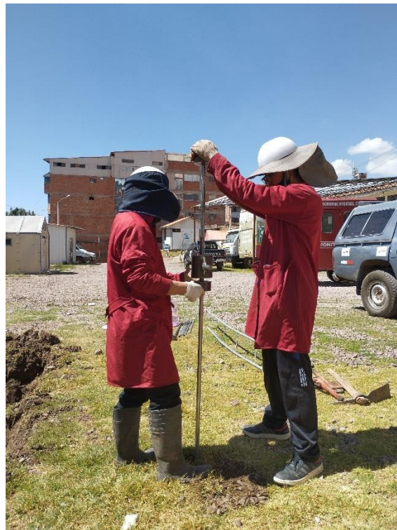
Figura. Ensayo de DPL
