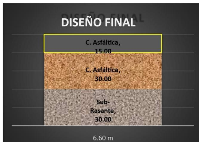
*Figura 8. Corte de sección de pavimento flexible.*
