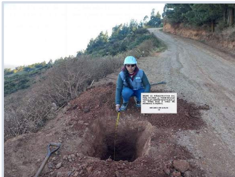
Figura 70. Estudio de mecánica de suelos del Diseño de infraestructura vial para mejorar la transitabilidad vehicular centros poblados Uyurpampa – Marayhuaca (0+000Km - 9+862Km) C8, setiembre 2022.
