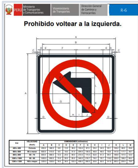
Figura 3. Señal vial “PROHIBIDO VOLTEAR A LA IZQUIERDA” extraída del Manual de dispositivos de tránsito – Ministerio de Transporte y Comunicaciones, lima, mayo de 2018.
