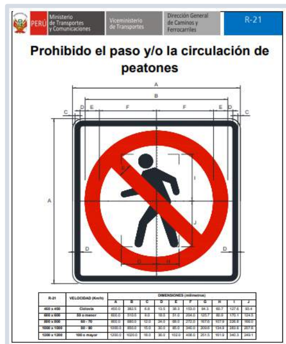
Figura 8. Señal vial “PROHIBIDO EL PASO Y/O LA CIRCULACIÓN DE PATONES” extraída del Manual de dispositivos de tránsito – Ministerio de Transporte y Comunicaciones, lima, mayo de 2018.
