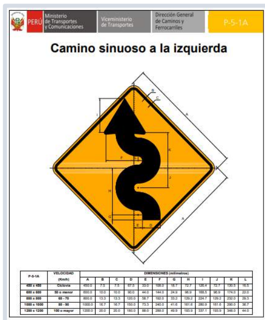
Figura 14. Señal vial “CAMINO SINUOSO A LA IZQUIERDA” extraída del Manual de dispositivos de tránsito – Ministerio de Transporte y Comunicaciones, lima, mayo de 2018.
