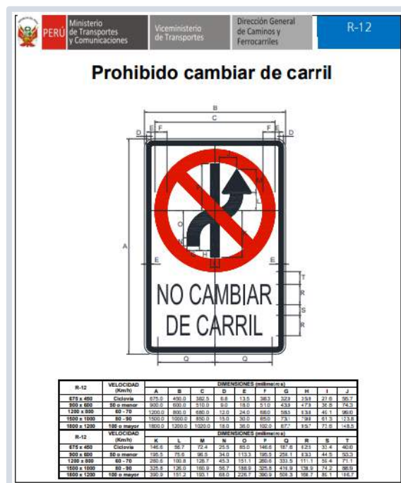
Figura 6. Señal vial "PROHIBIDO CAMBIAR DE CARRIL" extraída del Manual de dispositivos de tránsito – Ministerio de Transporte y Comunicaciones, lima, mayo de 2018.
