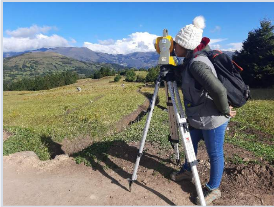
Figura .9. Tramo Uyurpampa – Marayhuaca estacionamiento de equipo por la tesista Florencia Caballero Pisfil, para ubicación del nuevo BM, setiembre 2022.
