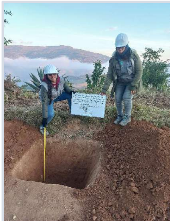
Figura 68. Estudio de mecánica de suelos del Diseño de infraestructura vial para mejorar la transitabilidad vehicular centros poblados Uyurpampa – Marayhuaca (0+000Km - 9+862Km) C6, setiembre 2022.
