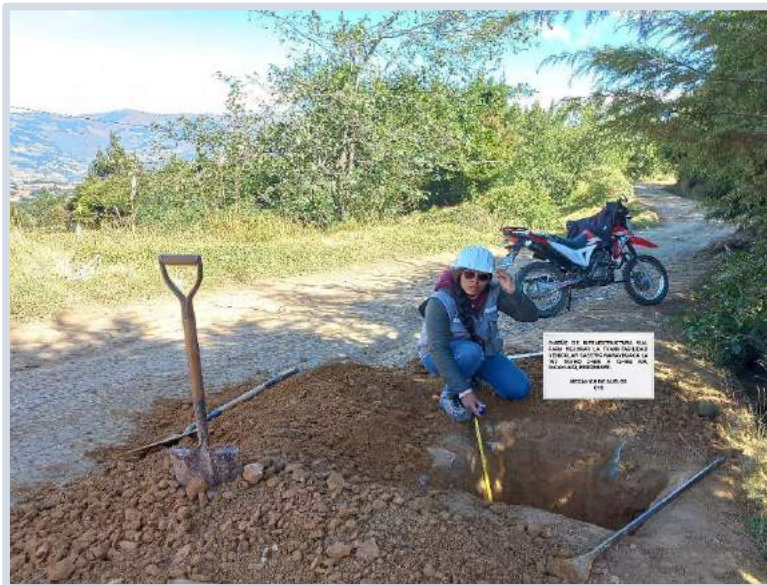
Figura 75. Estudio de mecánica de suelos del Diseño de infraestructura vial para mejorar la transitabilidad vehicular centros poblados Uyurpampa – Marayhuaca (0+000Km - 9+862Km) C13, setiembre 2022.
