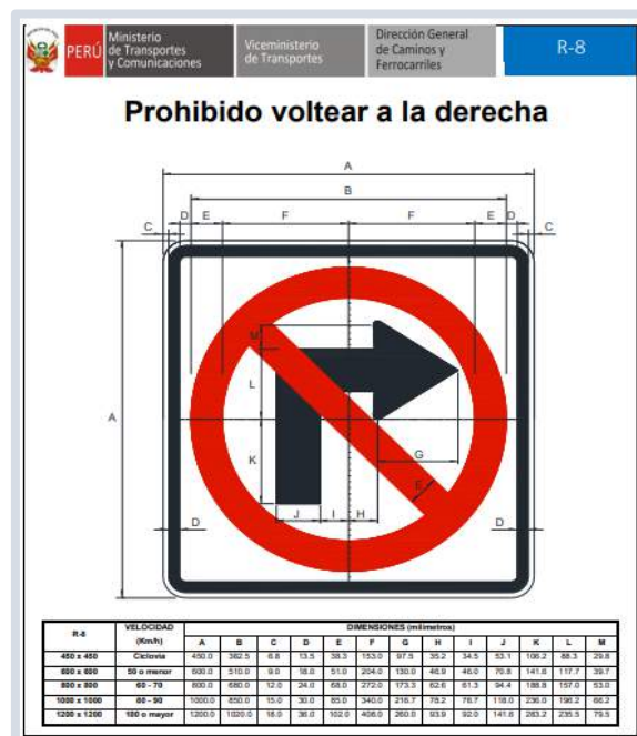
Figura 4. Señal vial “PROHIBIDO VOLTEAR A LA DERECHA” extraída del Manual de dispositivos de tránsito – Ministerio de Transporte y Comunicaciones, lima, mayo de 2018.
