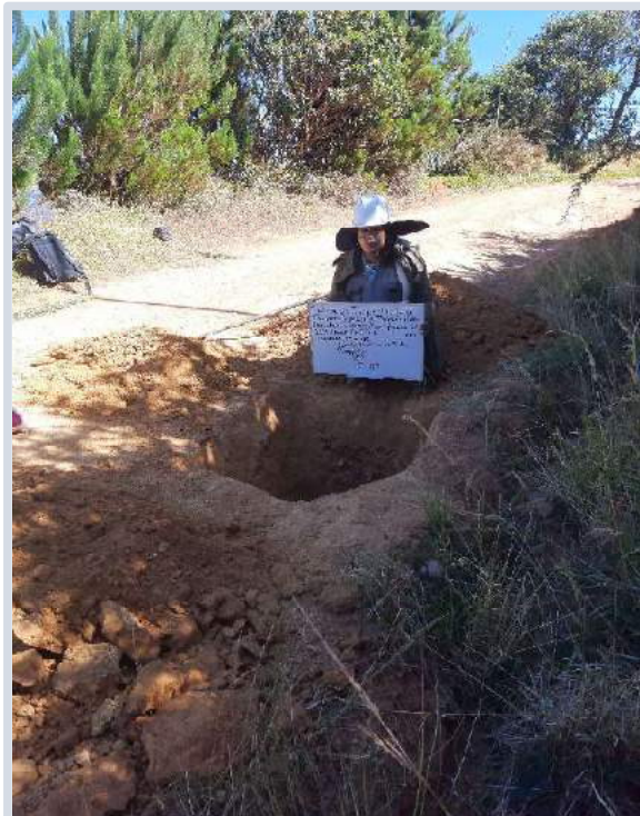
Figura 66. Estudio de mecánica de suelos del Diseño de infraestructura vial para mejorar la transitabilidad vehicular centros poblados Uyurpampa – Marayhuaca (0+000Km - 9+862Km) C4, setiembre 2022.
