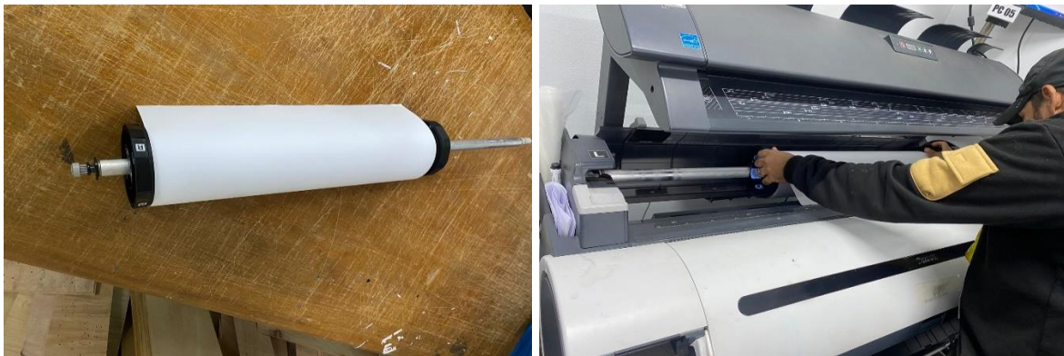
Figura 23. Instalacion del papel en la bobina de maquina plotter
