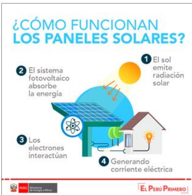
Figura 07.- Funcionamiento de un Sistema Fotovoltaico Fuente: Ministerio de Energía y Minas MINEM – Perú
