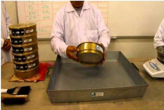
*Figura 3.* Procedimiento de tamizado
