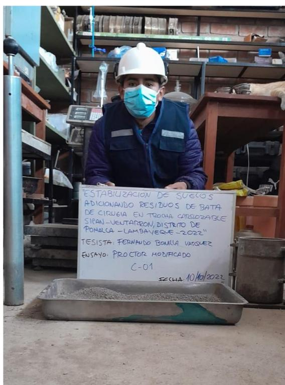
Figura 17. Ensayo de Proctor Modificado C-01
