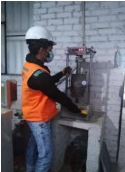
Figura 19. Prensa de ensayo de CBR
