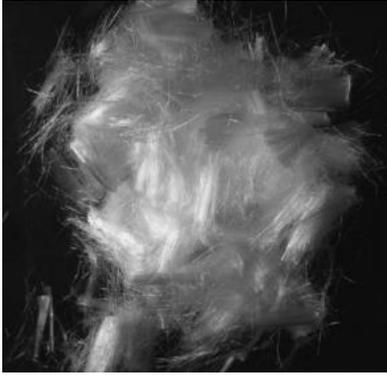
*Figura 1.* Fibras de polipropileno
