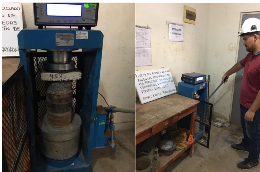
Figura 30. Ensayo de resistencia a la compresión a los 28 días de edad.
