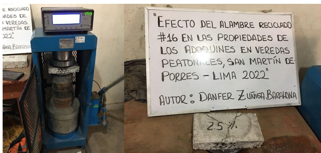
Figura 26. Ensayo de resistencia a la compresión a los 7 días de edad.
