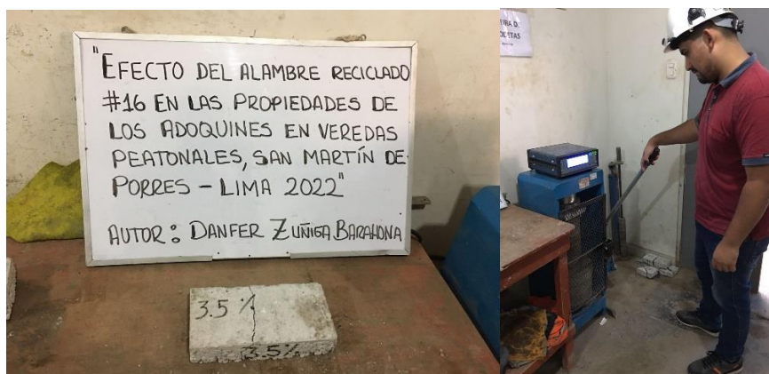
Figura 22. Ensayo de resistencia a la flexión a los 14 días de edad.
