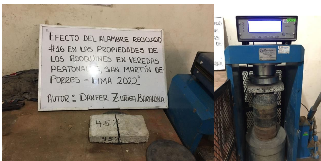
Figura 24. Ensayo de resistencia a la flexión a los 28 días de edad.
