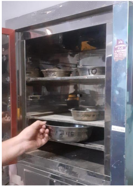
Horno para contenido de humedad
