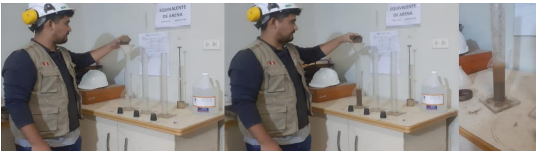
Figura 15. Ensayo del equivalente de arena del agregado fino.
