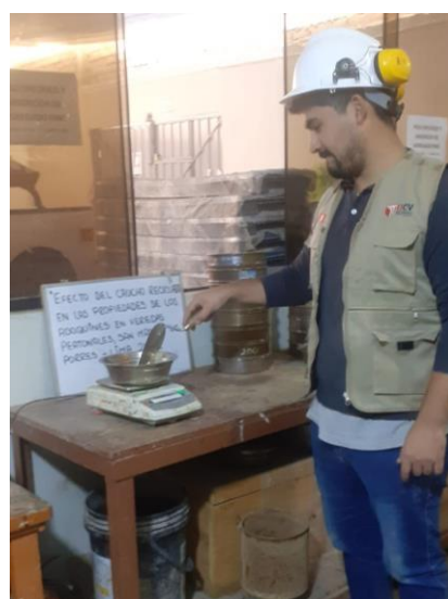
Pesaje del agregado grueso
