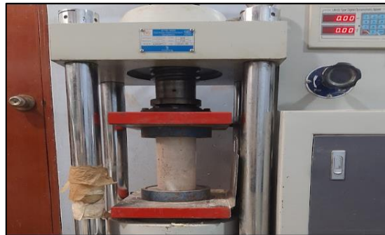
Figura 6. Ensayo de Rotura de Probetas – Patrón
