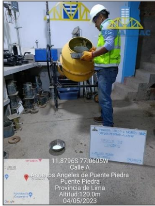
Figura 26. Vertimiento del cemento (1% de vidrio)
