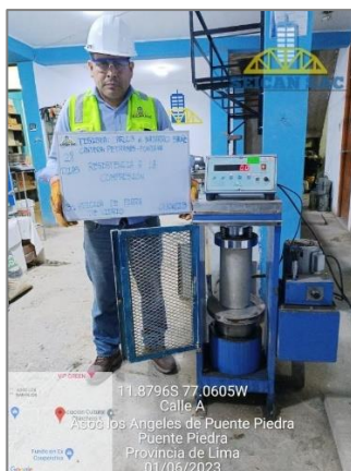
Figura 57. Rotura de probetas 6" x 12" a 28 días – NTP 339.034 / ASTM C 39 (3 % de vidrio)
