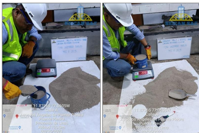
Figura 8. Ensayo de peso unitario suelto de agregado fino NTP 400.017
