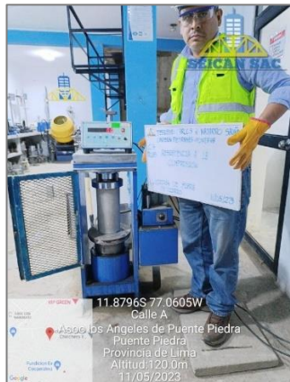
Figura 31. Rotura de probetas 6" x 12" a 7 días – NTP 339.034 / ASTM C 39 (1% de vidrio)
