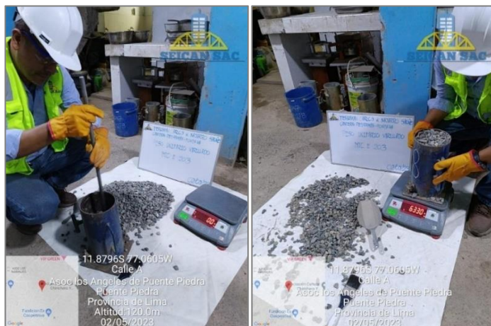
Figura 11. Ensayo de peso unitario compactado de agregado grueso NTP 400.017
