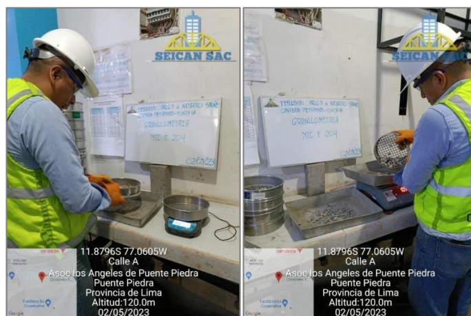
Figura 6 Ensayo de análisis granulométrico de agregado grueso NTP 400.012
