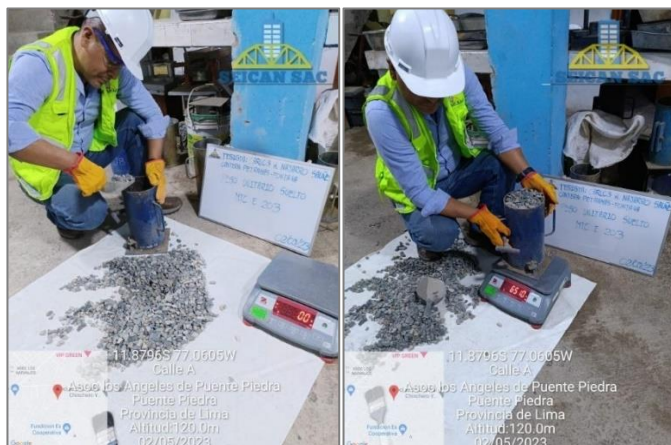
Figura 10. Ensayo de peso unitario suelto de agregado grueso NTP 400.01
