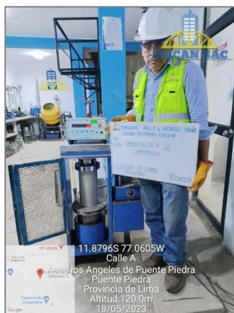
Figura 32. Rotura de probetas 6" x 12" a 14 días – NTP 339.034 / ASTM C 39 (1% de vidrio)
