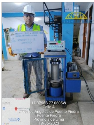
Figura 56. Rotura de probetas 6" x 12" a 14 días – NTP 339.034 / ASTM C 39 (3 % de vidrio)
