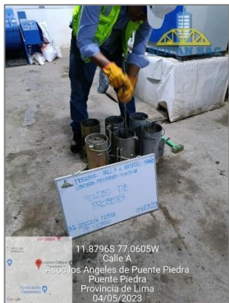
Figura 54. Probetas cilíndricas 6"x12"- NTP 339.033/ASTM C31 (3 % de vidrio)
