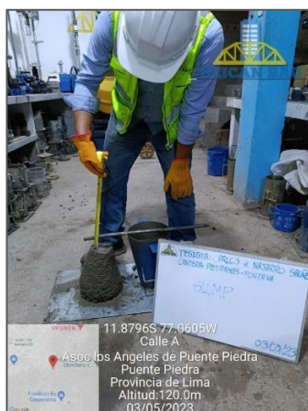
Figura 16. Asentamiento del concreto convencional (Slum) – NTP 339.035 / ASTM C143
