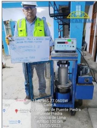
Figura 55. Rotura de probetas 6" x 12" a 7 días – NTP 339.034 / ASTM C 39 (3 % de vidrio)
