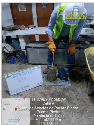
Figura 52. Asentamiento de concreto NTP 339.035 / ASTM C143 (3 % de vidrio)
