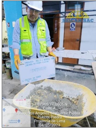
Figura 29. Temperatura del concreto - NTP 339.184/ASTM C1064 (1% de vidrio)
