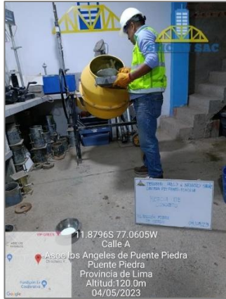
Figura 50. Vertimiento del cemento (3 % de vidrio)
