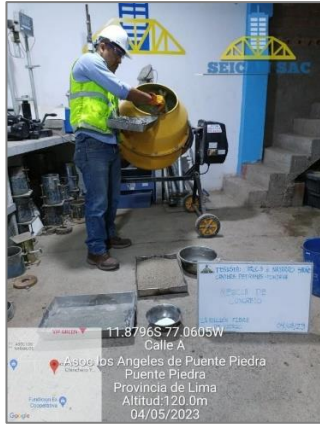
Figura 35. Vertimiento de arena (2% de vidrio)
