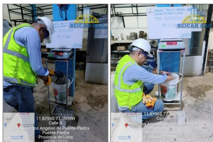
Figura 12. Ensayo de peso específico de agregado grueso NTP 400.021
