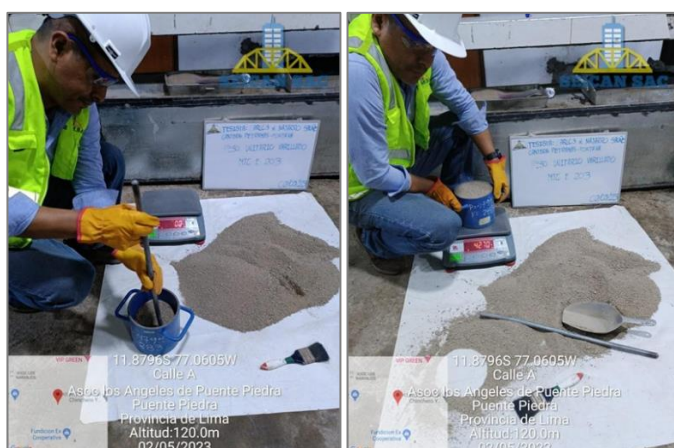
Figura 9. Ensayo de peso unitario compactado de agregado fino NTP 400.017
