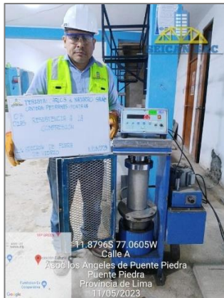
Figura 43. Rotura de probetas 6" x 12" a 7 días – NTP 339.034 / ASTM C 39 (2 % de vidrio)
