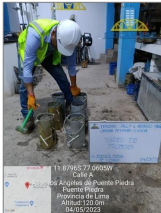
Figura 30. Probetas cilíndricas 6"x12"- NTP 339.033/ASTM C31 (1% de vidrio)
