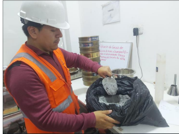
Fotografía 8. Granulometría de la ceniza de cascara de nuez
