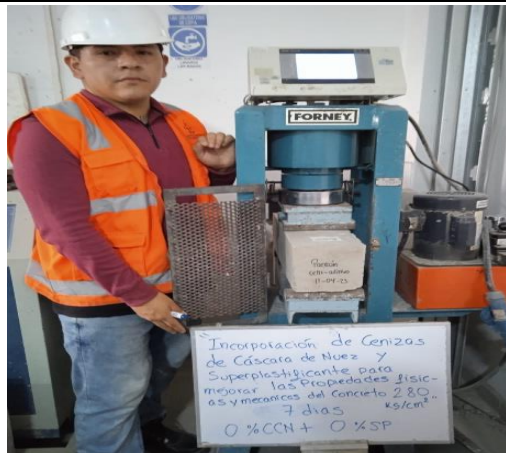
Fotografía 21. Ensayo a flexión del concreto patrón (7 días)
