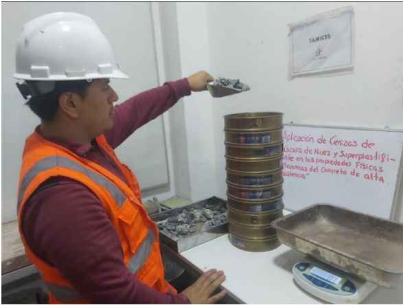
Fotografía 7. Granulometría de los agregados
