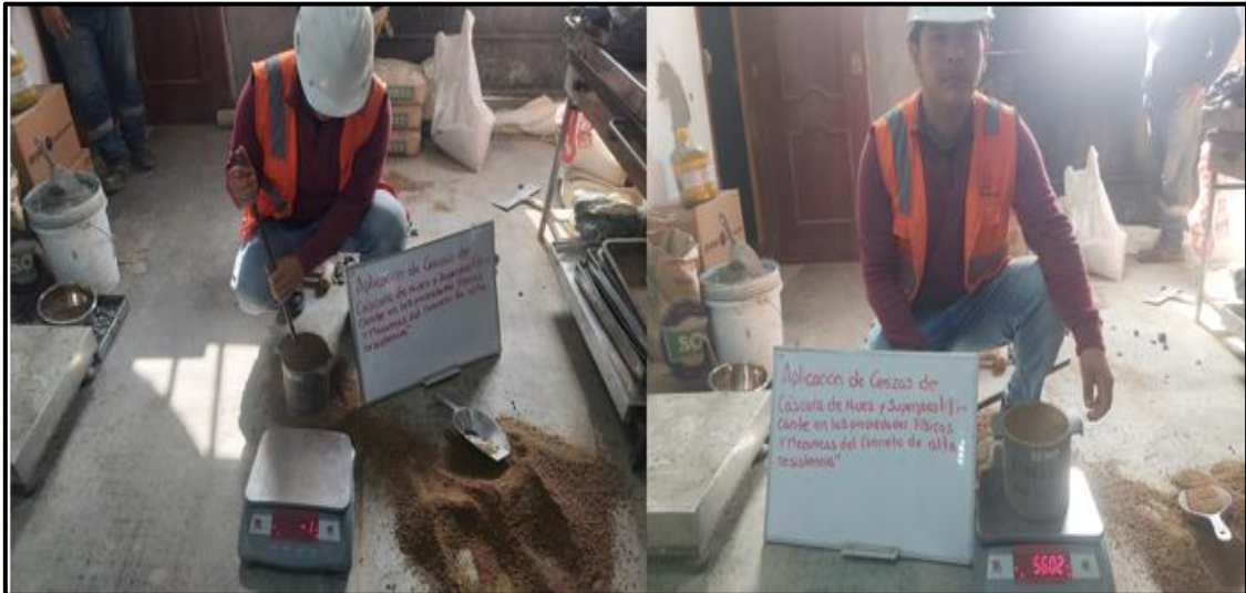
Figura 17. Ensayo de peso unitario compactado del agregado fino Fuente: Propia
