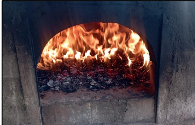
Figura 5. Proceso de calcinación de la cascara de nuez Fuente: Propia
