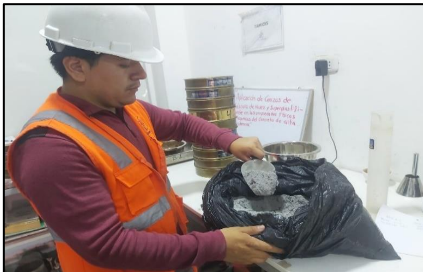
Figura 12. Tamizado de la ceniza de cascara de nuez Fuente: Propia
