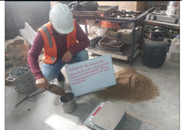
Fotografía 6. Peso unitario suelto del agregado fino
