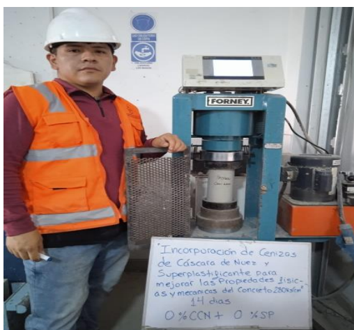
Fotografía 23. Ensayo de compresión concreto patrón (14 días)
