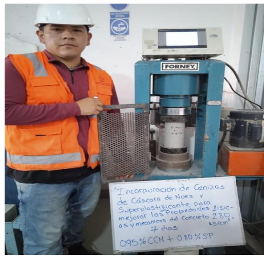
Fotografía 20. Ensayo de compresión concreto experimental (7 días)
