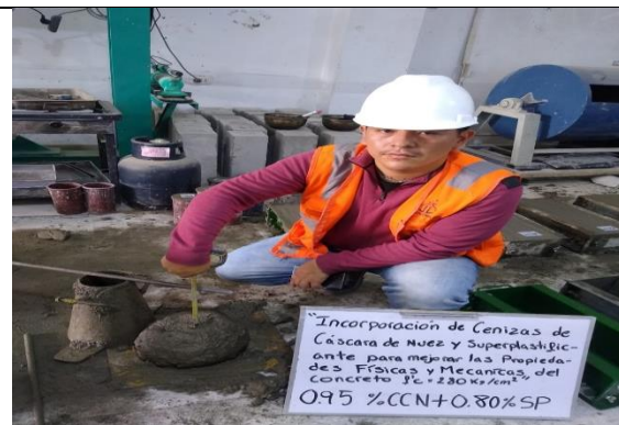
Fotografía 18. Asentamiento del concreto experimental.
