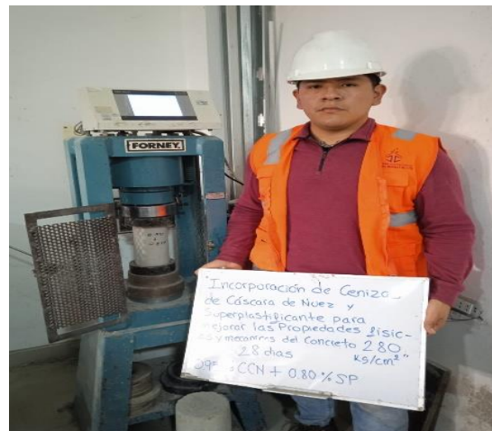
Fotografía 10. Ensayo de compresión concreto experimental (28 días)
