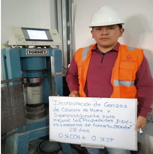
Fotografía 27. Ensayo de compresión concreto patrón (28 días)
