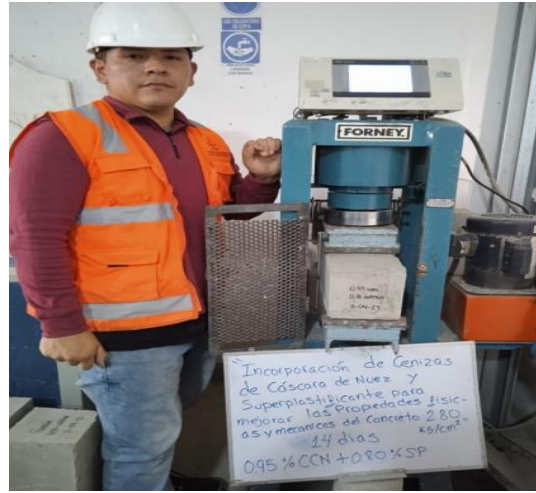
Fotografía 26. Ensayo a flexión del concreto experimental (14 días)
