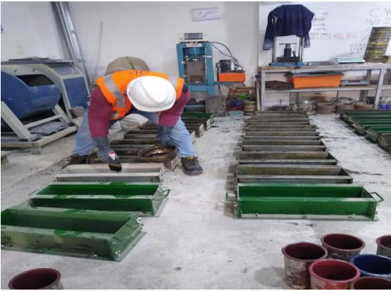
Fotografía 13. Limpieza de los moldes de vigas
