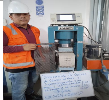
Fotografía 20. Ensayo de compresión concreto experimental (7 días)
