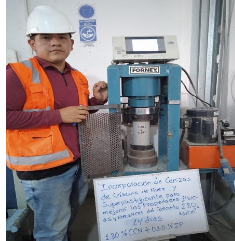
Fotografía 24. Ensayo de compresión concreto experimental (14 días)
