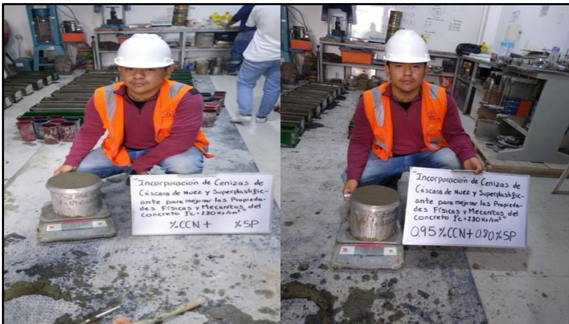
Figura 23. Ensayo del peso unitario del concreto Fuente: Propia
