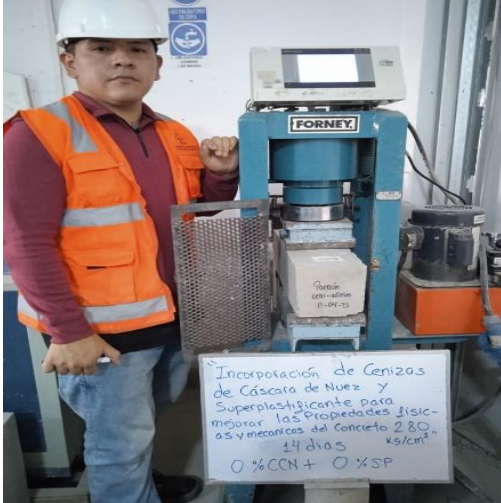
Fotografía 25. Ensayo a flexión del concreto patrón (14 días)
