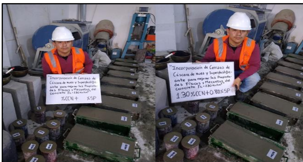
Figura 24. Vaciado de concreto de vigas y probetas Fuente: Propia
