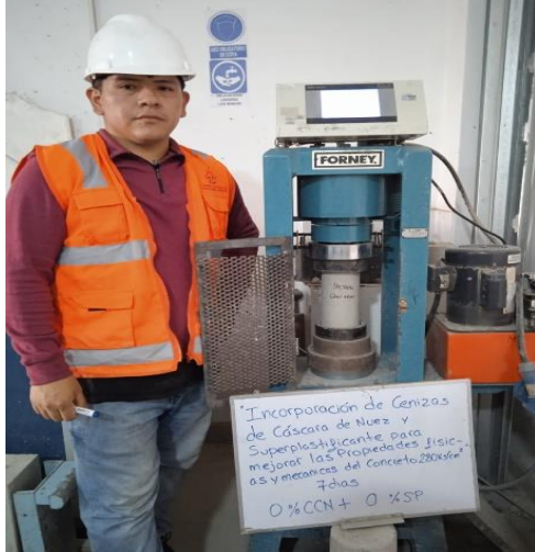
Fotografía 19. Ensayo de compresión concreto patrón (7 días)
