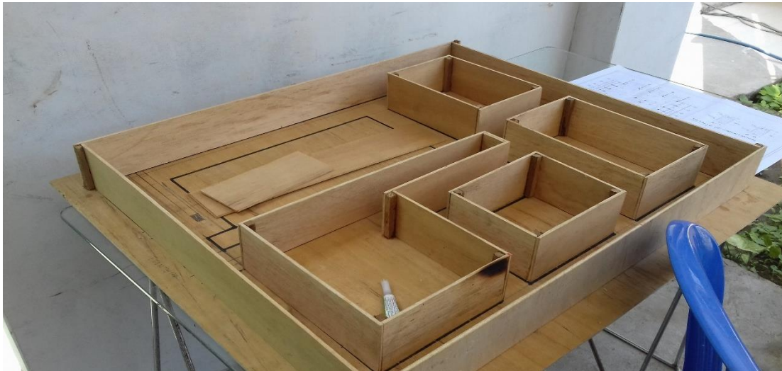
Figura N°4 El encofrado de la cimentación se realizó a una escala de 1/10 teniendo una sección de 5 cm de ancho y 8 cm de alto
