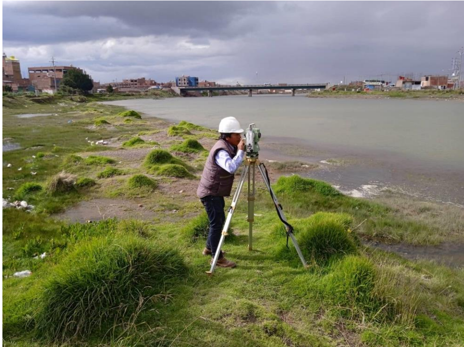
Figura 7: Levantamiento topográfico con estación total.
