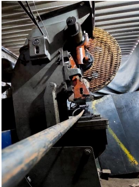
Figura 18: Vista lateral de ensamble de matriz para corte de pines
