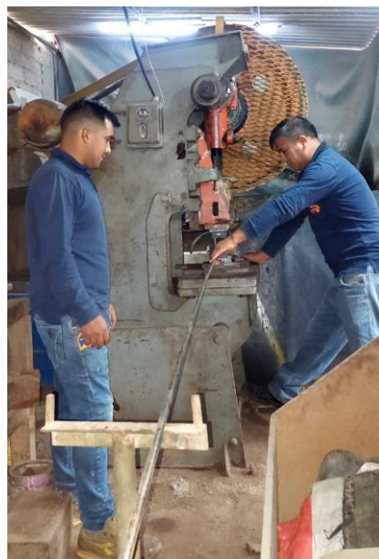
Figura 22: : Capacitación brindada de funcionamiento de matriz de corte de pines - operario
