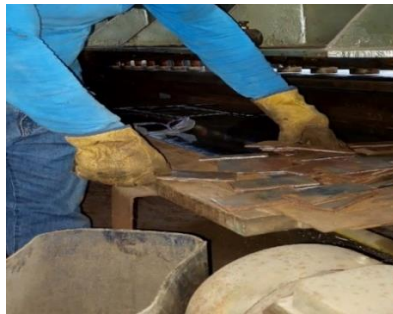
Figura 11: Llenado de láminas para la elaboración de las bisagras 3/8"x 4" x 2alas x 1.9mm
