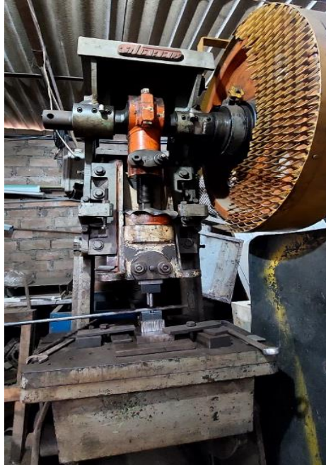
Figura 19: Vista frontal de ensamblaje de matriz para corte de pines
