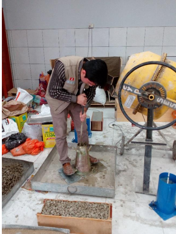
Imagen N° 3: Varillado de concreto para ensayo de Slump.
