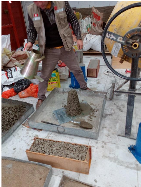
Imagen N° 4: Ensayo Slump para determinar revenimiento del concreto permeable.
