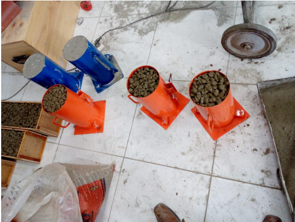
Imagen N° 5: Elaboración de testigos cilíndricos de concreto permeable.
