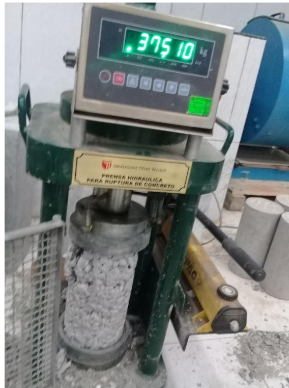
Imagen N° 7: Ensayo de resistencia a la compresión de testigos cilíndricos de concreto permeable.
