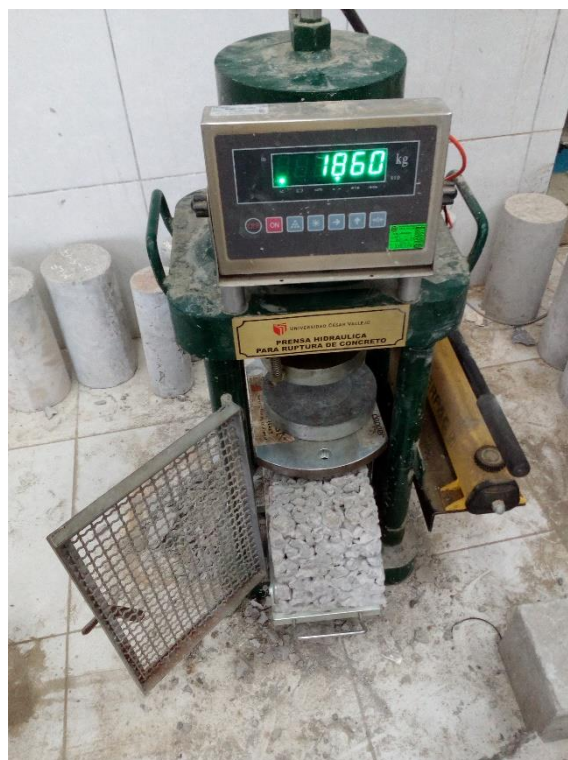
Imagen N° 8: Ensayo de resistencia a la flexión de vigas probetas de concreto permeable.
