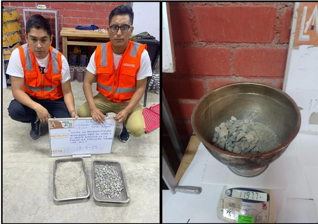
Foto 13. Agregado grueso y fino para ensayo Marshall.
