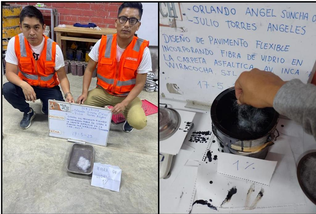
Foto 15. Adición de la fibra de vidrio al 1% en el cemento asfáltico.
