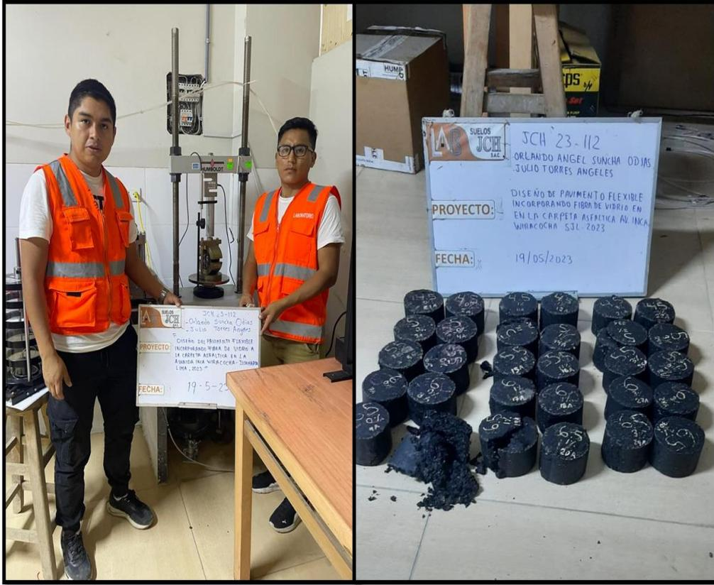
Foto 21. Rotura de las briquetas por la prensa Marshall
