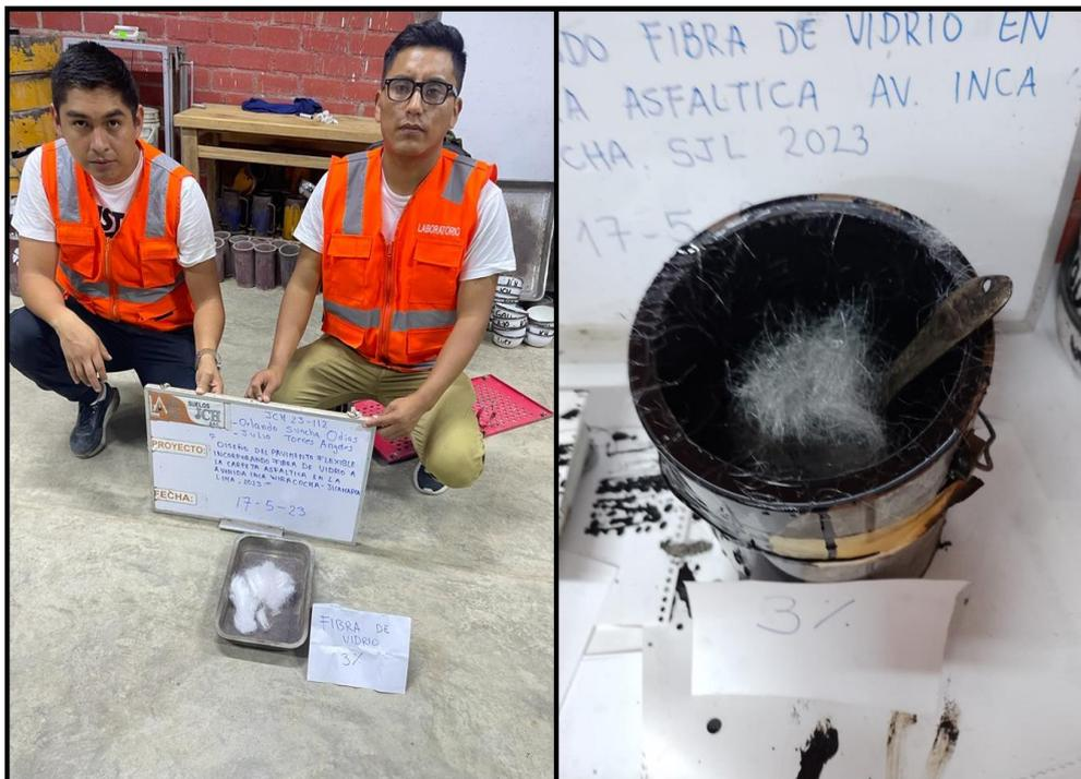
Foto 16. Adición de la fibra de vidrio al 3% en el cemento asfáltico.
