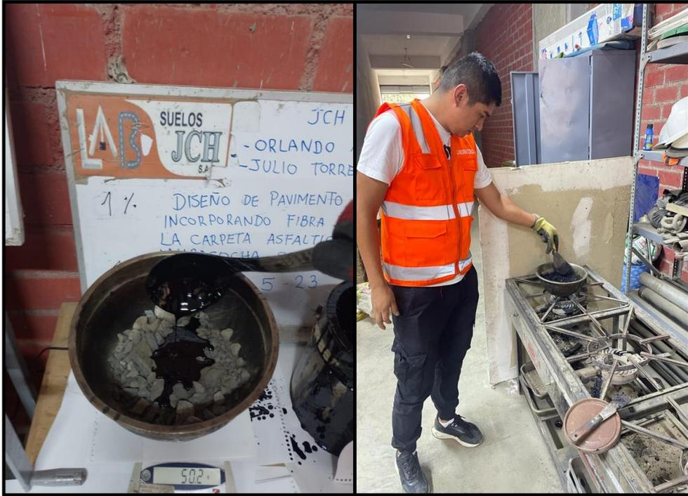
Foto 17. Mezcla calentando la muestra a 140°
