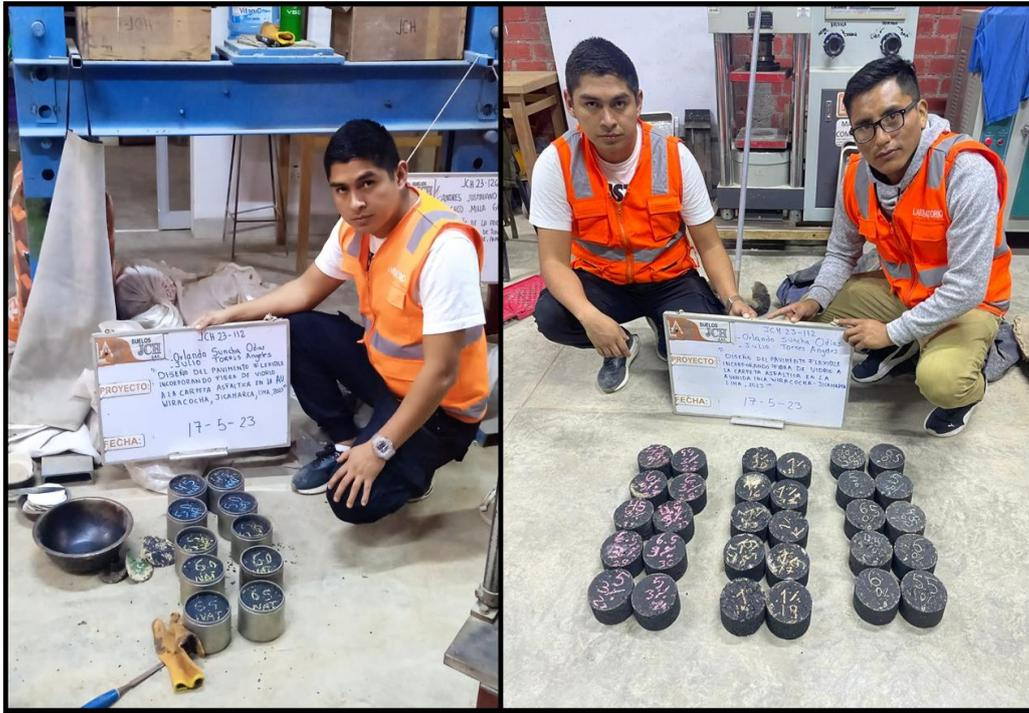
Foto 19. Desmolde de briquetas
