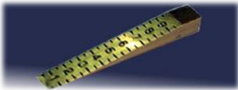
FIGURA 1: CUÑA PARA MEDIR EL ALABEO
