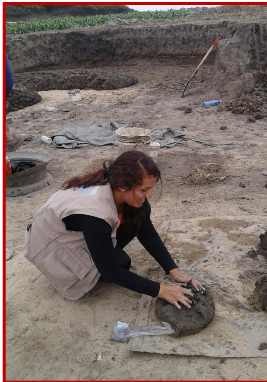
Fotografía 06: Tesista Nayaret Rojas Poémape, amasando la mezcla del ladrillo junto con la escoria de horno eléctrico según sus porcentajes.
