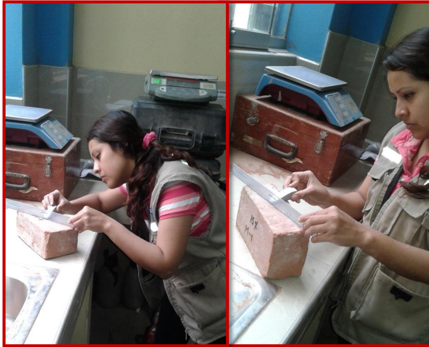
Fotografía 27: Tesista Nayaret Rojas Poémape realizando el ensayo de alabeo en las caras del ladrillo con ayuda de una cuña metálica graduada al milímetro y una regla de 30cm
