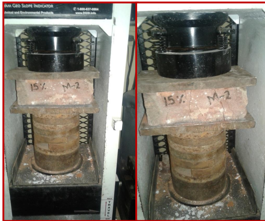
Fotografía 18: Muestra del ladrillo con el 15% de escoria de horno eléctrico antes y después de haber sido sometido a fuerza de compresión
