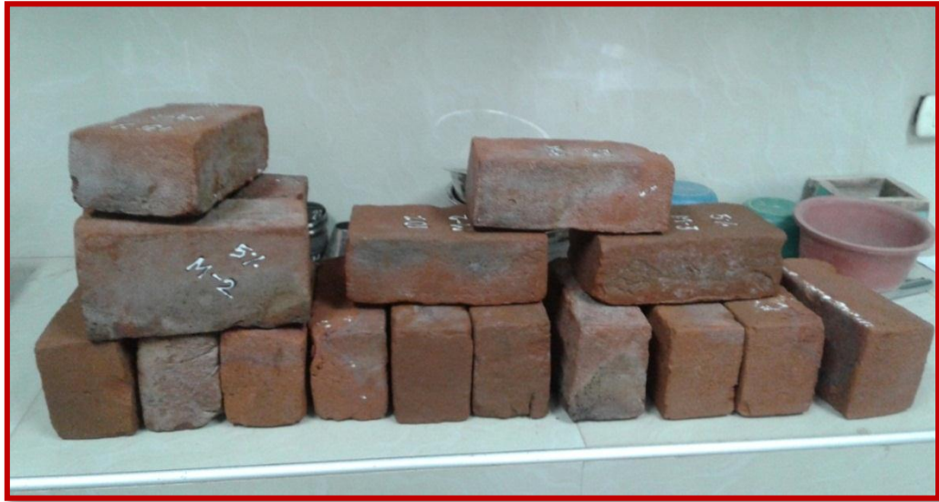
Fotografía 25: Unidades de albañilería secadas superficialmente con un trapo y listas para pesarlas
