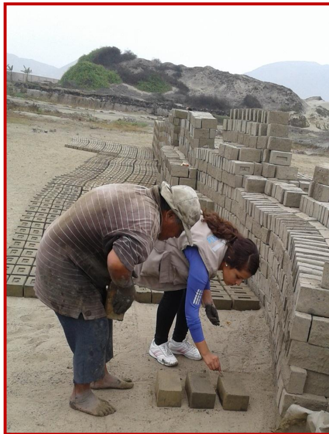
Fotografía 08: Desmolde de ladrillos en los tendales para su respectivo secado
