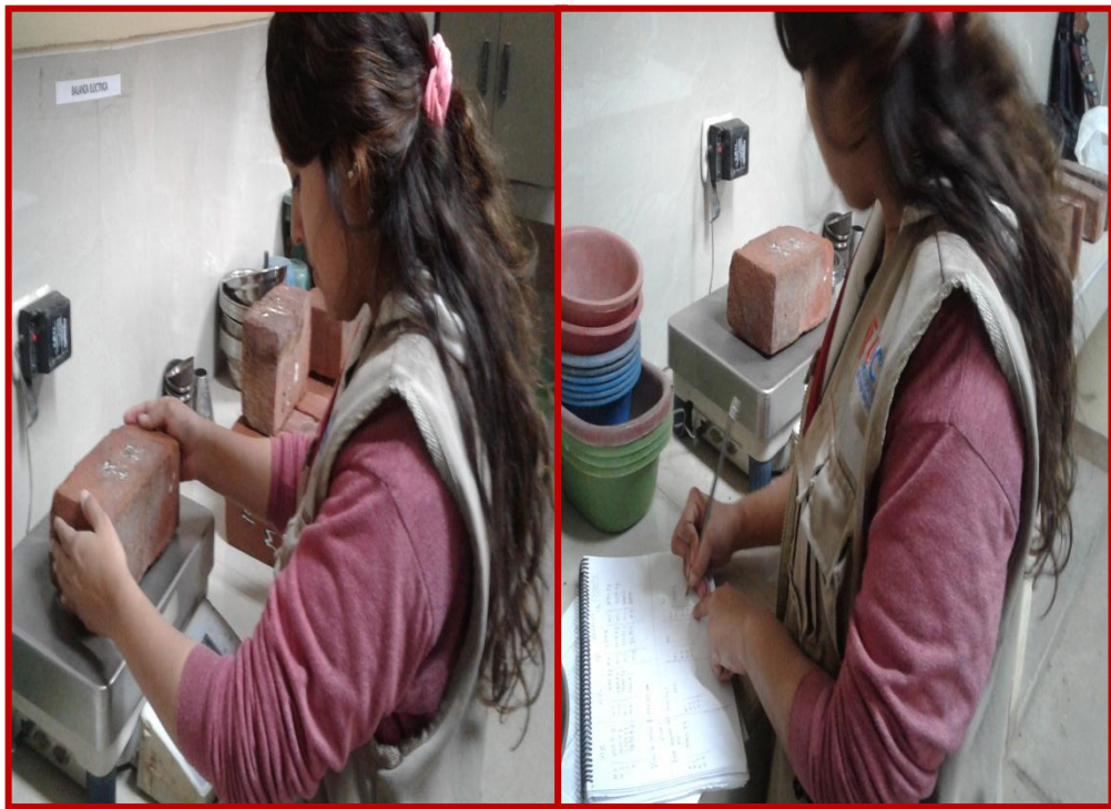
Fotografía 26: Tesista Nayaret Rojas Poémape, pesando y anotando los resultados de cada uno de los ladrillos después de haber sido sumergidos por 24 horas en agua.
