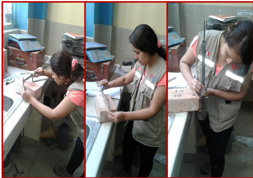
Fotografía 20: Tesista Nayaret Rojas Poémape, utilizando el vernier para realizar el ensayo de Variabilidad Dimensional de cada muestra del ladrillo patrón y del ladrillo con el 5%, 10% y 15% de escoria
