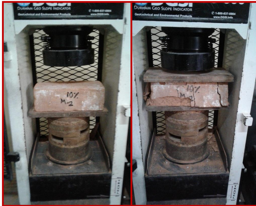
Fotografía 17: Muestra del ladrillo con el 10% de escoria de horno eléctrico antes y después de haber sido sometido a fuerza de compresión
