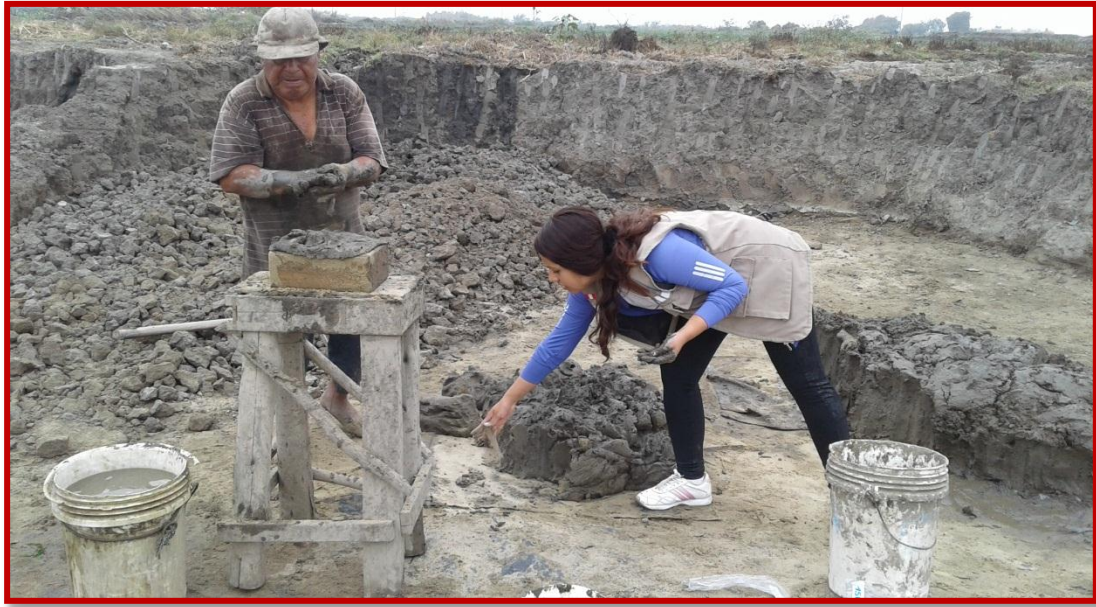
Fotografía 07: Colocando la mezcla del ladrillo en la gavero de un solo golpe
