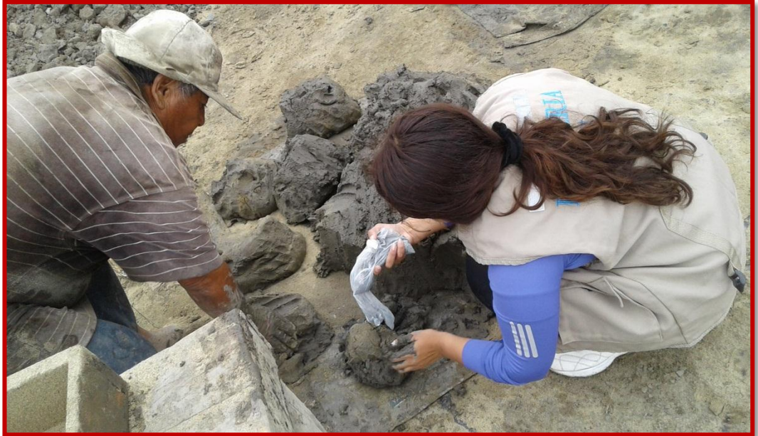
Fotografía 05: Tesista Nayaret Rojas Poémape, adicionando los porcentajes de escoria de horno eléctrico en la mezcla de cada ladrillo.
