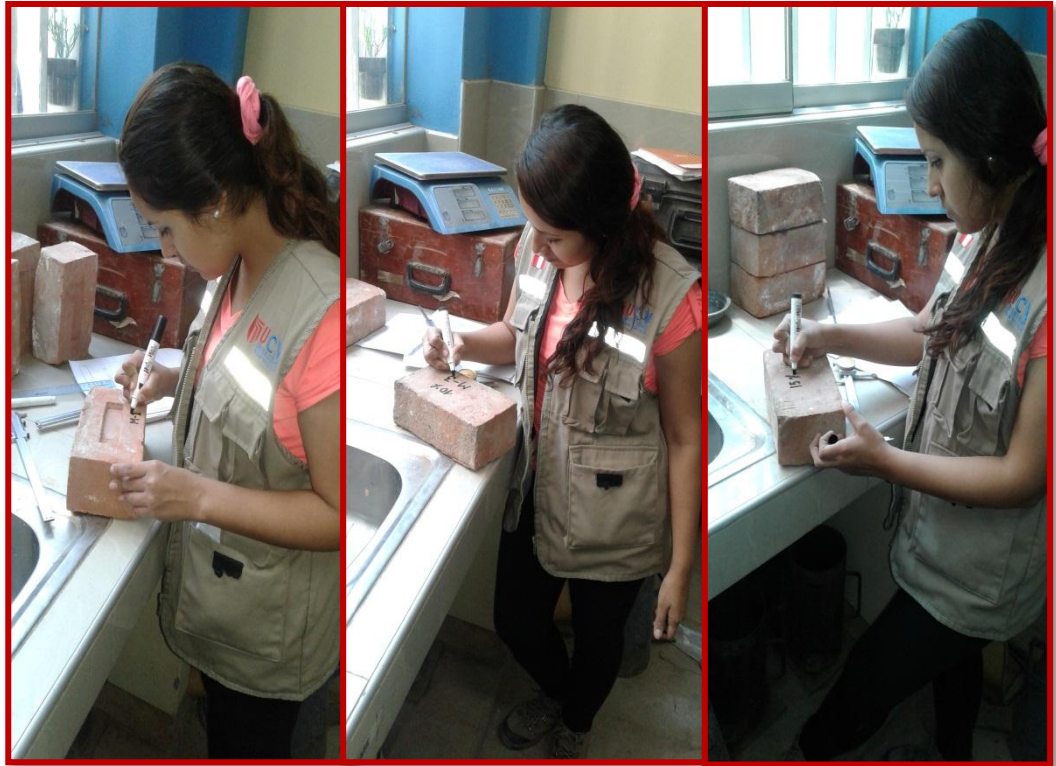
Fotografía 19: Tesista Nayaret Rojas Poémape, marcando las muestras del ladrillo patrón y del ladrillo con el 5%, 10% y 15% de escoria para realizar el ensayo de Variabilidad Dimensional
