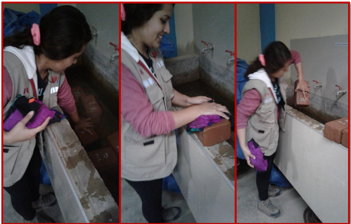
Fotografía 24: Tesista Nayaret Rojas Poémape, sacando del lavatorio los ladrillos después de haberlos sumergido en agua durante 24 horas, luego se procedió a secarlos superficialmente con un trapo
