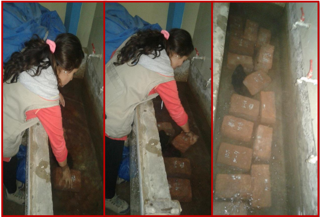
Fotografía 23: Tesista Nayaret Rojas Poémape, sumergiendo en agua durante 24 horas a los ladrillos con adición de porcentaje para el ensayo de absorción
