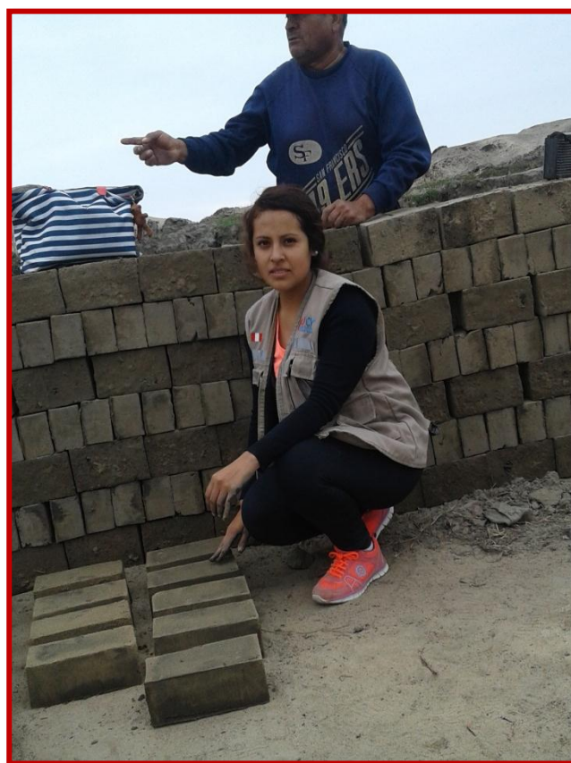
Fotografía 10: Tesista Nayaret Rojas Poémape mostrando los ladrillos realizados, colocados en los tendales para su respectivo secado
