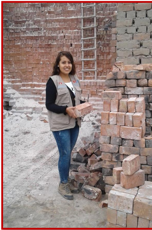
Fotografía 13: Tesista Nayaret Rojas Poémape mostrando los ladrillos realizados con escoria de horno eléctrico, después de su cocción
