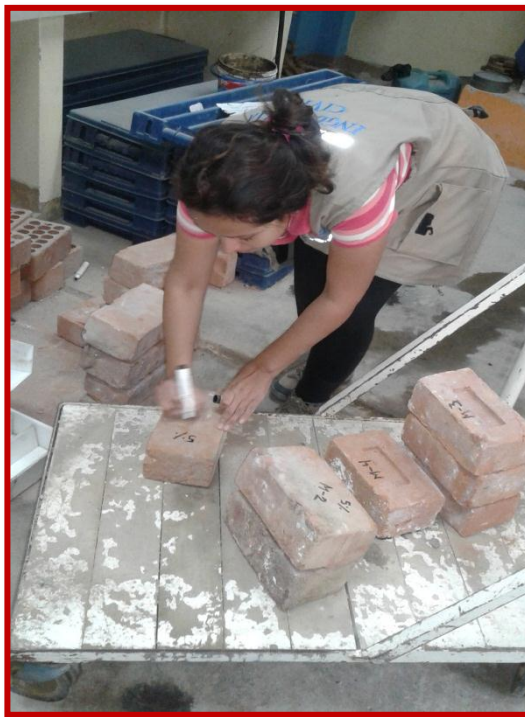
Fotografía 14: Tesista Nayaret Rojas Poémape, seleccionando y marcando cada ladrillo con su porcentaje de adición para su respectivo ensayo
