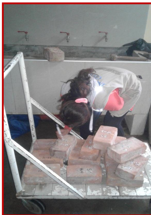
Fotografía 21: Unidades de albañilería marcadas de acuerdo a sus porcentajes de adición, para realizar el ensayo de absorción
