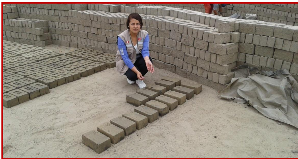
Fotografía 09: Tesista Nayaret Rojas Poémape mostrando los ladrillos realizados, colocados en los tendales para su respectivo secado
