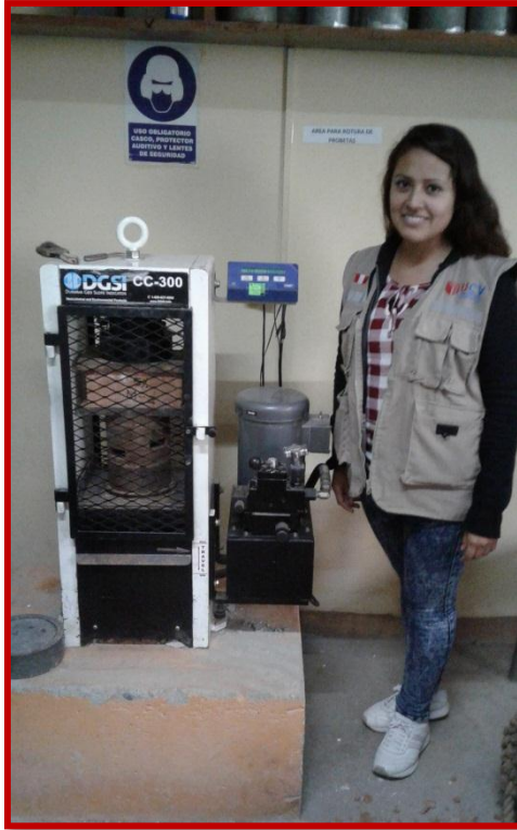
Fotografía 15: Tesista Nayaret Rojas Poémape, realizando el ensayo de Resistencia a la Compresión del ladrillo
