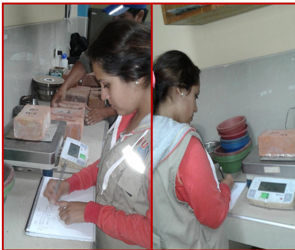
Fotografía 22: Tesista Nayaret Rojas Poémape, pesando las muestras antes de ser sumergidas en agua
