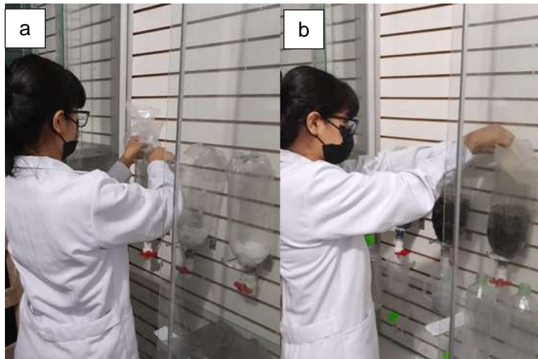
Figura 11. Implementación de los biofiltros con las dosis de componentes respectivas: a) Incorporación de los componentes , b) Incorporación del agua a tratar .
