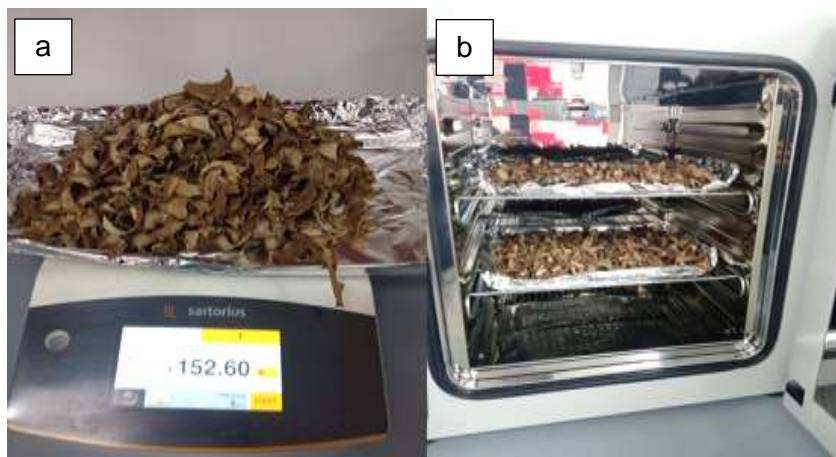
Figura 3. Pesaje y colocación en estufa BINDER de las cáscaras secas de papa: a) Pesaje de las cáscaras secas de papa , b) Cáscaras secas de papa en estufa BINDER.
