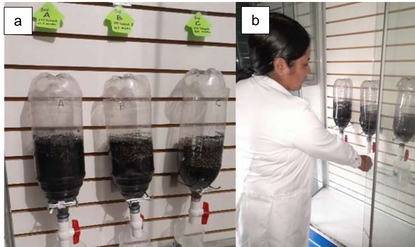
Figura 12. Muestreo de aguas post tratamiento: a) Biofiltros rotulados , b) Recolección de las muestras post tratamiento.
