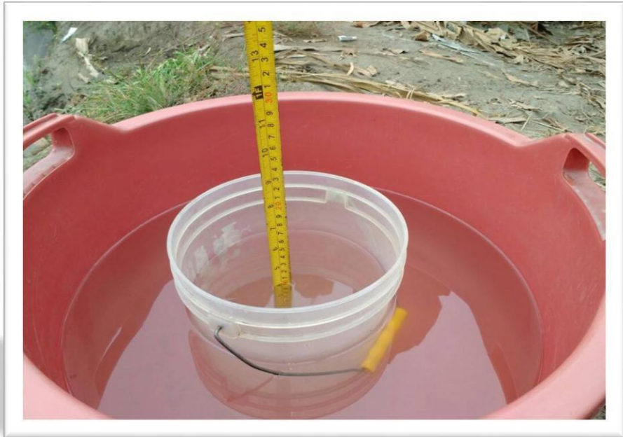
Foto N° 6: Vista del Infiltrómetro de 2 anillos con la guincha.
