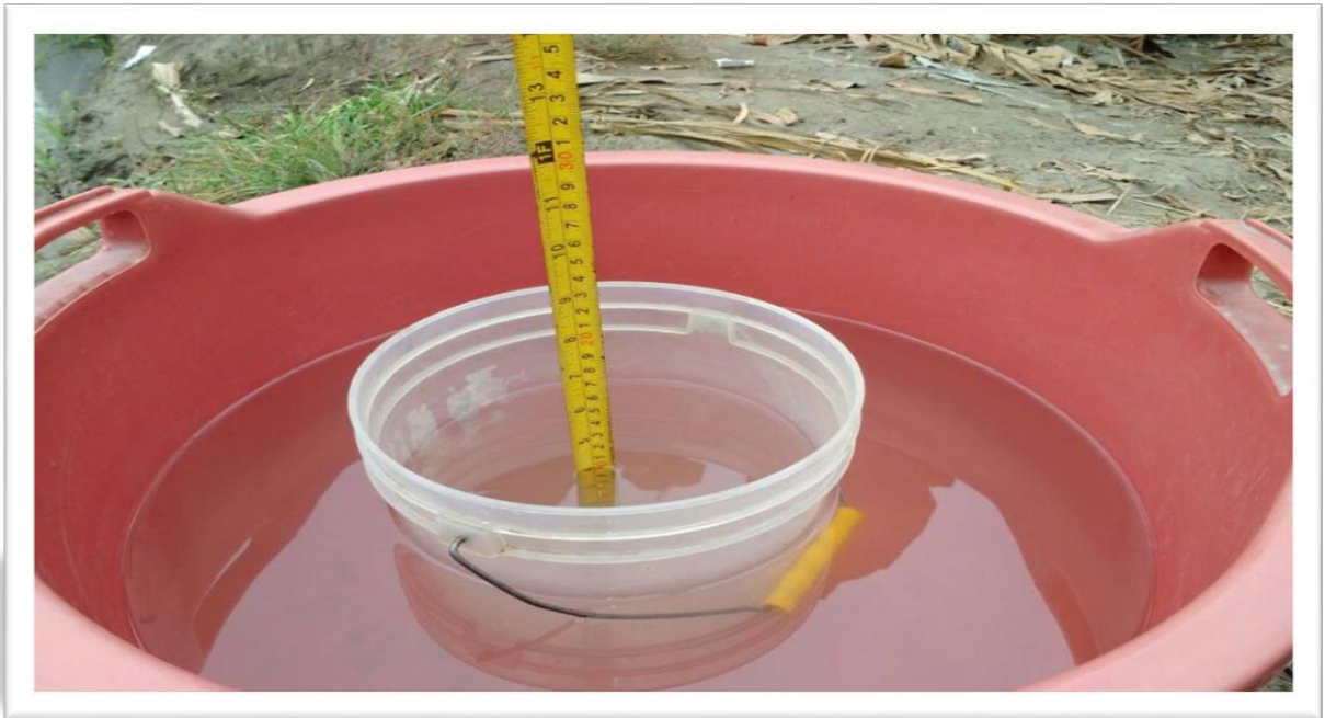
Foto N° 4: Vista del Infiltrómetro de 2 anillos con la guincha.
