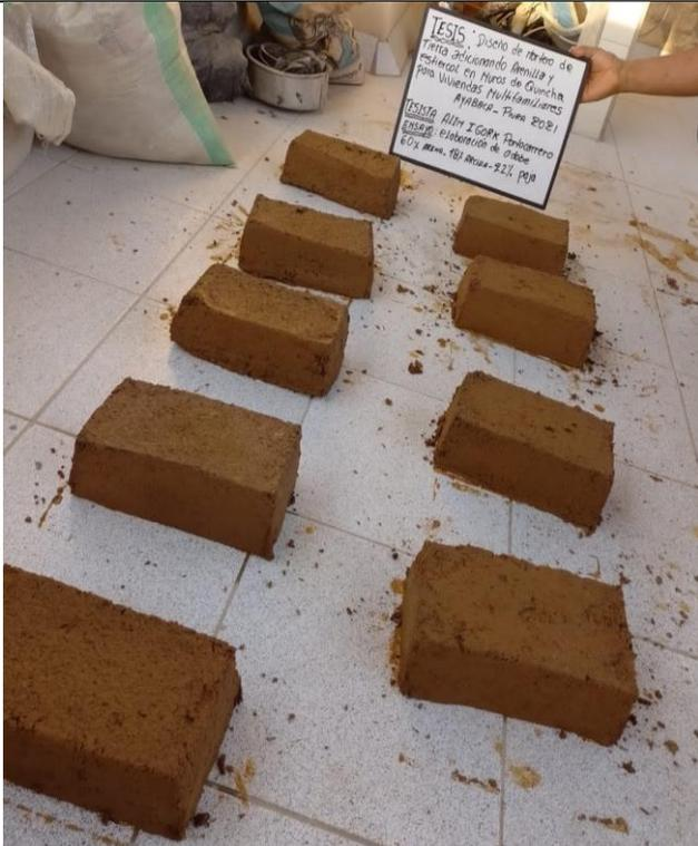
Fotografía N° 21. Vista de ensayo 60%Arena, 18%Arcilla, 22%Paja.
