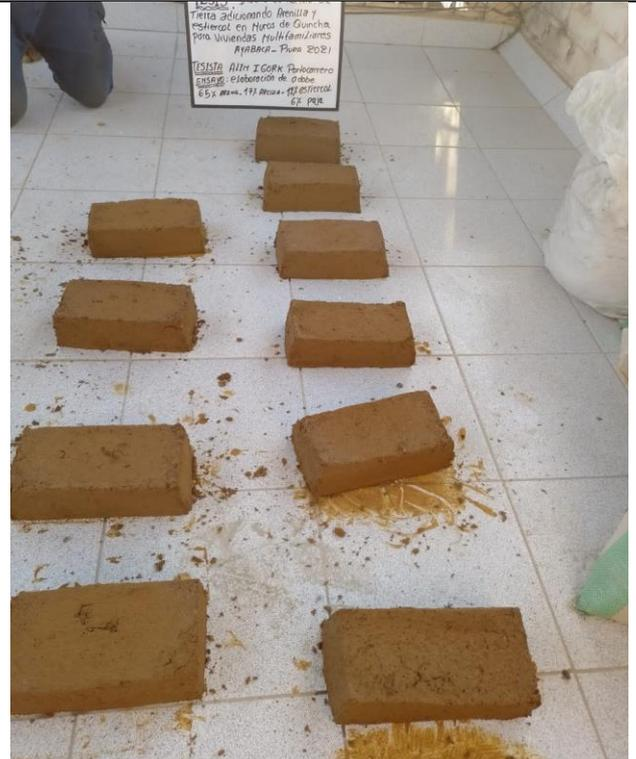
Fotografía N° 22. Vista de ensayo en 65% Arena, 17% Arcilla, 12% Estiércol, 6% Paja.
