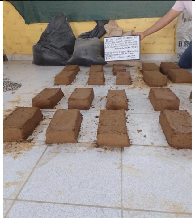
Fotografía N° 30. Vista de ensayo 52%Arena, 15% Arcilla, 30% Estiércol y 3% Paja.
