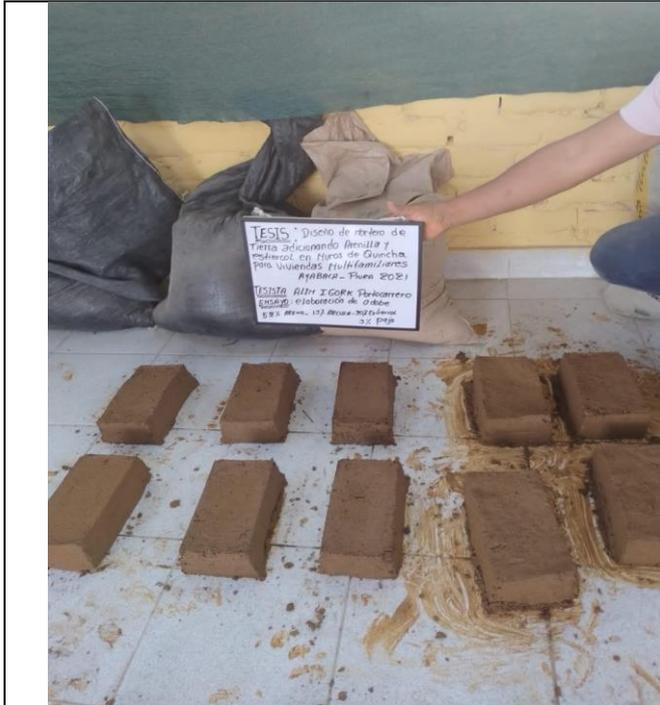
Fotografía N° 29. Vista de ensayo 52%Arena, 15% Arcilla, 30% Estiércol y 3% Paja.
