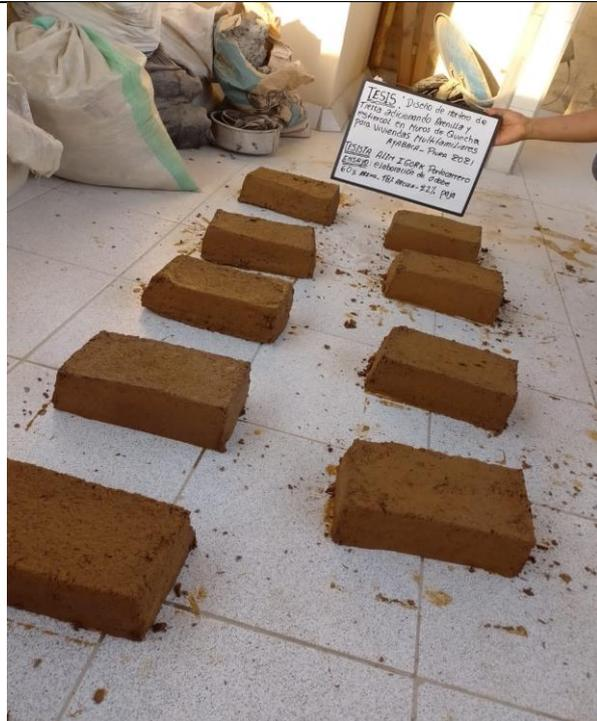
Fotografía N° 23. Vista de ensayo 60%Arena, 18%Arcilla, 22%Paja.
