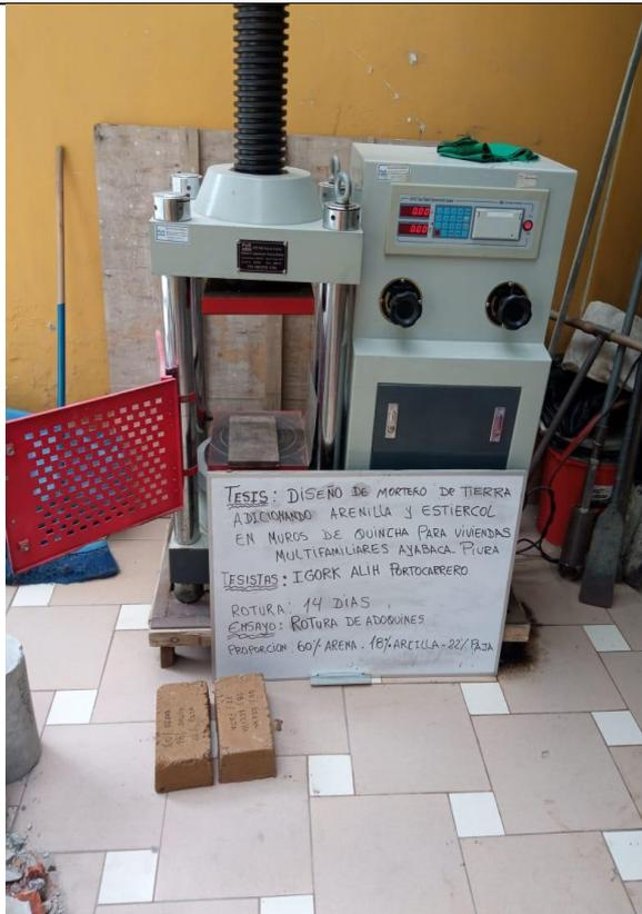
**Fotografía N° 33.** Vista de rotura de muestra Vista de ensayo **PATRON N°01:** 52% Arena, 15% Arcilla, 30% Estiércol y 3% Paja.
