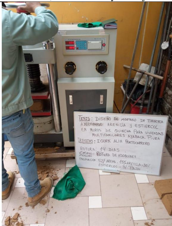
**Fotografía N° 35.** Vista de rotura de muestra Vista de ensayo **PATRON N°01:** 52% Arena, 15% Arcilla, 30% Estiércol y 3% Paja.
