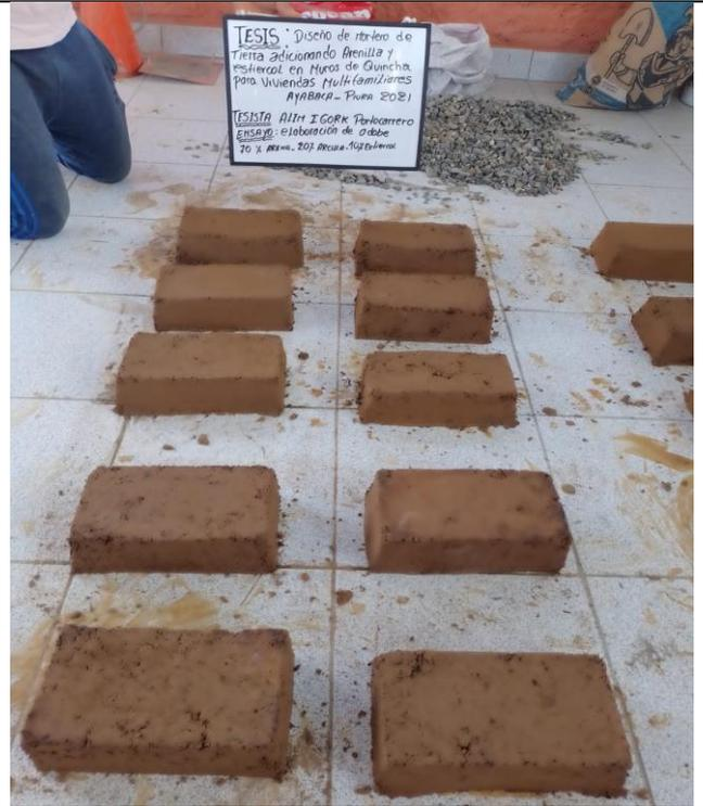
Fotografía N° 26. Vista de ensayo 70%Arena, 20% Arcilla, 10% Estiércol.
