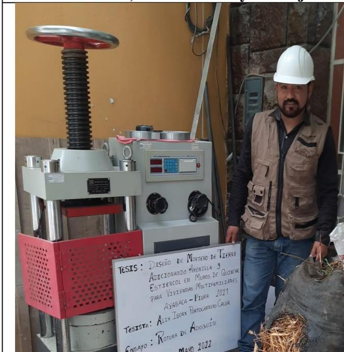
Fotografía N° 31. Vista de rotura de Patrón N° 01, N°02, N°03, N°04.
