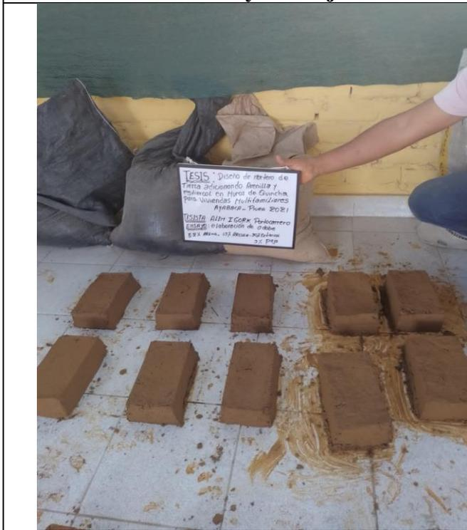
Fotografía N° 27. Vista de ensayos 52%Arena, 15% Arcilla, 30% Estiércol y 3% Paja.
