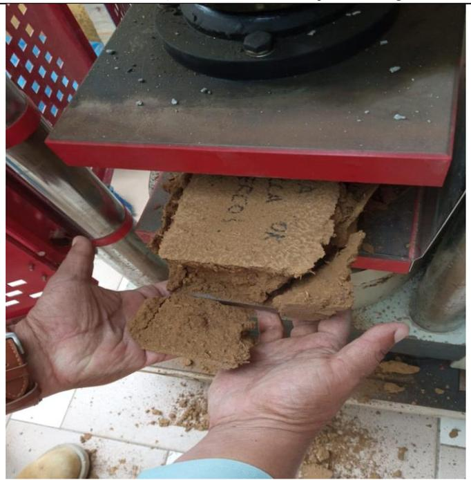
Fotografía N° 32. Vista de rotura de muestra
