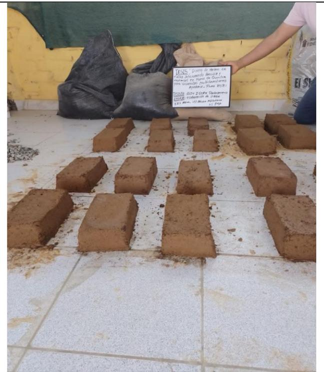
Fotografía N° 28. Vista de ensayos 52%Arena, 15% Arcilla, 30% Estiércol y 3% Paja.
