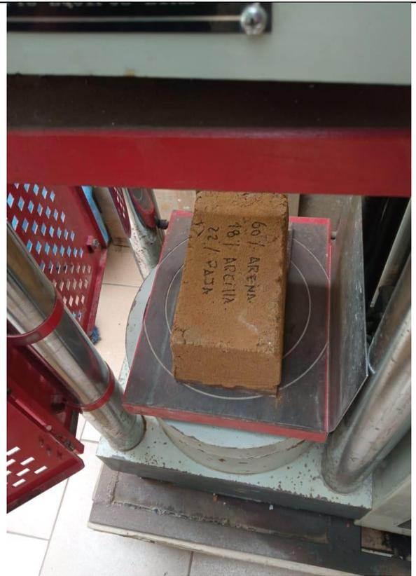
**Fotografía N° 34.** Vista de rotura de muestra Vista de ensayo **PATRON N°03:** 60% Arena, 18% Arcilla, 22% Paja.
