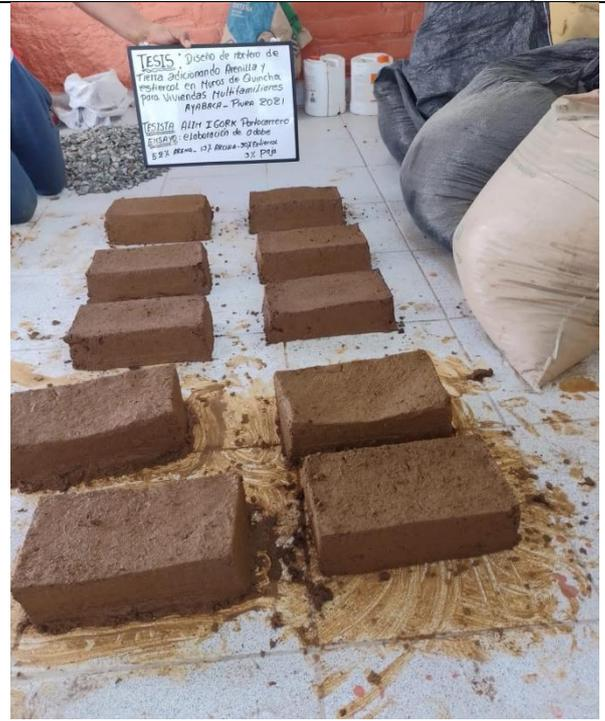
Fotografía N° 24. Vista de ensayo 52%Arena, 15% Arcilla, 30% Estiércol y 3% Paja.
