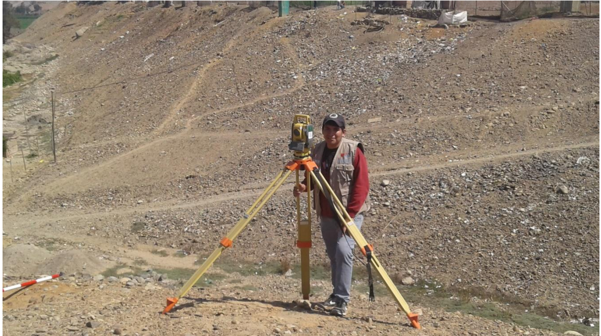
Ilustración 6. Realizando el levantamiento topográfico con Estación Total en el Asentamiento Humano el Pedregal.
