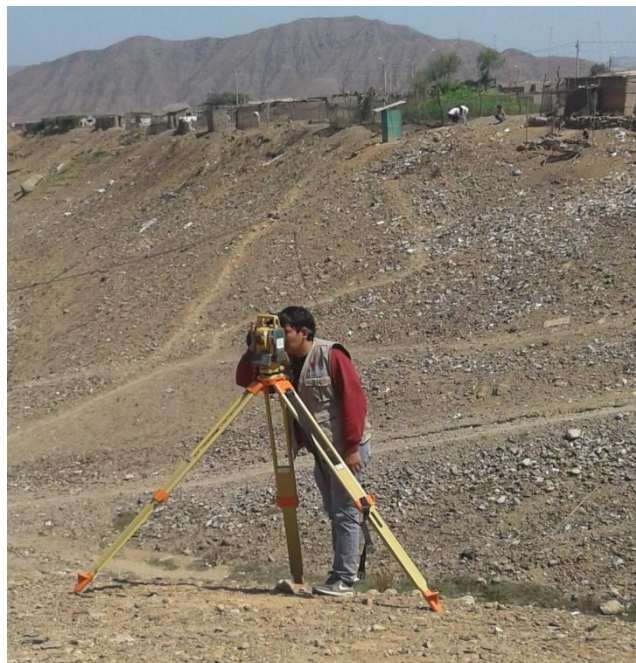
Ilustración 7. Realizando el levantamiento topográfico con Estación Total en el Asentamiento Humano el Pedregal.
