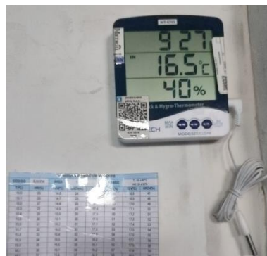
Figura 14: Equipo de medición de temperatura con sonda (Termohigrómetro).
