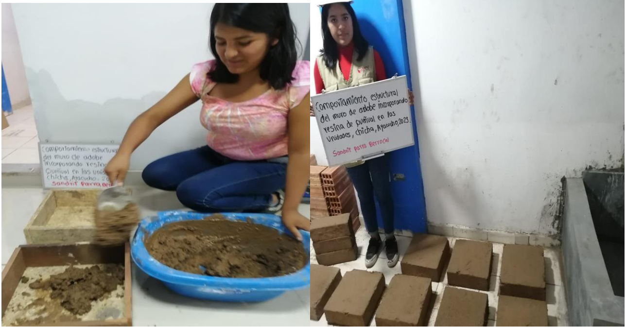
Fotografía N°4: Preparado de adobe
