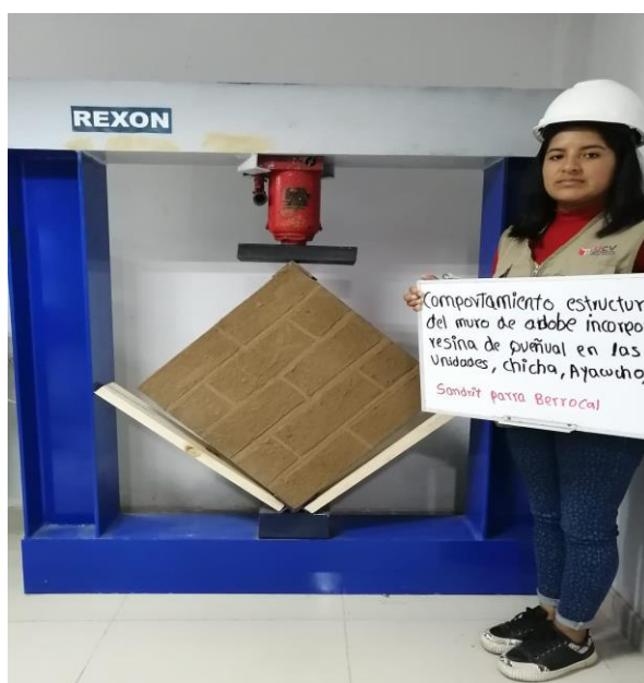
Fotografía N°7: Ensayo de compresión diagonal de murete 0%
