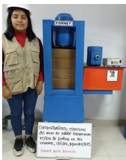
Fotografía N°7: Ensayo de resistencia de una pila 0%
