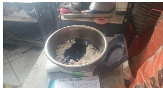
**Figura N°23:** Peso de la Mezcla
