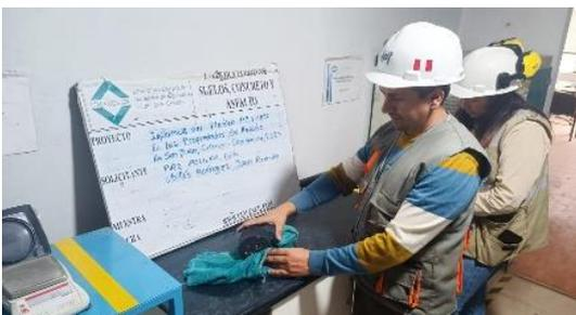
**Figura N°28:** Peso saturado
