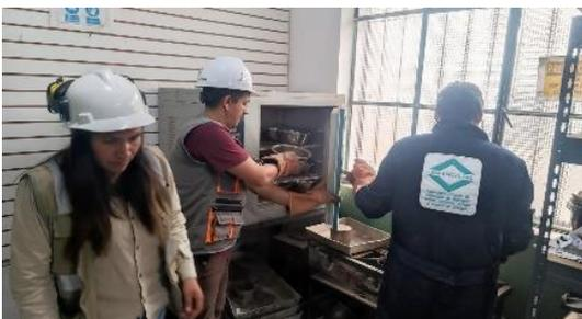
**Figura N°22:** Calentando agregados
