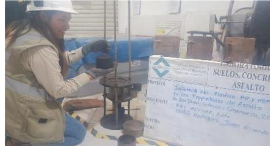
**Figura N°25:** Extracción de briquetta
