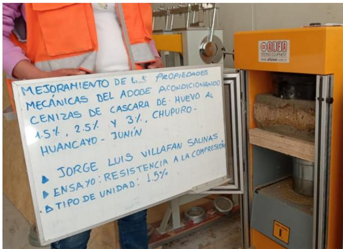
Ensayo de compresión de adobe con 1.5% ceniza de cascara de huevo
